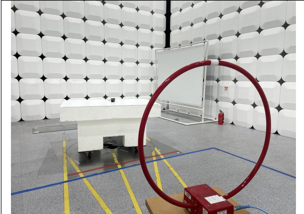
Test distance : 3 m, Height of table : 0.8 m
