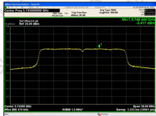
IEEE 802.11n_Channel 149_20MHz_Antenna 0
