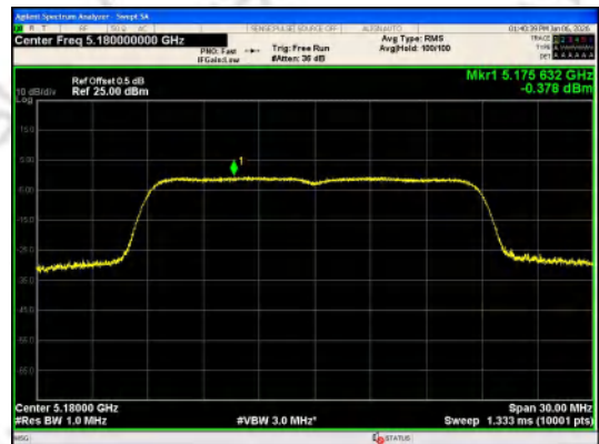
IEEE 802.11n_Channel 36_20MHz_Antenna 0
