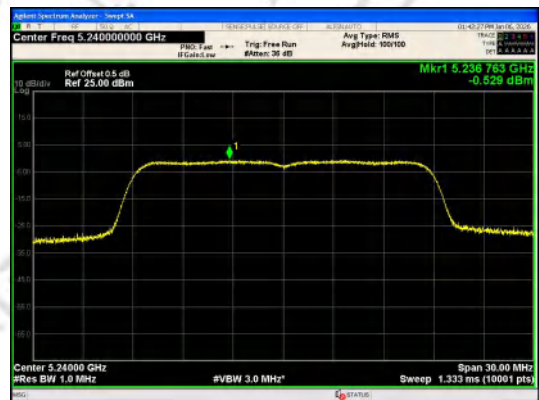
IEEE 802.11n_Channel 48_20MHz_Antenna 0
