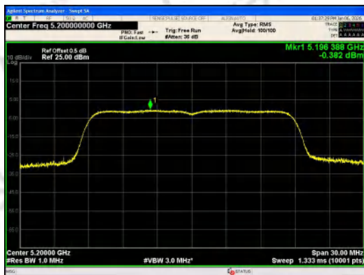
IEEE 802.11n_Channel 40_20MHz_Antenna 0
