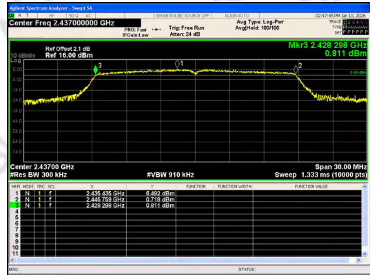
IEEE 802.11n_Channel 6_20MHz_Antenna 0
