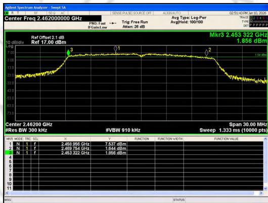
IEEE 802.11n_Channel 11_20MHz_Antenna 0
