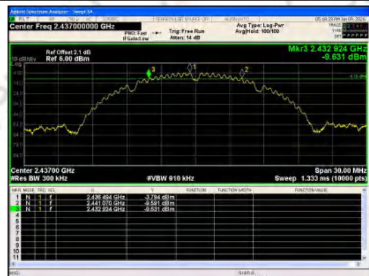
IEEE 802.11b_Channel 6_20MHz_Antenna 0
