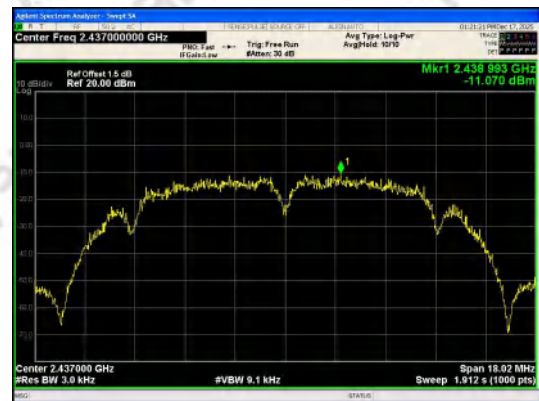
IEEE 802.11b_Channel 6_20MHz_Antenna 0
