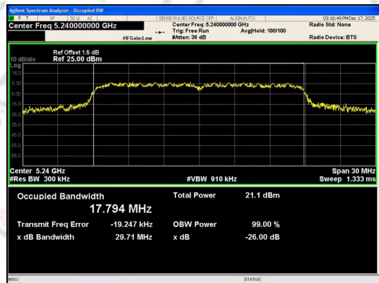
IEEE 802.11n_Channel 48_20MHz_Antenna 0
