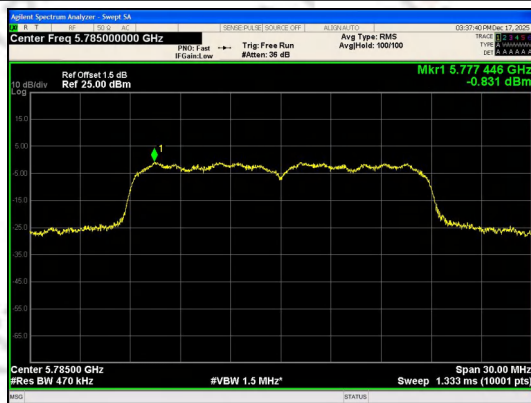
IEEE 802.11n_Channel 157_20MHz_Antenna 0
