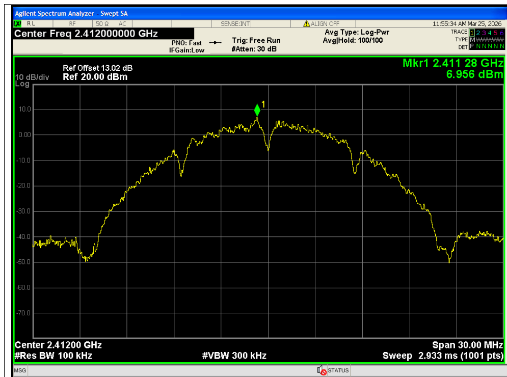
Band Edge NVNT b 2412MHz Ant2 Ref SISO
