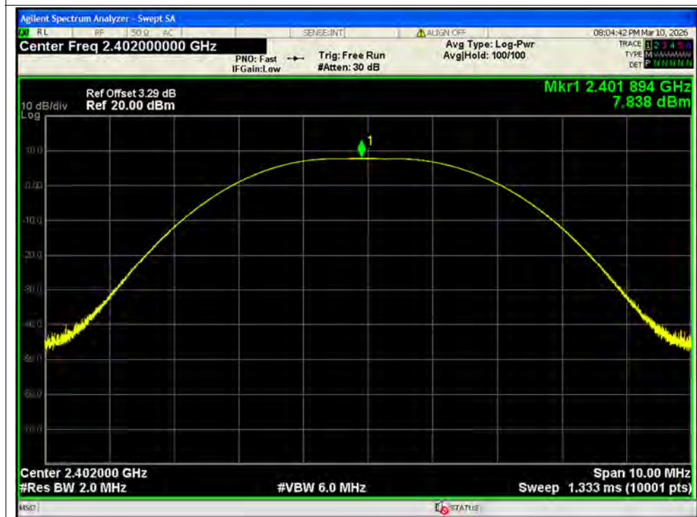
Peak Power NVNT BLE 2M 2402MHz Ant2
