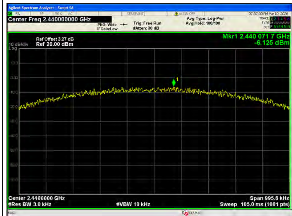
PSD NVNT BLE 1M 2440MHz Ant1
