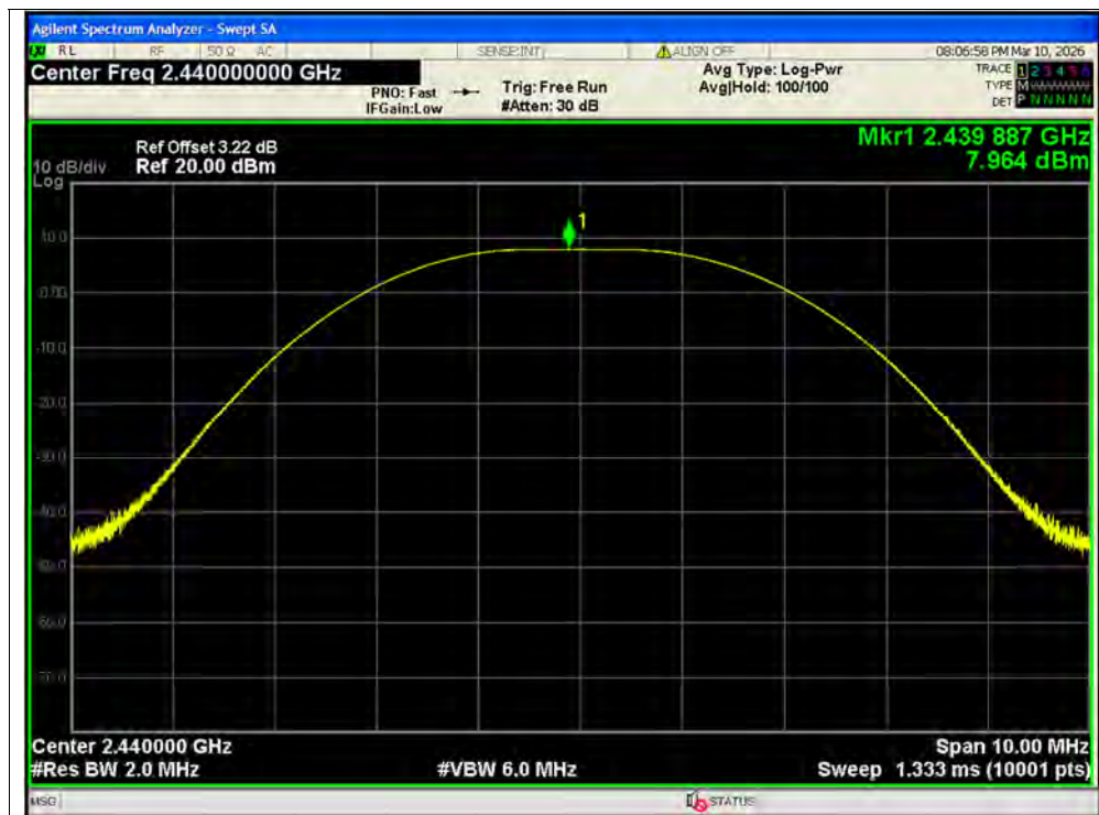
Peak Power NVNT BLE 2M 2440MHz Ant2
