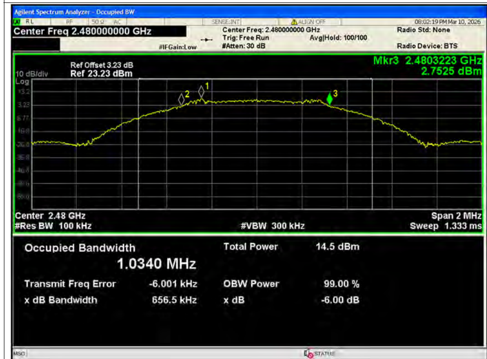
-6dB Bandwidth NVNT BLE 1M 2480MHz Ant2
