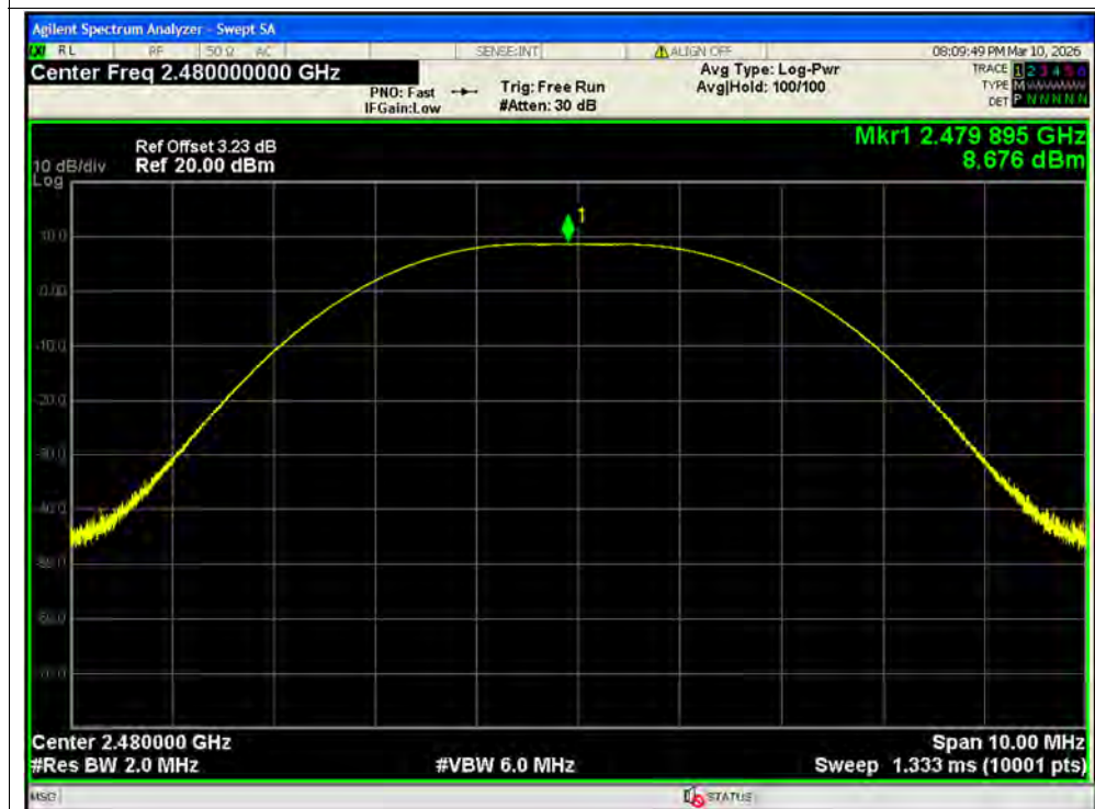
Peak Power NVNT BLE 2M 2480MHz Ant2
