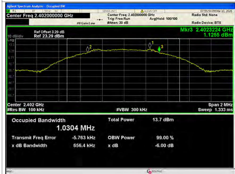
-6dB Bandwidth NVNT BLE 1M 2402MHz Ant2
