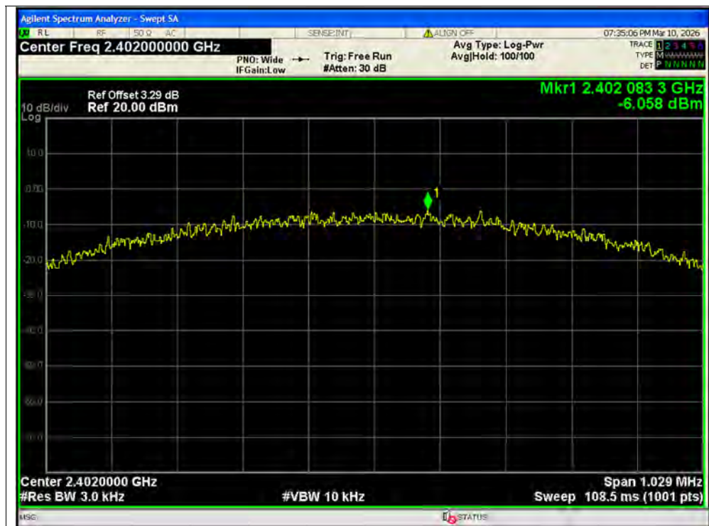
PSD NVNT BLE 1M 2402MHz Ant1
