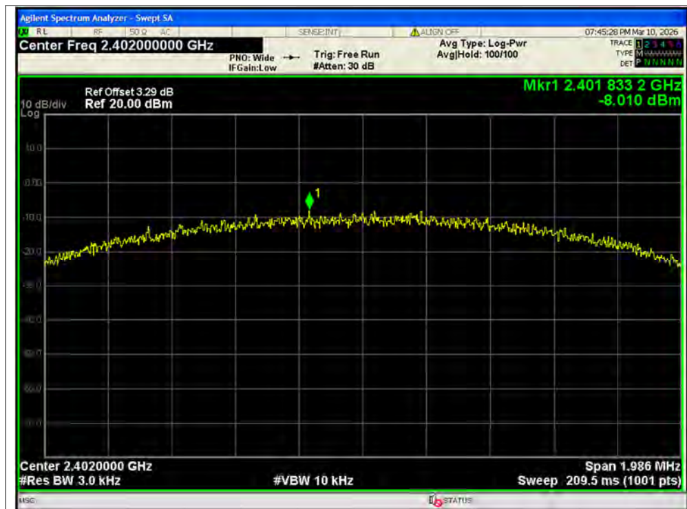
PSD NVNT BLE 2M 2402MHz Ant1
