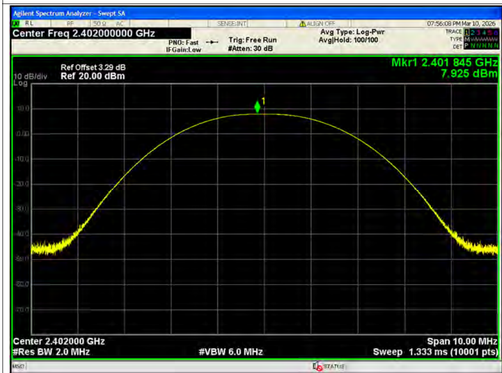
Peak Power NVNT BLE 1M 2402MHz Ant2
