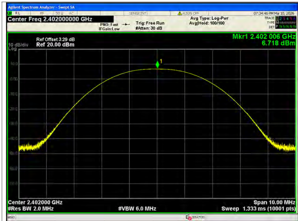
Peak Power NVNT BLE 1M 2402MHz Ant1
