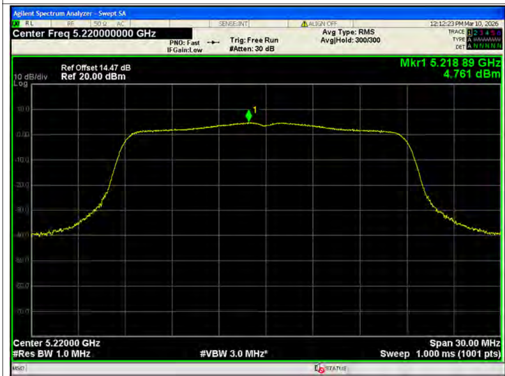
PSD NVNT n20 5220MHz Ant1 SISO
