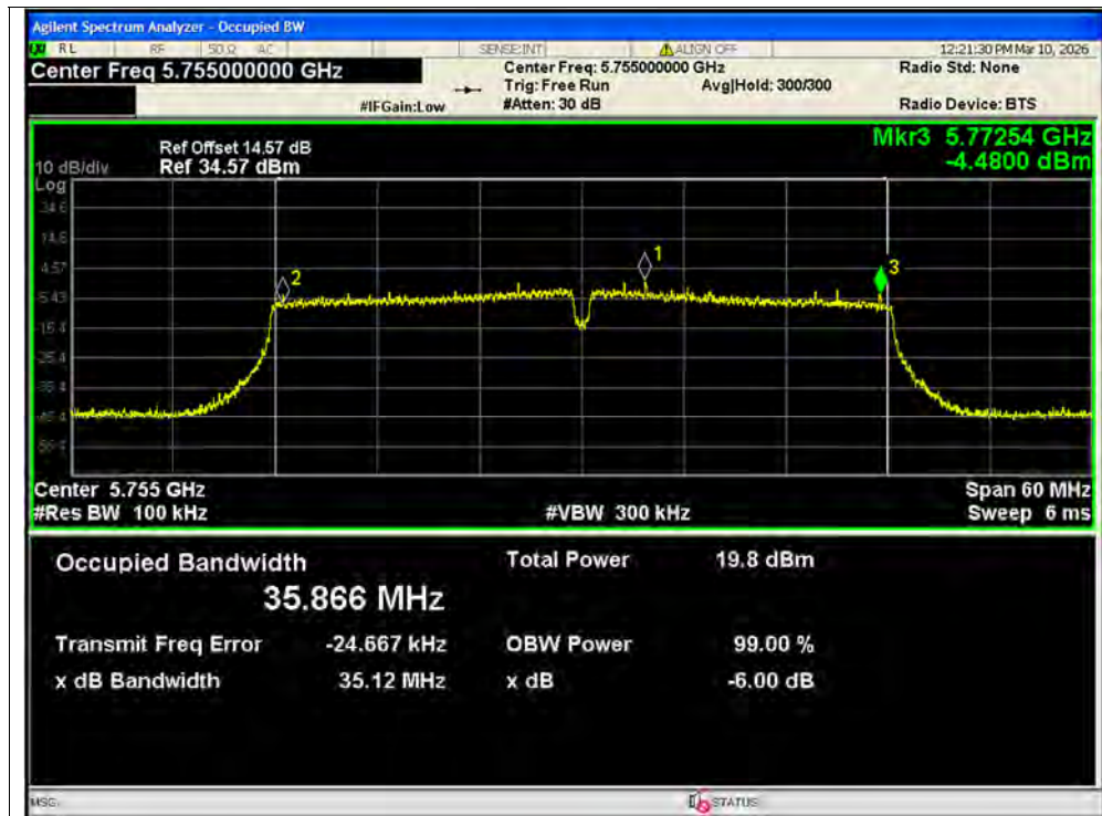
-6dB Bandwidth NVNT n40 5755MHz Ant1 SISO
