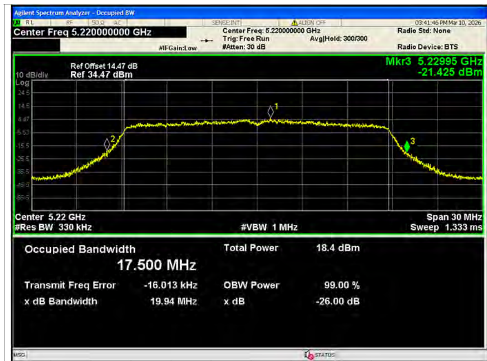
-26dB Bandwidth NVNT ac20 5220MHz Ant1 MIMO
