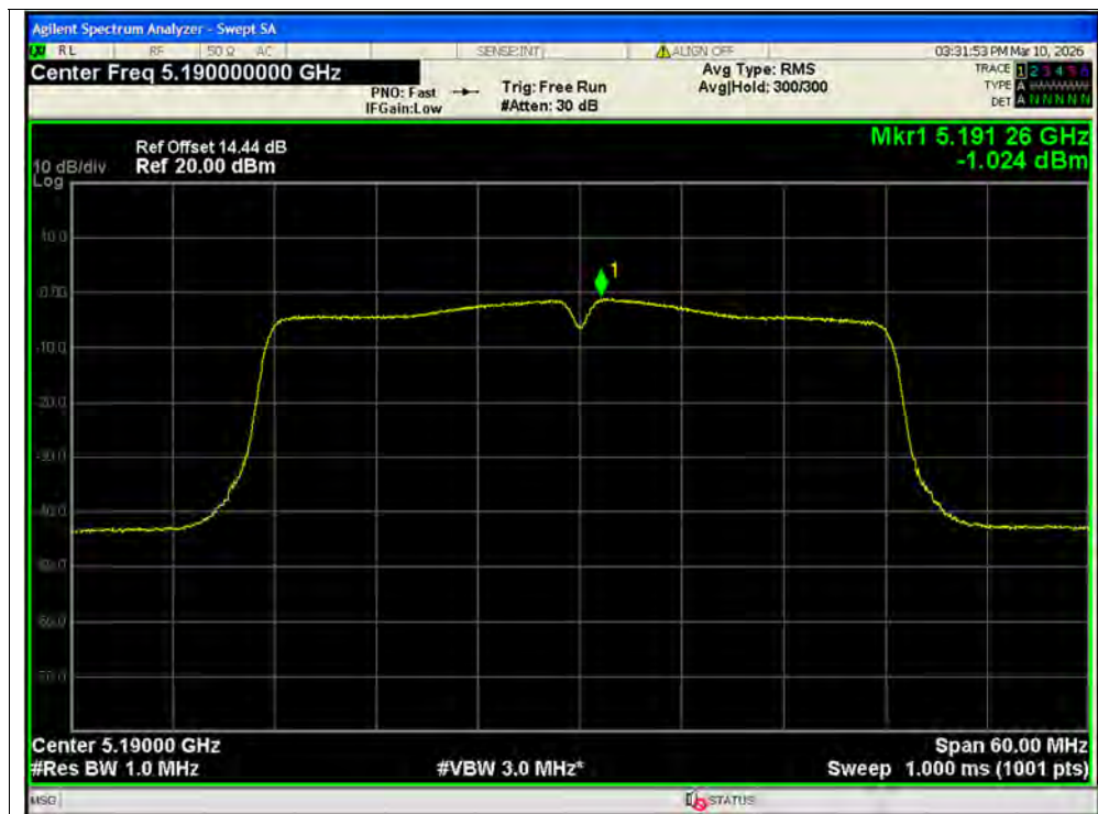
PSD NVNT n40 5190MHz Ant1 MIMO
