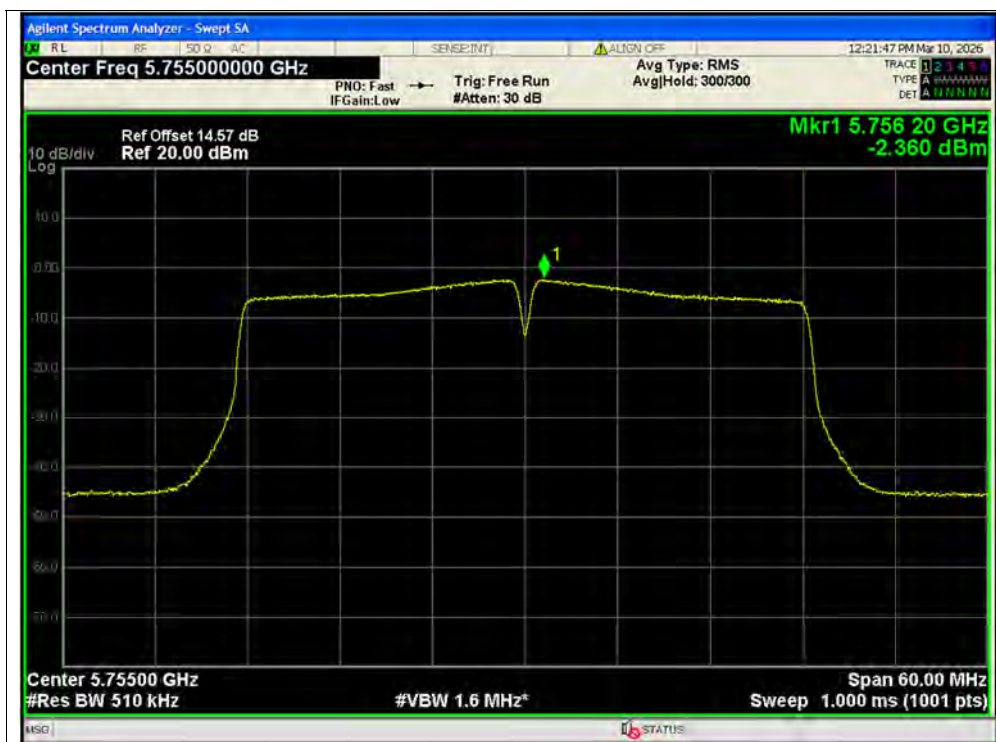
PSD NVNT n40 5755MHz Ant1 SISO
