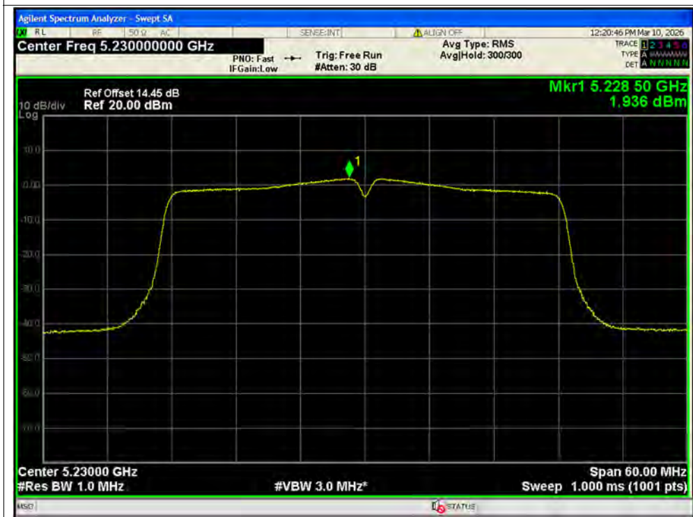
PSD NVNT n40 5230MHz Ant1 SISO
