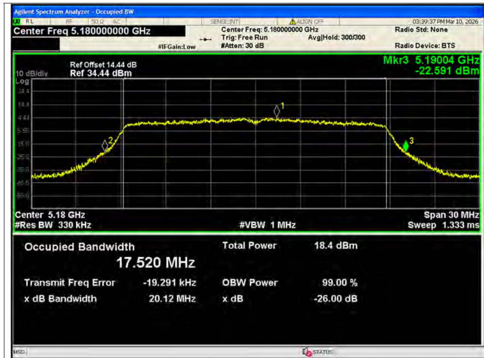
-26dB Bandwidth NVNT ac20 5180MHz Ant1 MIMO
