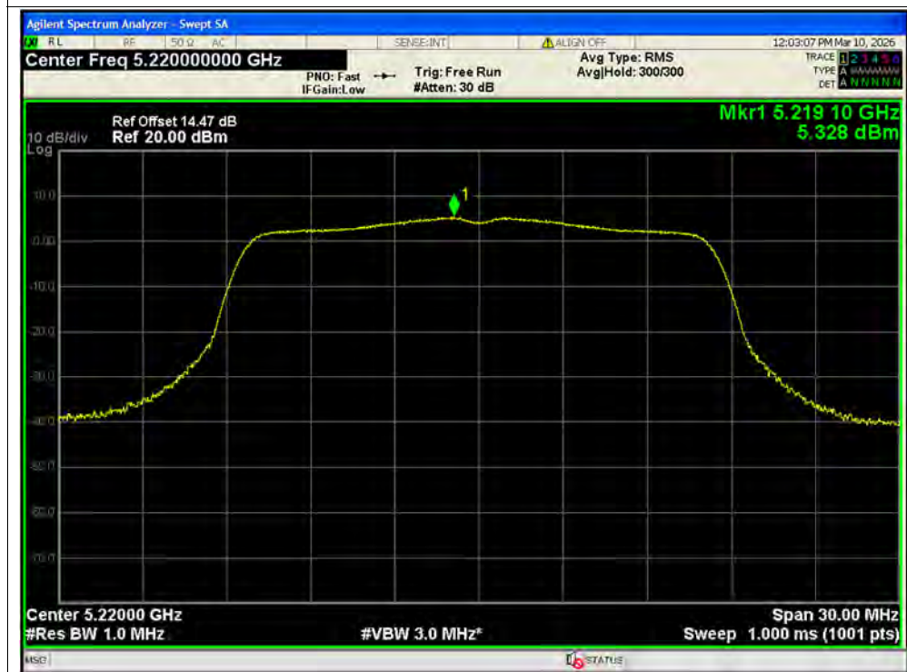
PSD NVNT a 5220MHz Ant1 SISO
