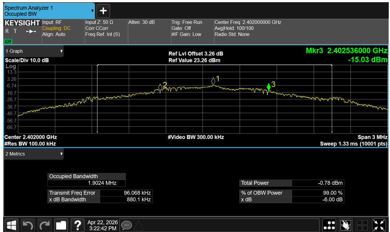
-6dB Bandwidth NVNT BLE 2442MHz Ant1
