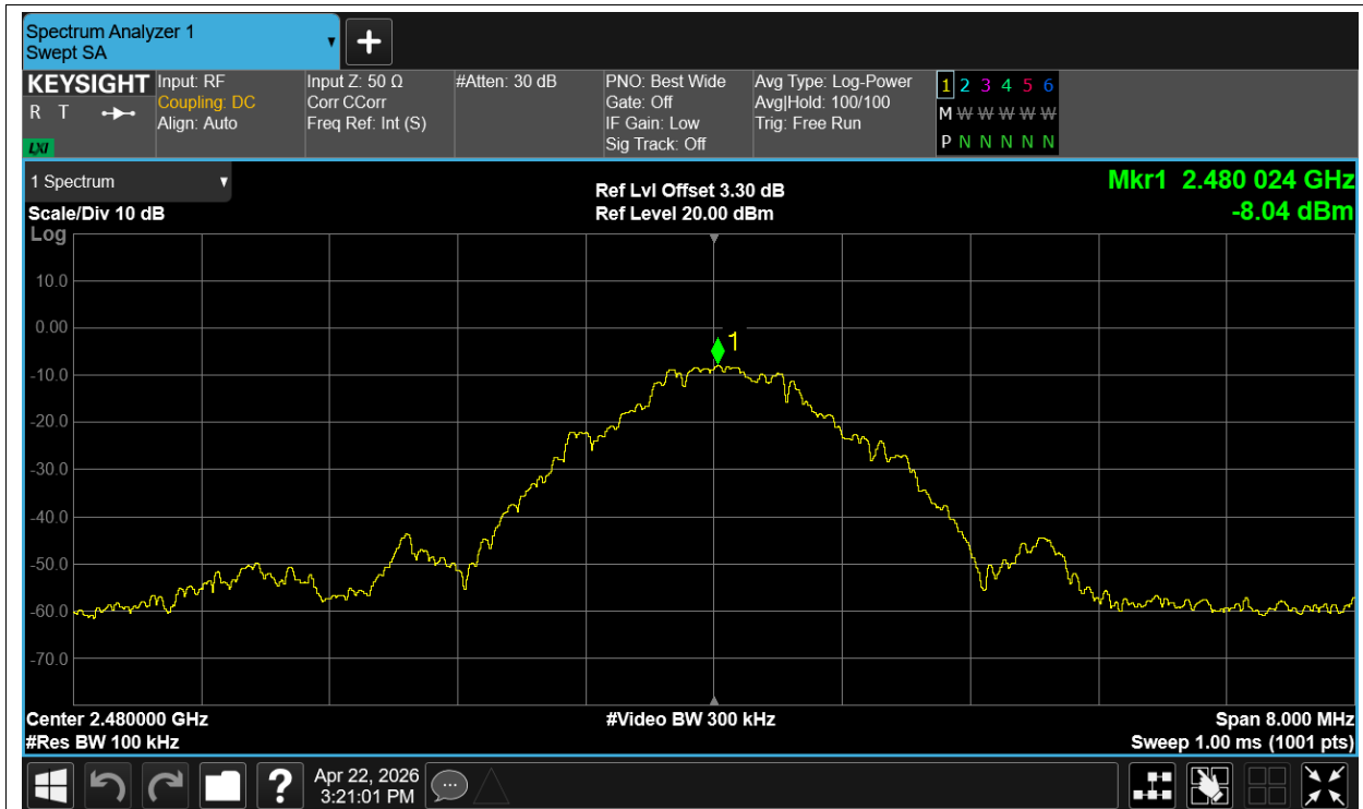
Band Edge NVNT BLE 2480MHz Ant1 Emission
