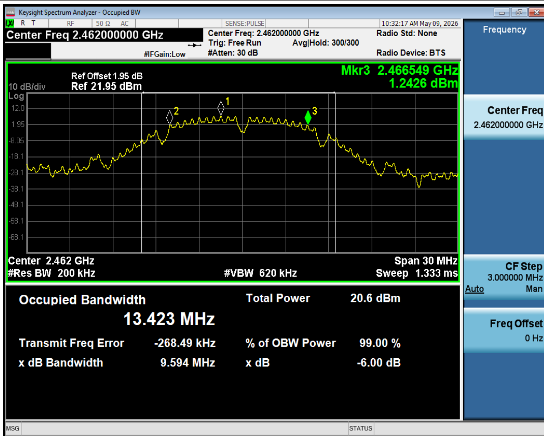
-6dB Bandwidth NVNT b 2462MHz Ant1
