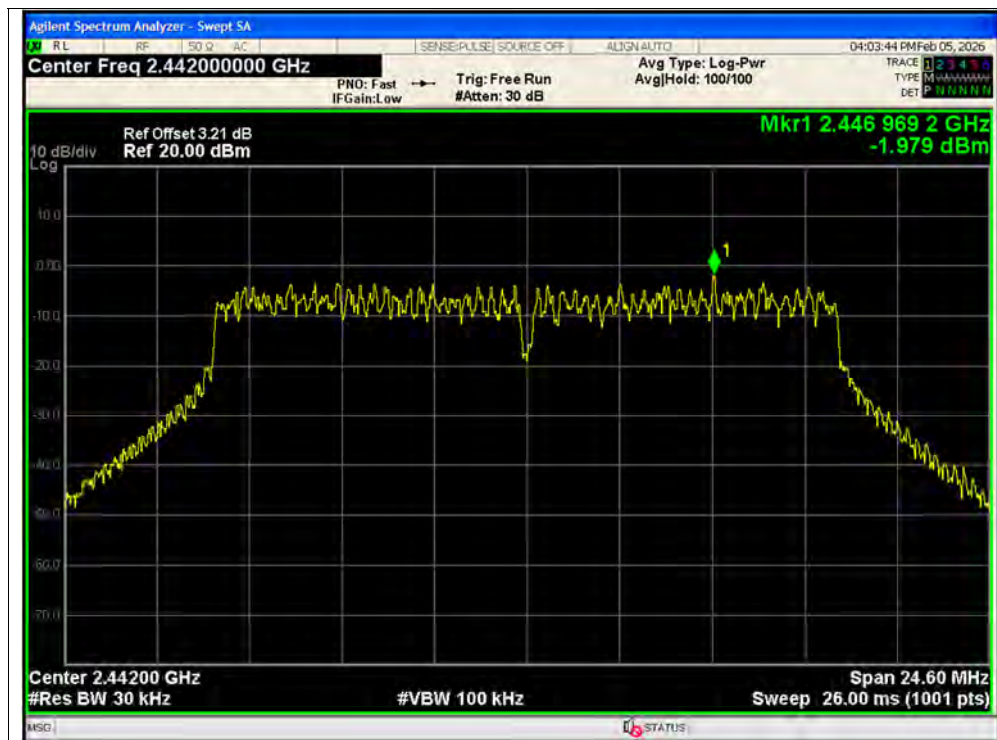
PSD NVNT g 2442MHz Ant1
