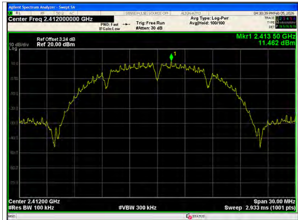
Band Edge NVNT b 2412MHz Ant1 Ref
