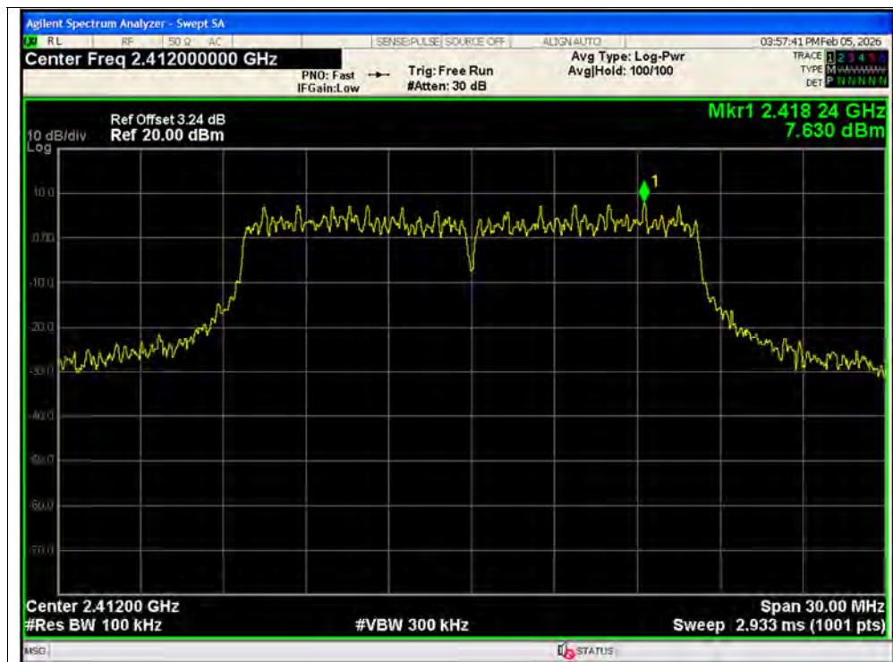
Band Edge NVNT g 2412MHz Ant1 Ref
