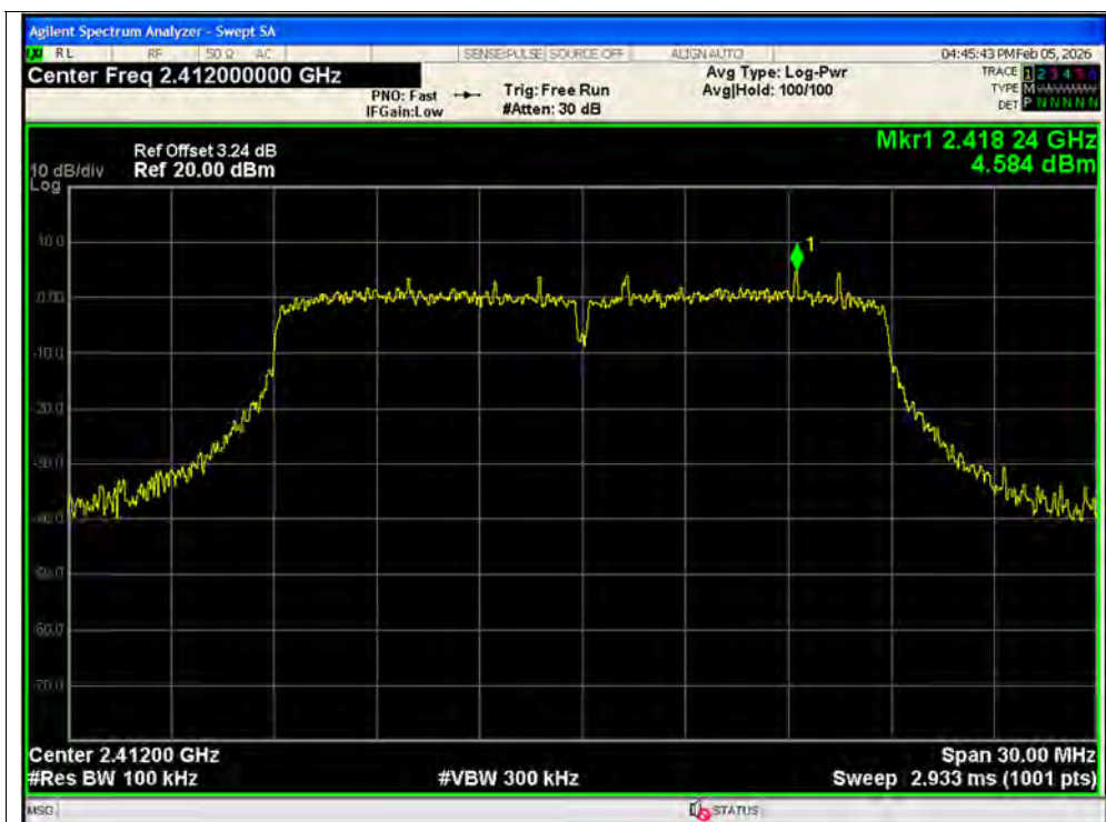
Band Edge NVNT n20 2412MHz Ant1 Ref
