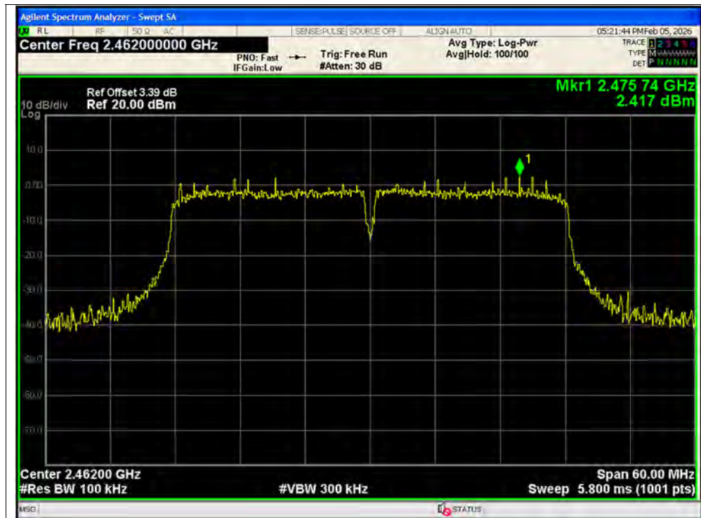
Band Edge NVNT n40 2462MHz Ant1 Ref
