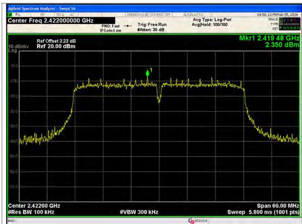
Band Edge NVNT n40 2422MHz Ant1 Ref
