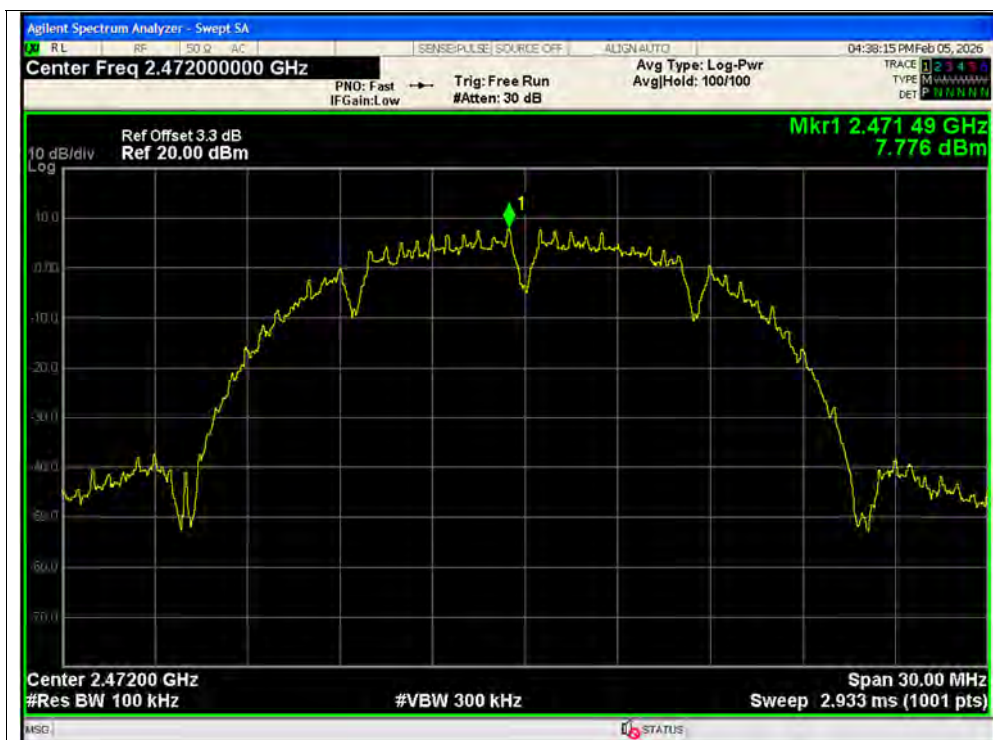
Band Edge NVNT b 2472MHz Ant1 Ref
