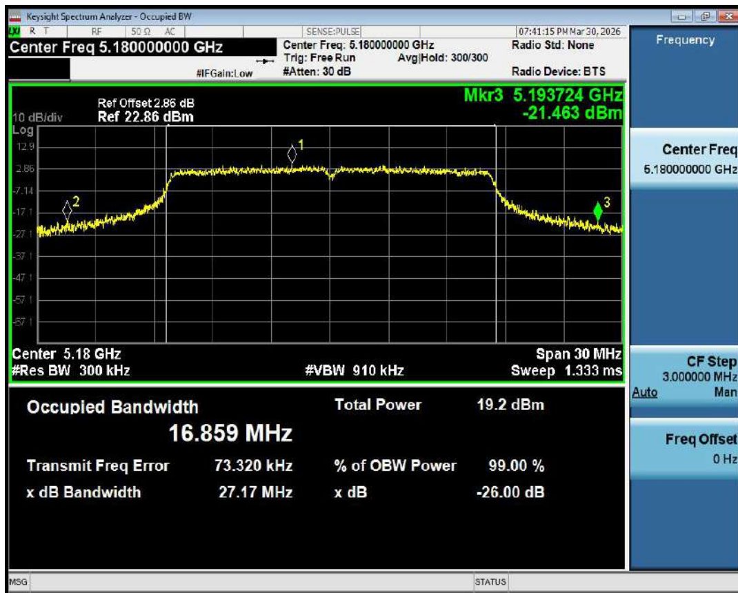
-26dB Bandwidth NVNT a 5180MHz Ant1
