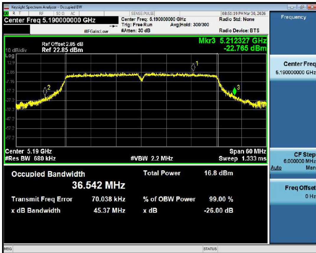
-26dB Bandwidth NVNT n40 5190MHz Ant1
