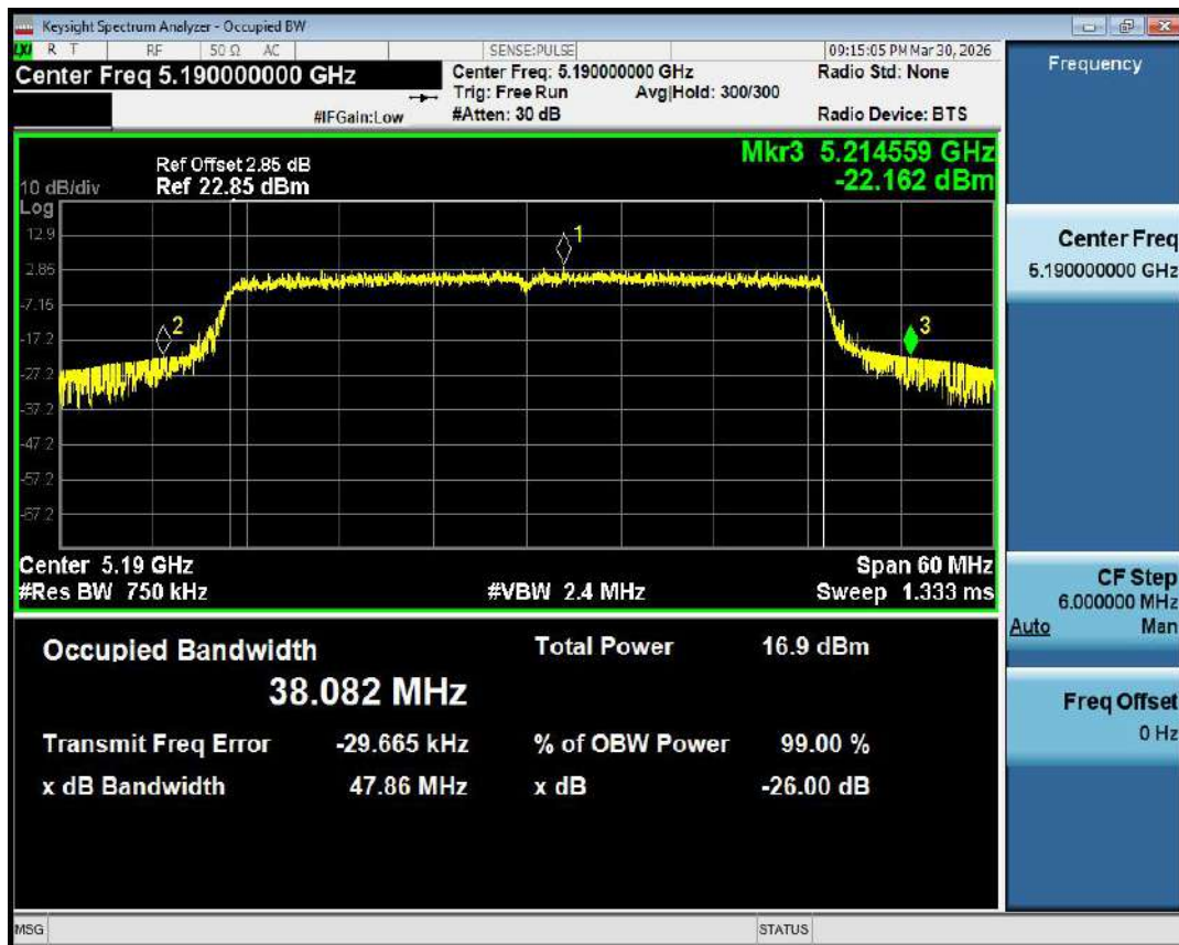
-26dB Bandwidth NVNT ax40 5190MHz Ant1
