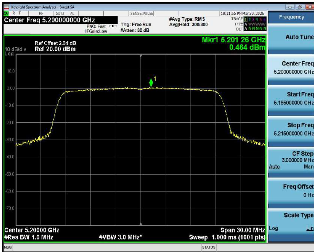
PSD NVNT ax20 5200MHz Ant1
