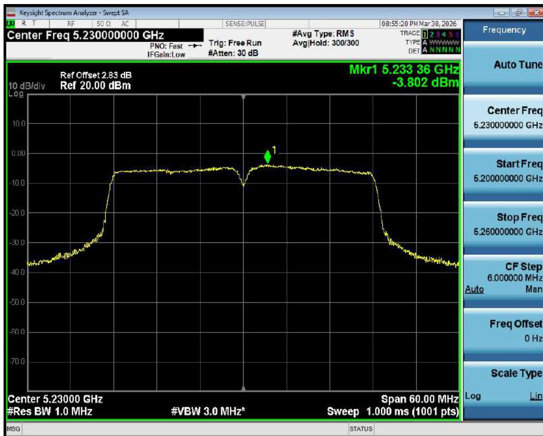
PSD NVNT n40 5230MHz Ant1
