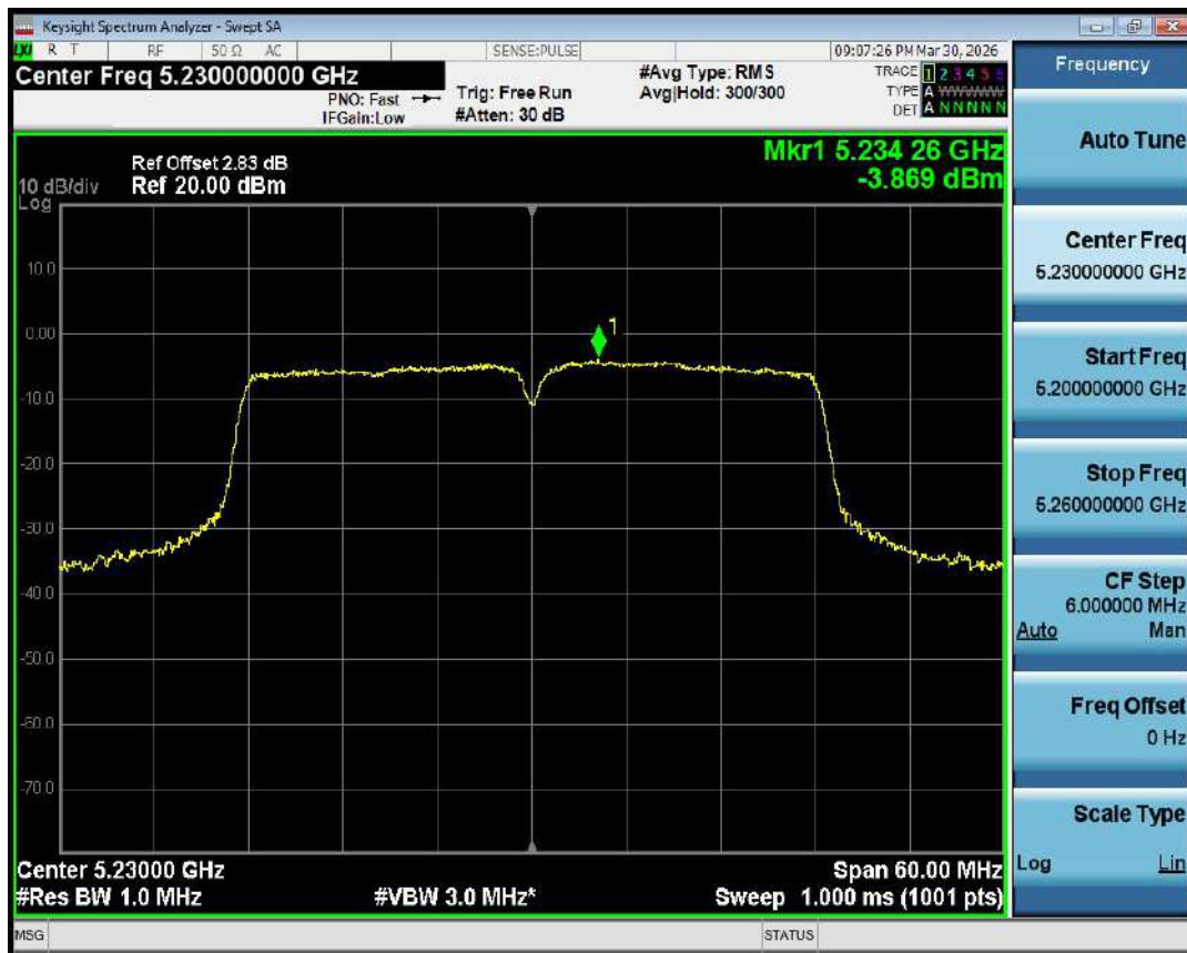
PSD NVNT ac40 5230MHz Ant1
