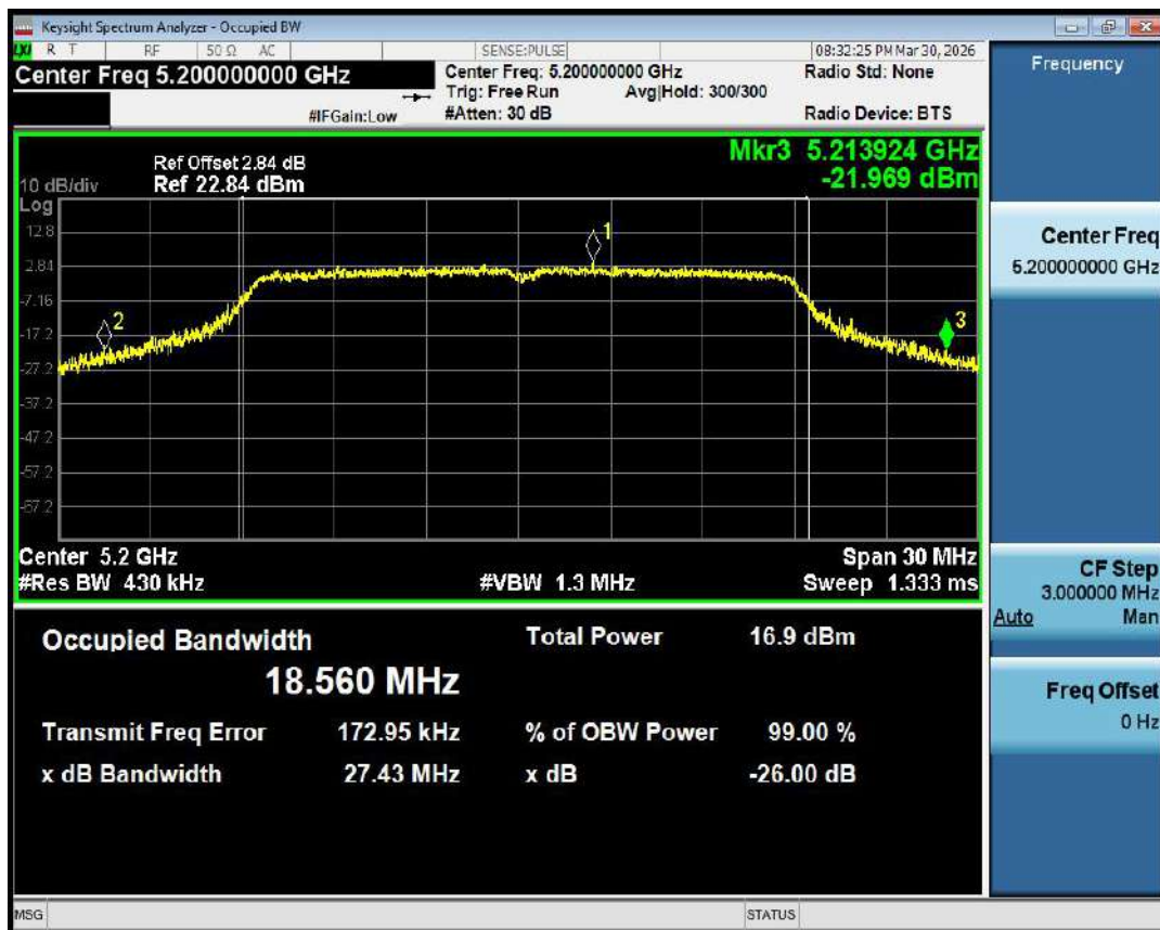
-26dB Bandwidth NVNT ac20 5200MHz Ant1
