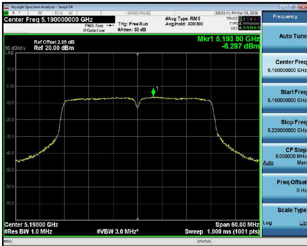
PSD NVNT n40 5190MHz Ant1
