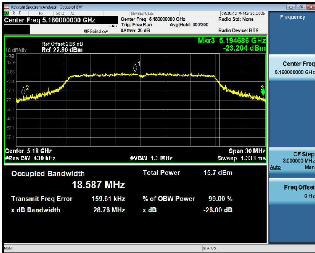
-26dB Bandwidth NVNT ac20 5180MHz Ant1
