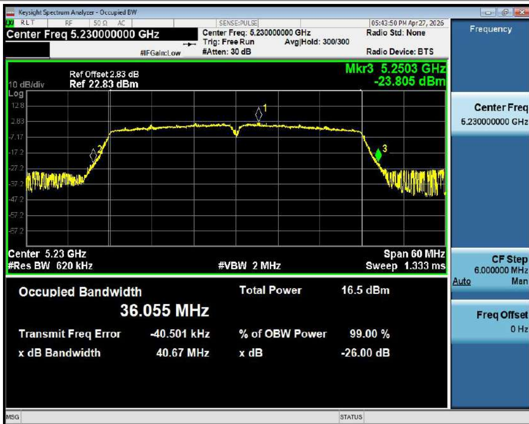
-26dB Bandwidth NVNT n40 5230MHz Ant1
