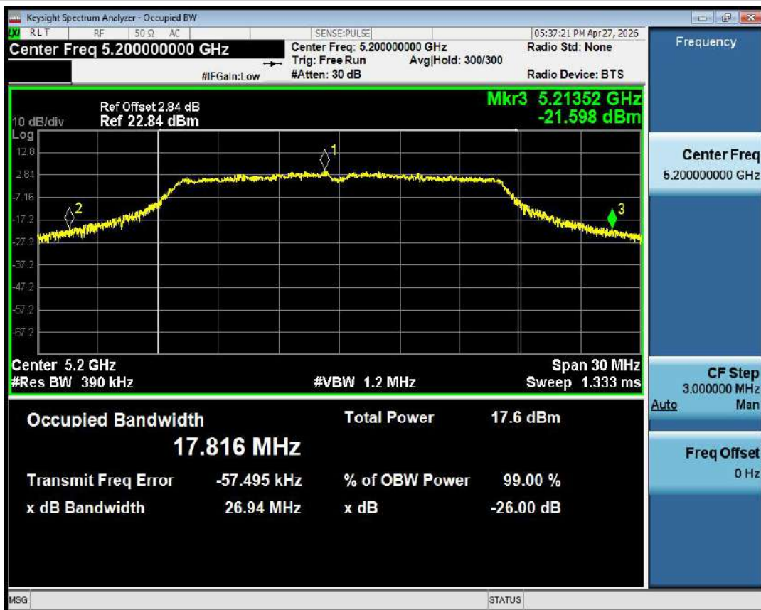
-26dB Bandwidth NVNT a 5200MHz Ant1
