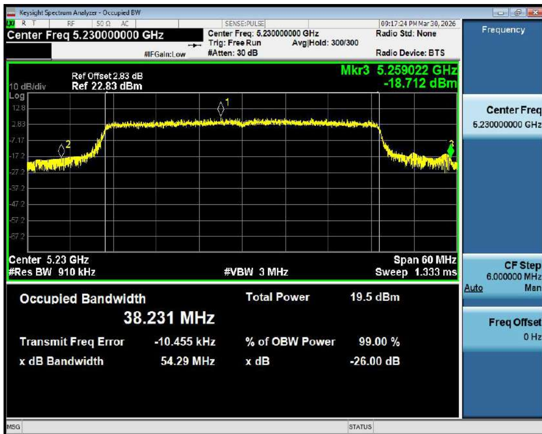
-26dB Bandwidth NVNT ax40 5230MHz Ant1
