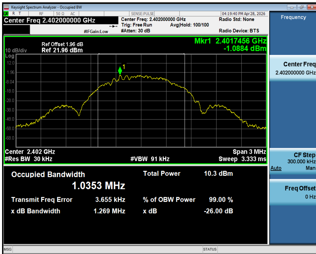
OBW NVNT BLE 1M 2402MHz Ant1
