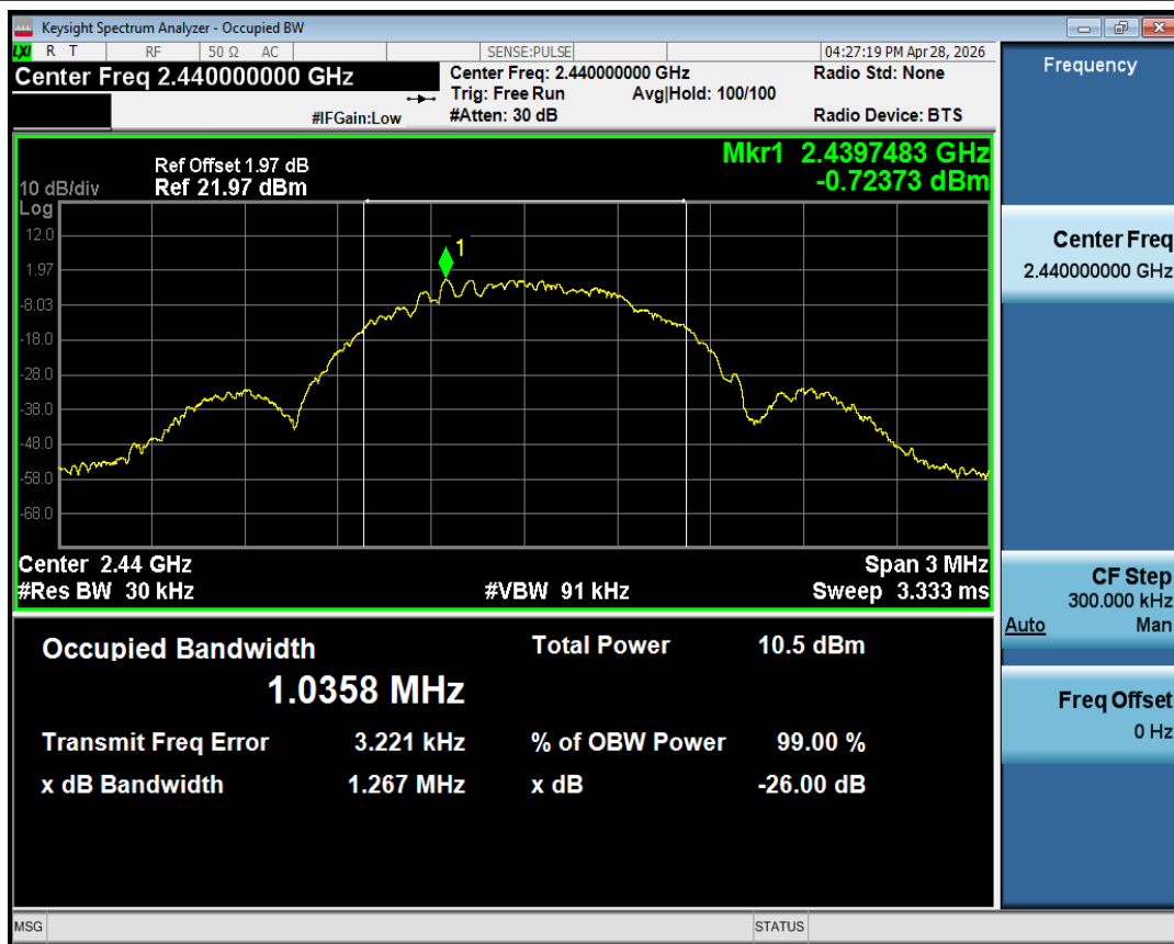
OBW NVNT BLE 1M 2440MHz Ant1
