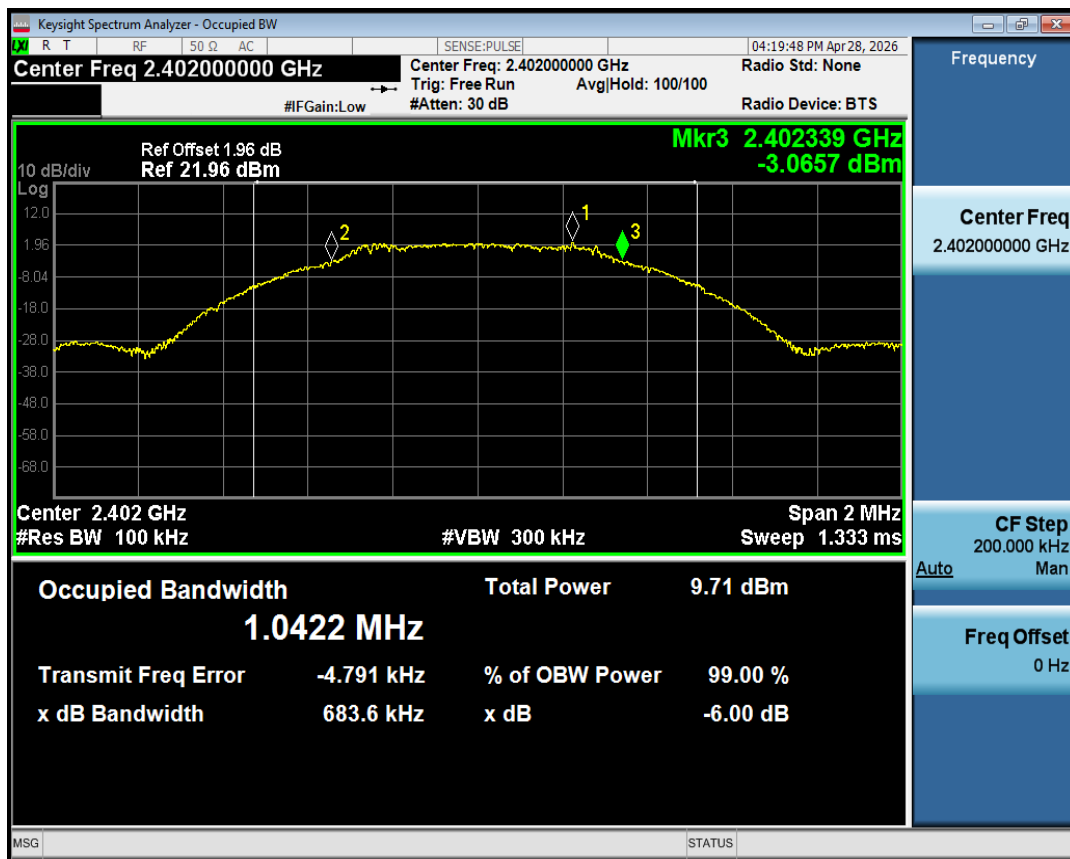
-6dB Bandwidth NVNT BLE 1M 2402MHz Ant1
