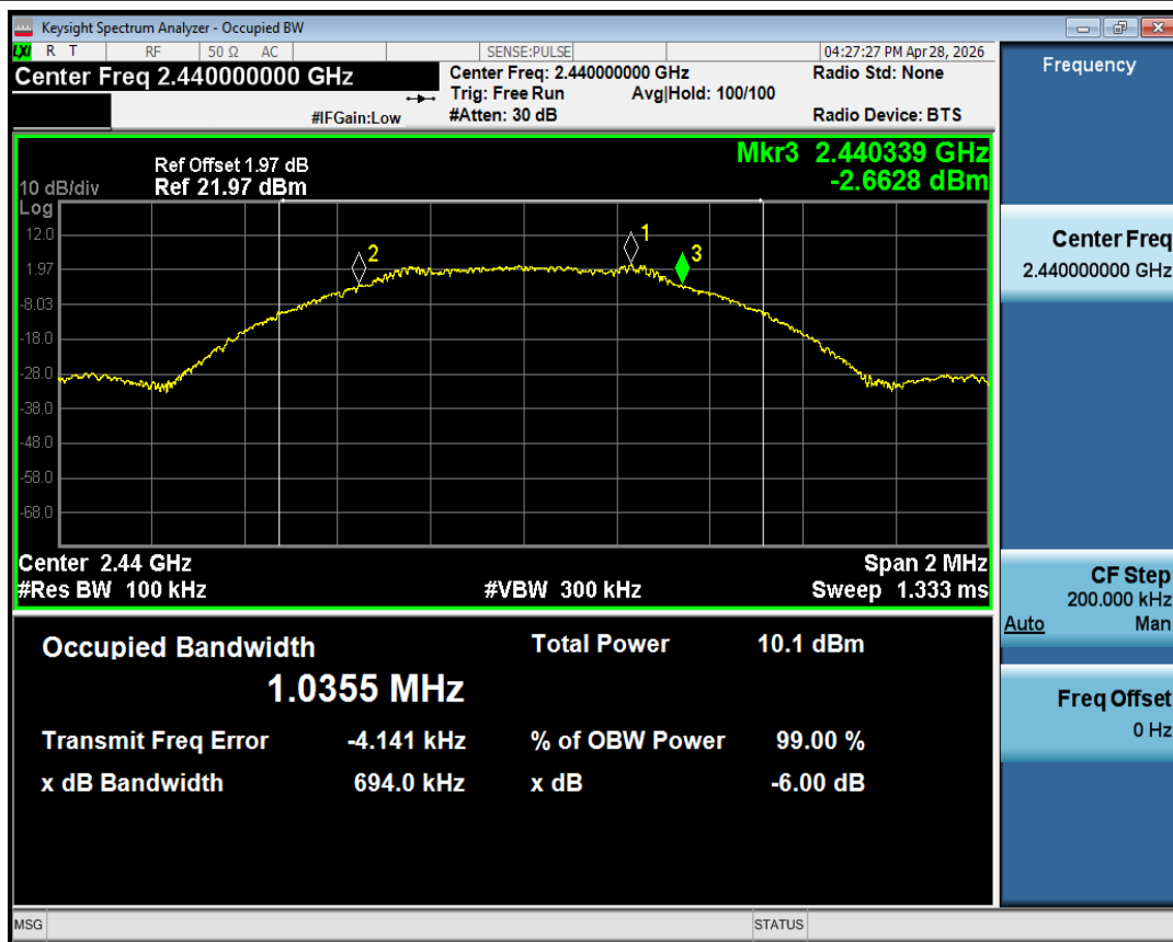
-6dB Bandwidth NVNT BLE 1M 2440MHz Ant1
