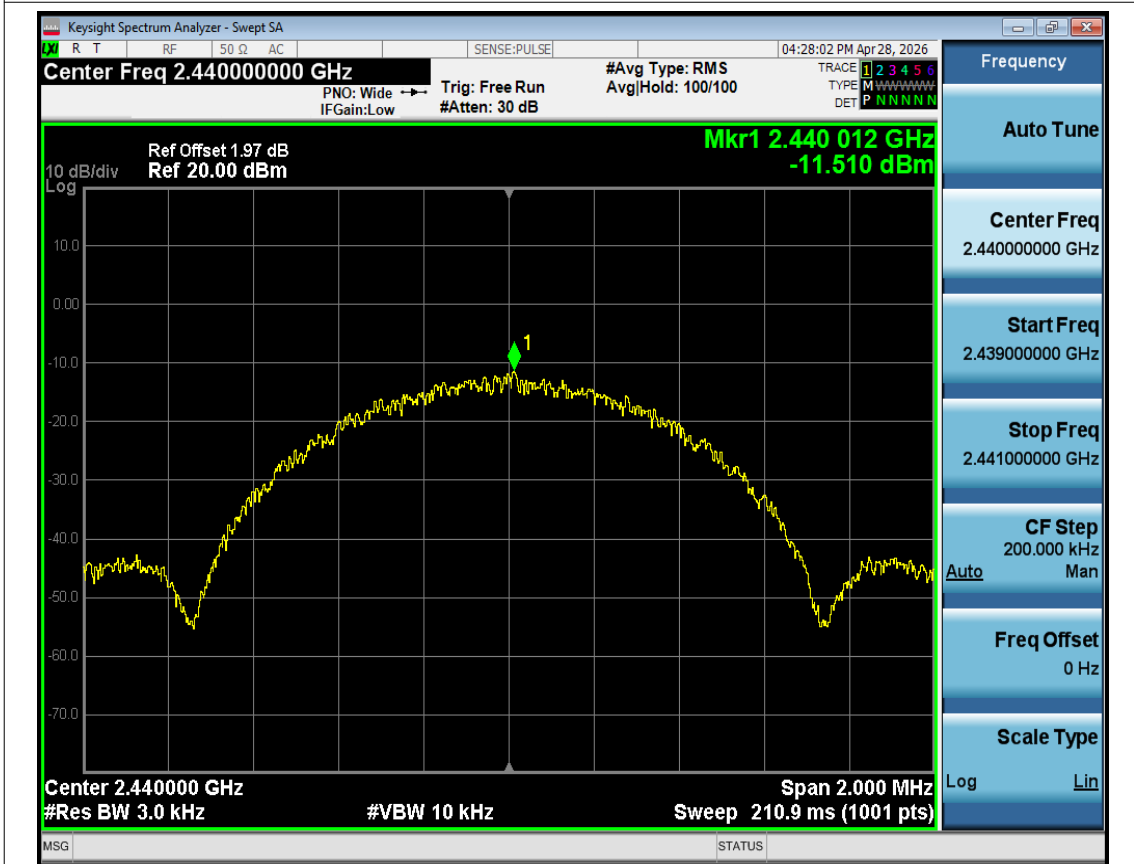
PSD NVNT BLE 1M 2440MHz Ant1
