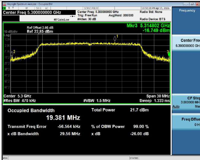
-26dB Bandwidth NVNT ax20 5300MHz Ant1
