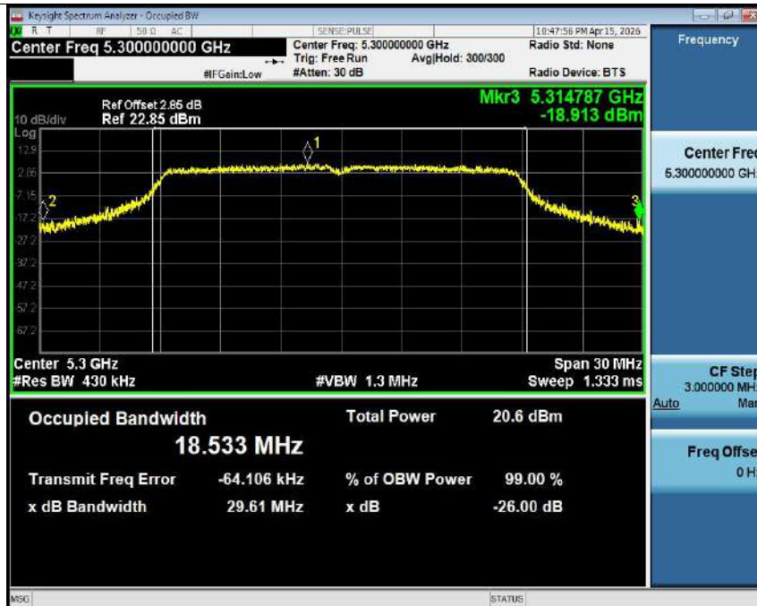
-26dB Bandwidth NVNT ac20 5300MHz Ant1
