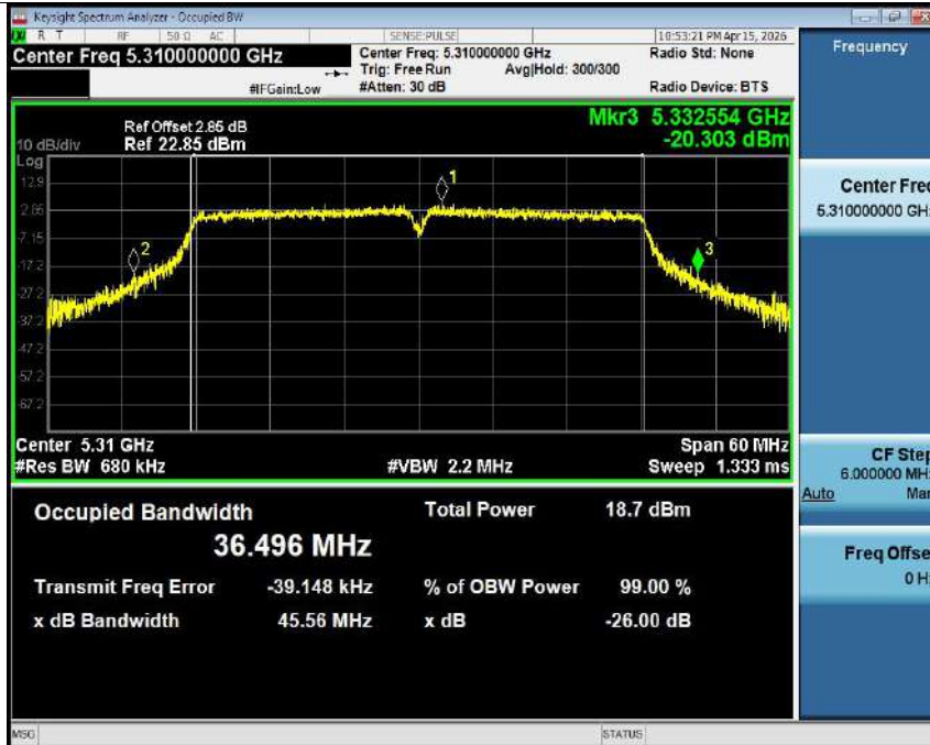
-26dB Bandwidth NVNT n40 5310MHz Ant1
