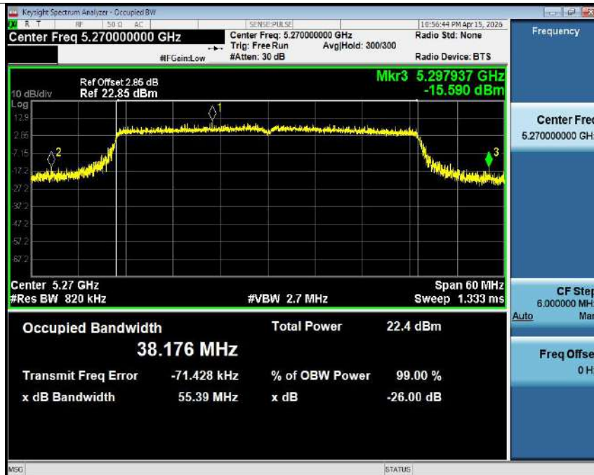
-26dB Bandwidth NVNT ax40 5270MHz Ant1
