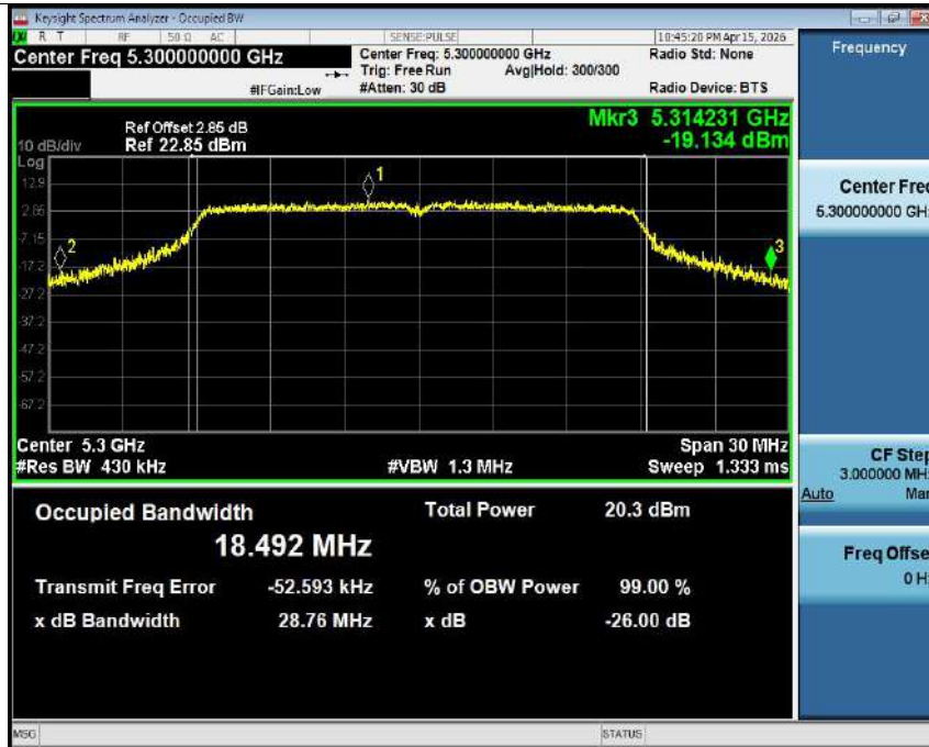
-26dB Bandwidth NVNT n20 5300MHz Ant1
