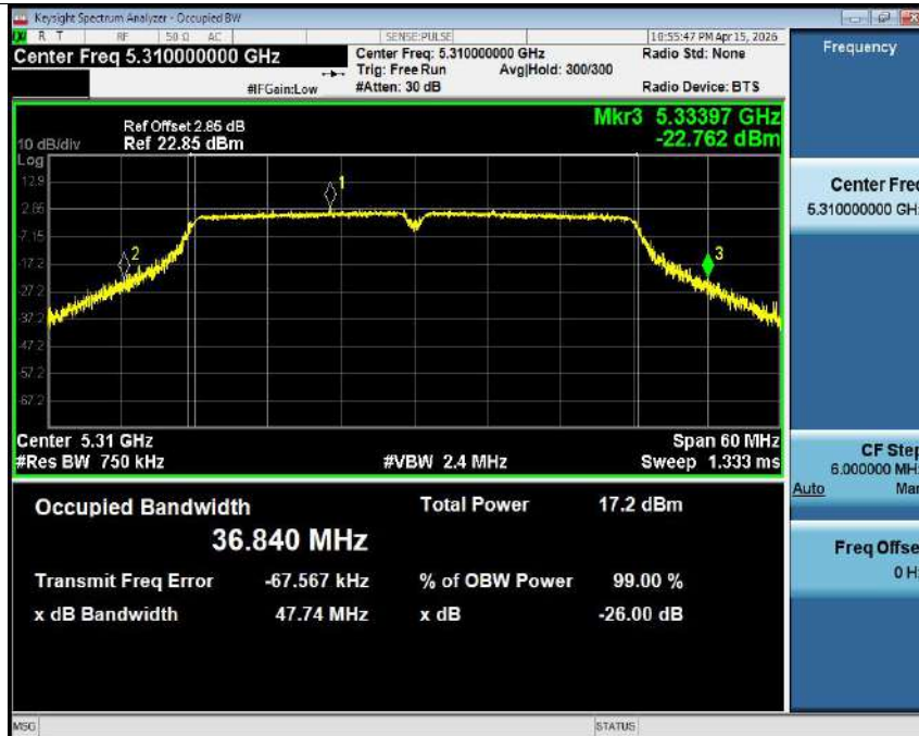
-26dB Bandwidth NVNT ac40 5310MHz Ant1
