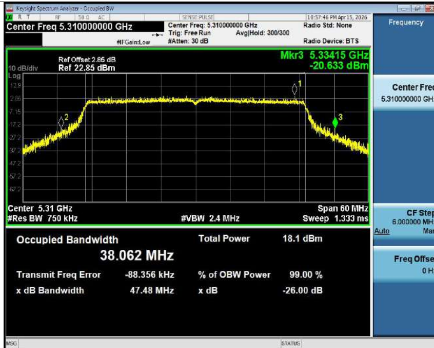
-26dB Bandwidth NVNT ax40 5310MHz Ant1
