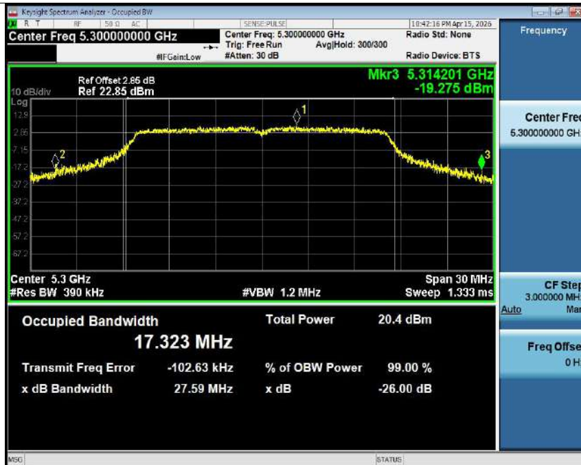
-26dB Bandwidth NVNT a 5300MHz Ant1
