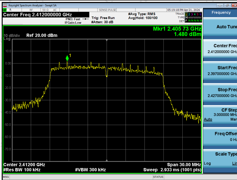
Band Edge NVNT n20 2412MHz Ant1 Ref
