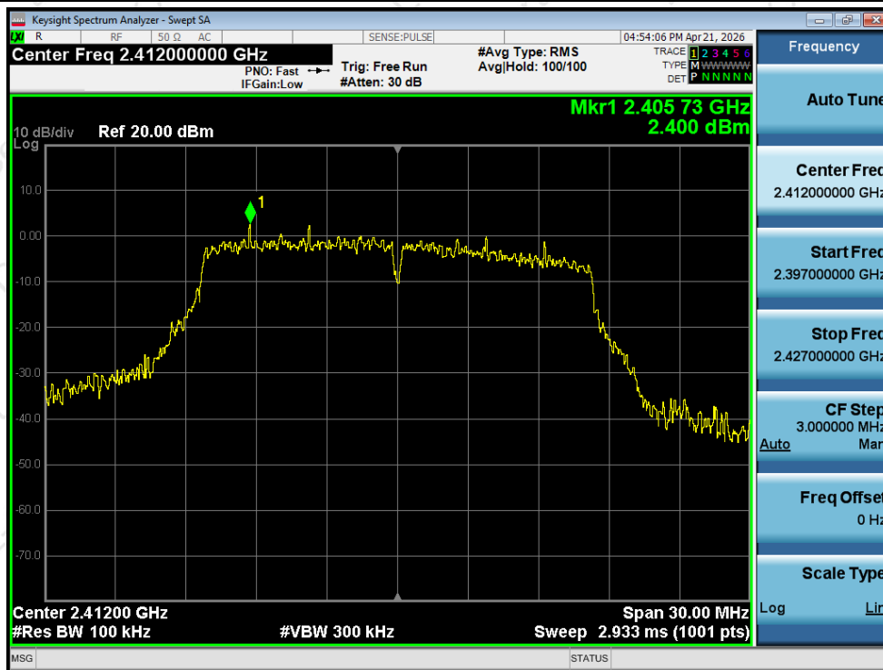
Band Edge NVNT g 2412MHz Ant1 Ref
