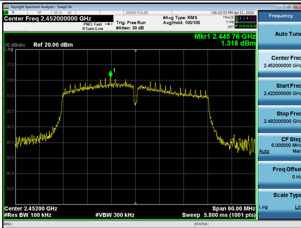
Band Edge NVNT n40 2452MHz Ant1 Ref
