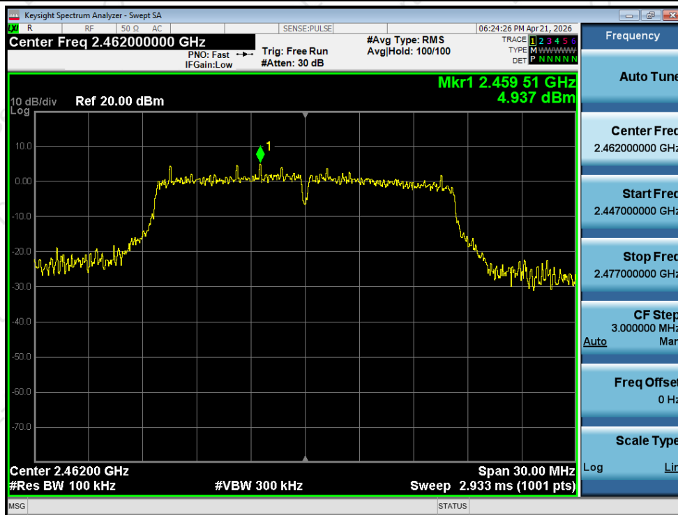
Band Edge NVNT g 2462MHz Ant1 Ref
