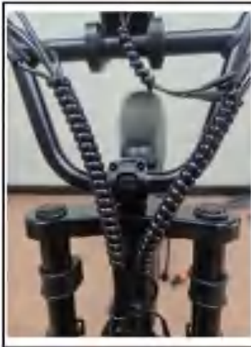
10. Monteer de voorkant en draai alle schroeven vast
