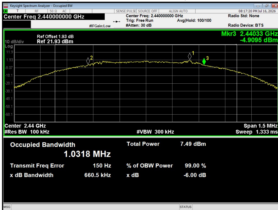
-6dB Bandwidth NVNT BLE 1M 2440MHz Ant1
