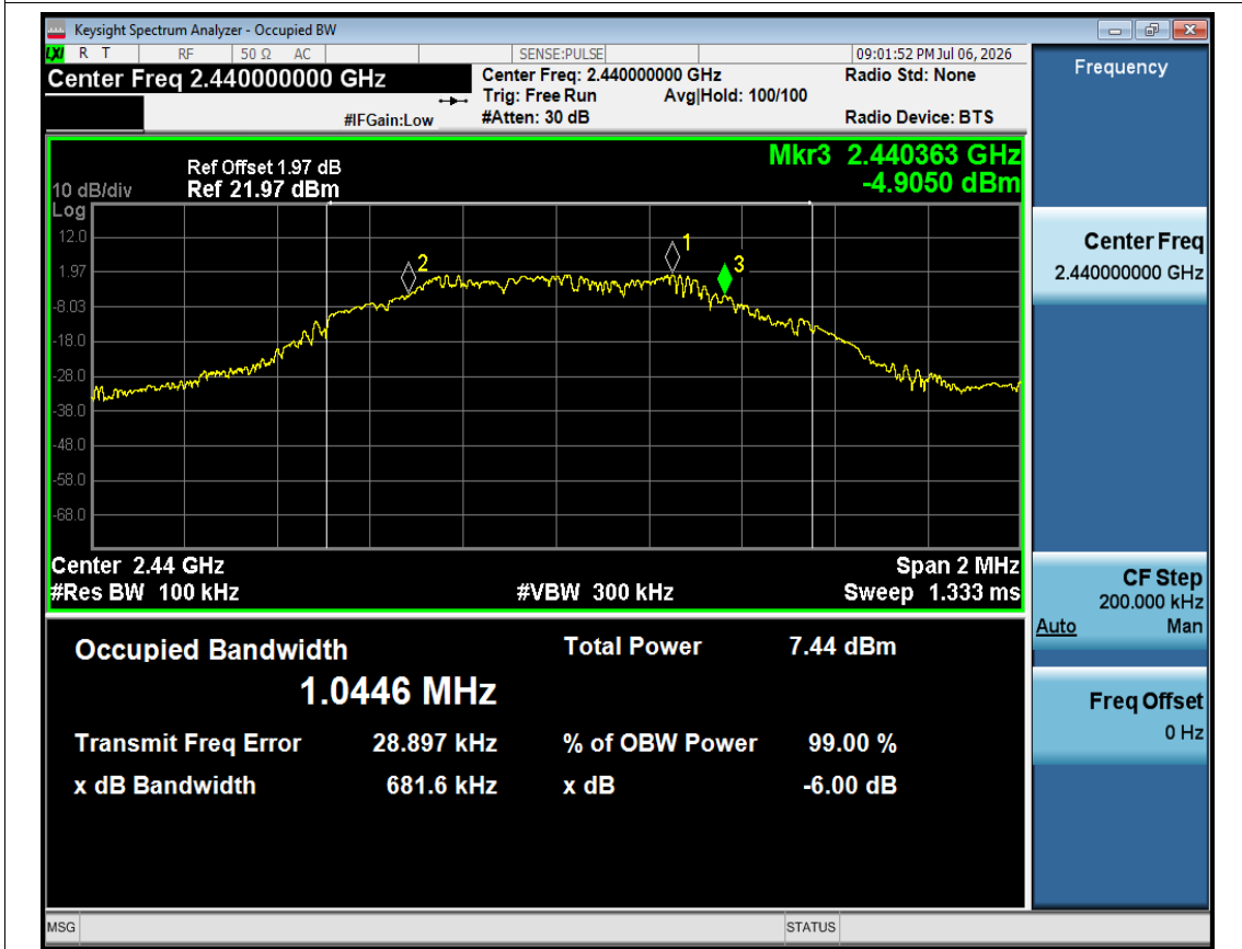
-6dB Bandwidth NVNT BLE 1M 2440MHz Ant1
