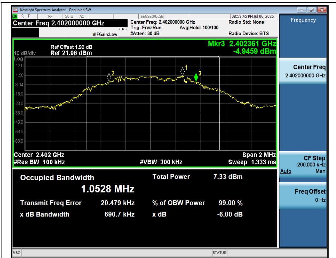
-6dB Bandwidth NVNT BLE 1M 2402MHz Ant1
