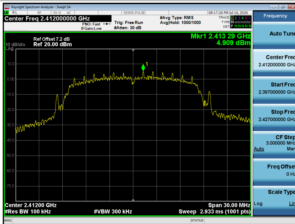
Band Edge NVNT g 2412MHz Ant1 Ref
