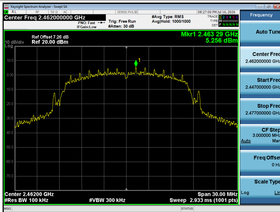
Band Edge NVNT g 2462MHz Ant1 Ref
