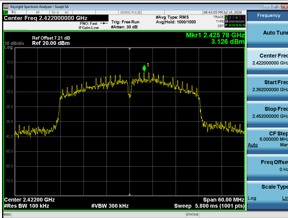
Band Edge NVNT n40 2422MHz Ant1 Ref
