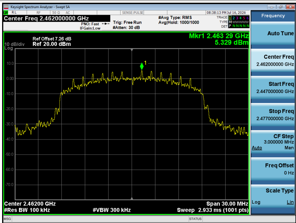
Band Edge NVNT n20 2462MHz Ant1 Ref
