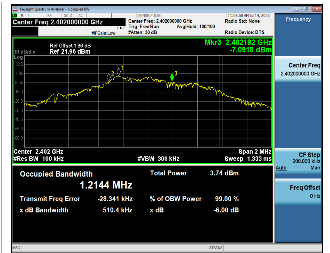
-6dB Bandwidth NVNT BLE 1M 2402MHz Ant1
