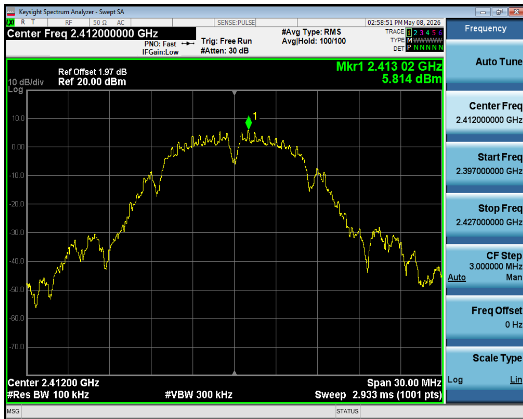
Band Edge NVNT b 2412MHz Ant1 Ref
