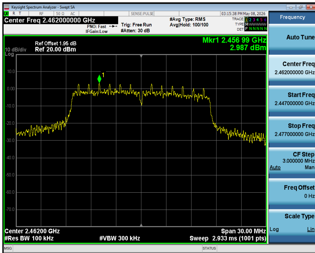
Band Edge NVNT g 2462MHz Ant1 Ref
