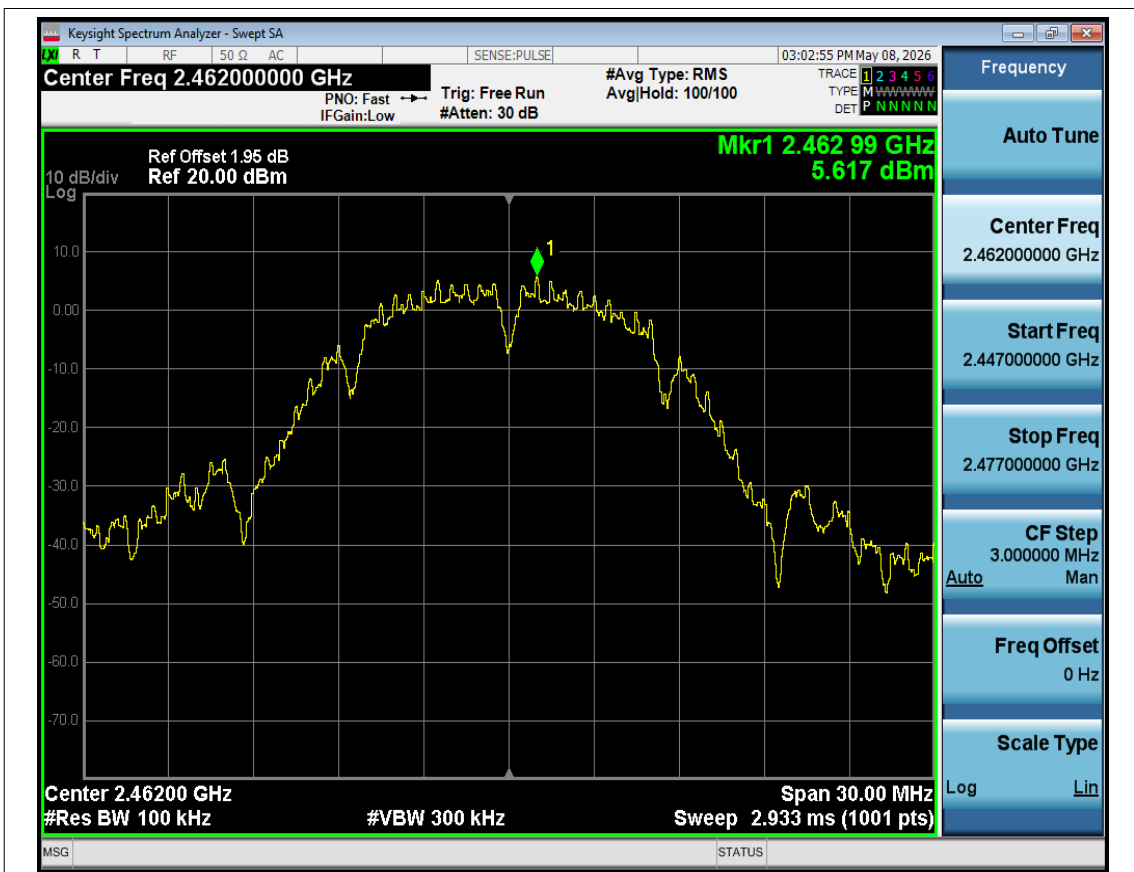
Band Edge NVNT b 2462MHz Ant1 Ref
