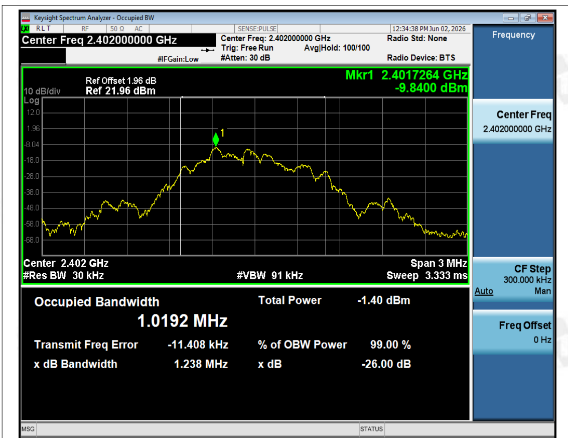
OBW NVNT BLE 1M 2402MHz Ant1
