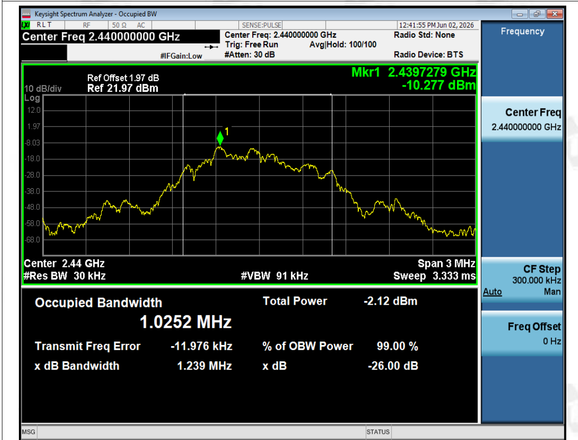
OBW NVNT BLE 1M 2440MHz Ant1
