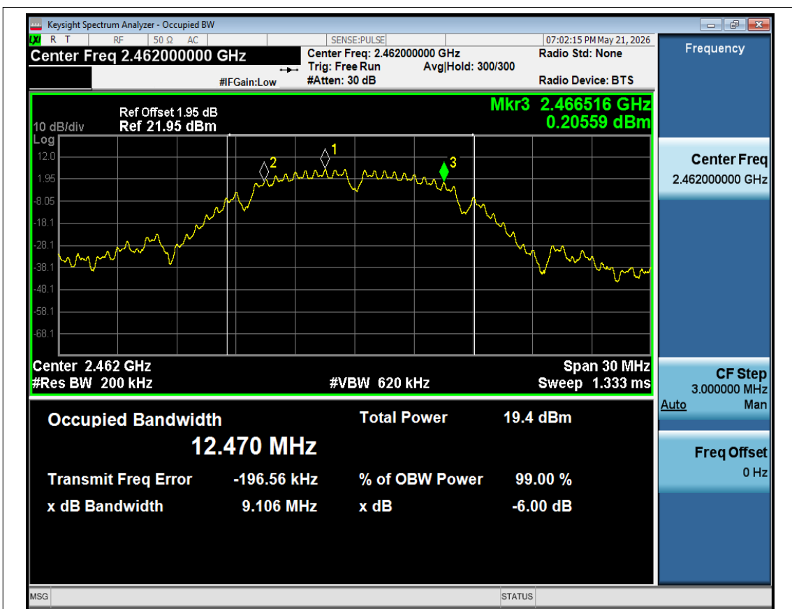
-6dB Bandwidth NVNT b 2462MHz Ant1
