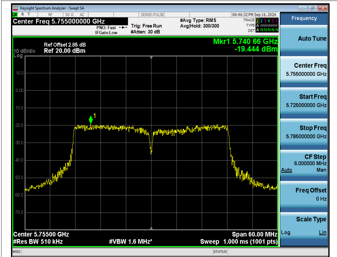
PSD NVNT ac40 5755MHz Ant1
