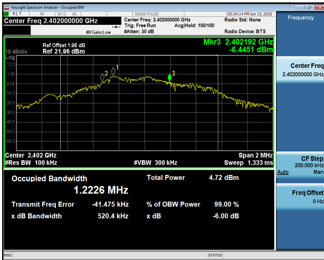
-6dB Bandwidth NVNT BLE 1M 2402MHz Ant1
