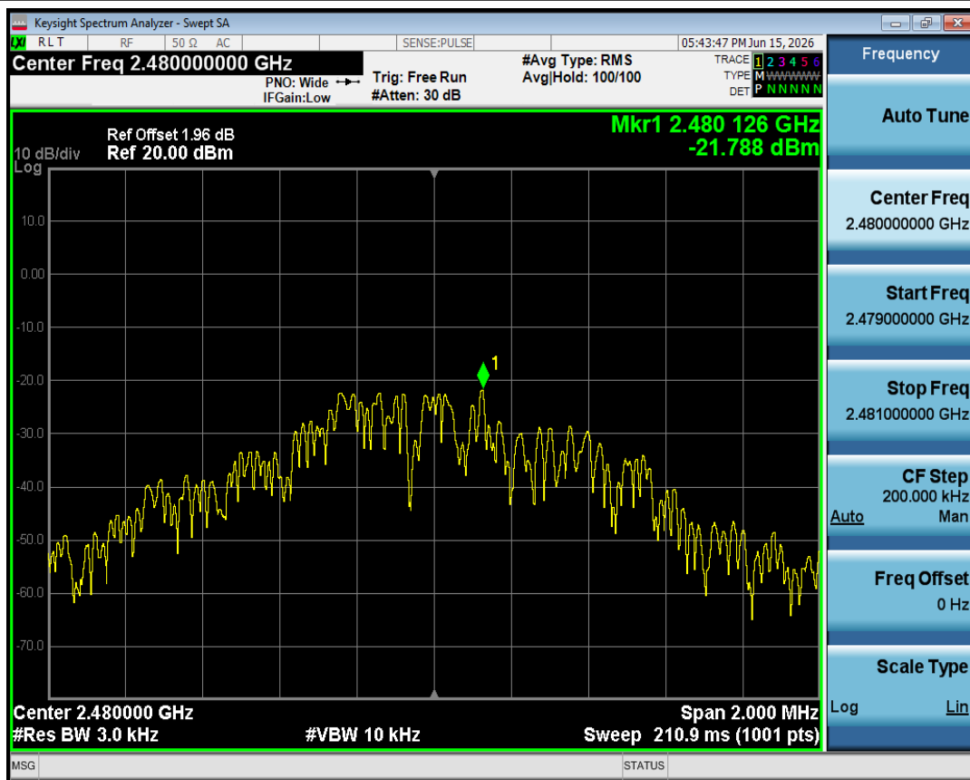
PSD NVNT BLE 1M 2480MHz Ant1
