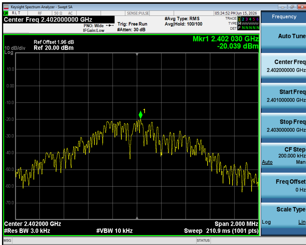
PSD NVNT BLE 1M 2402MHz Ant1
