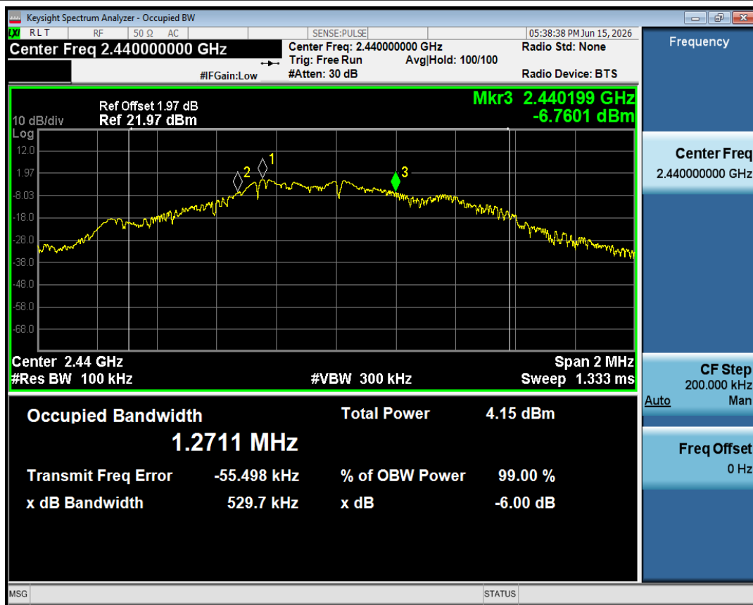
-6dB Bandwidth NVNT BLE 1M 2440MHz Ant1
