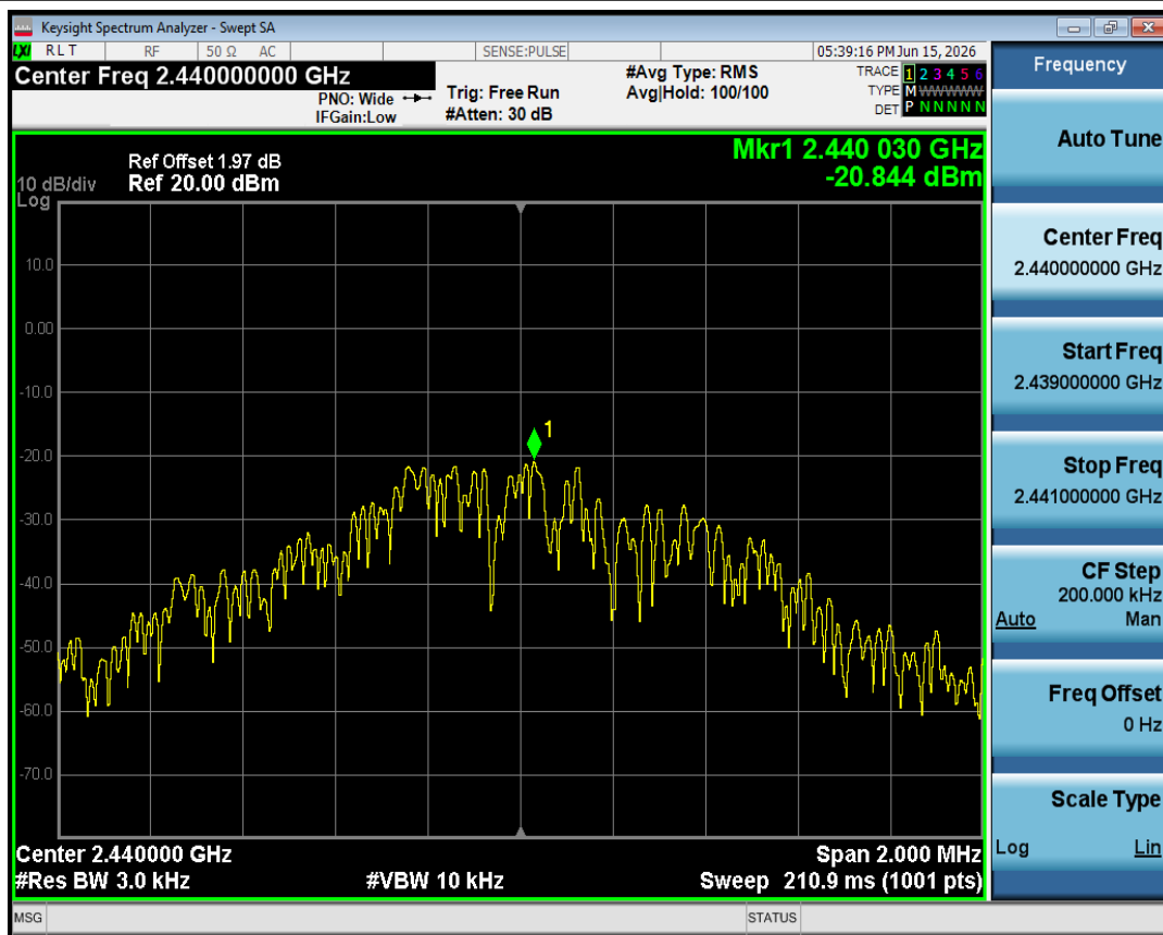
PSD NVNT BLE 1M 2440MHz Ant1
