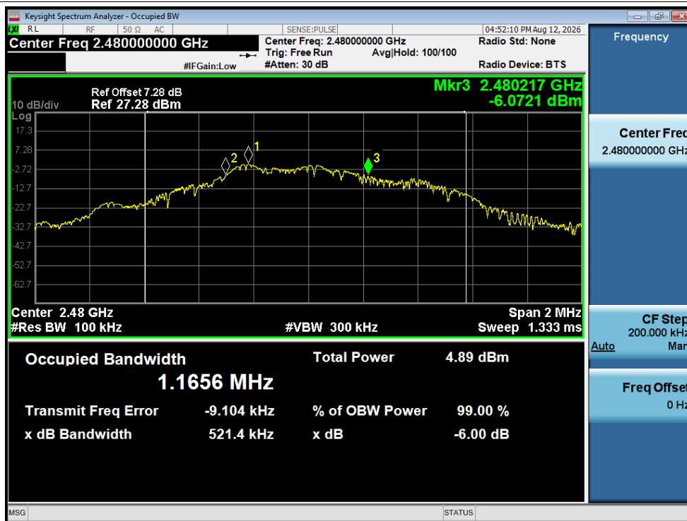
-6dB Bandwidth NVNT BLE 1M 2480MHz Ant1
