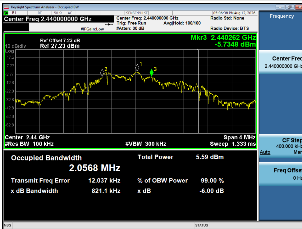
-6dB Bandwidth NVNT BLE 2M 2440MHz Ant1
