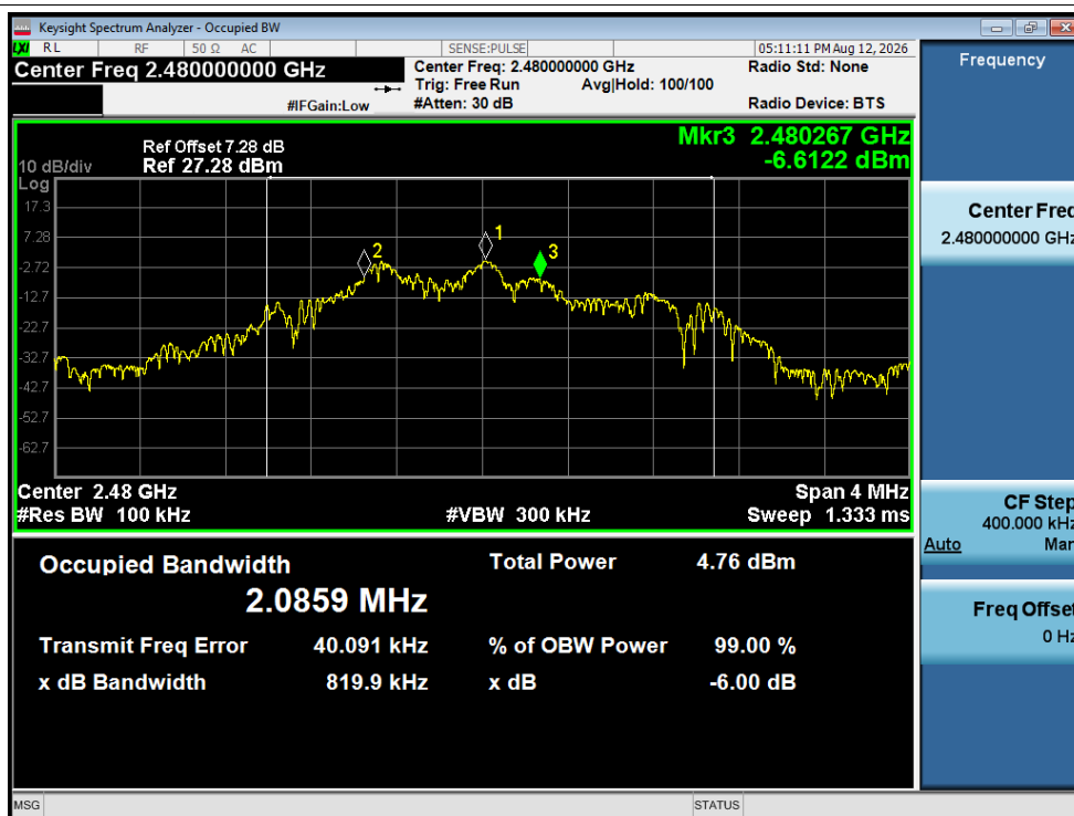
-6dB Bandwidth NVNT BLE 2M 2480MHz Ant1
