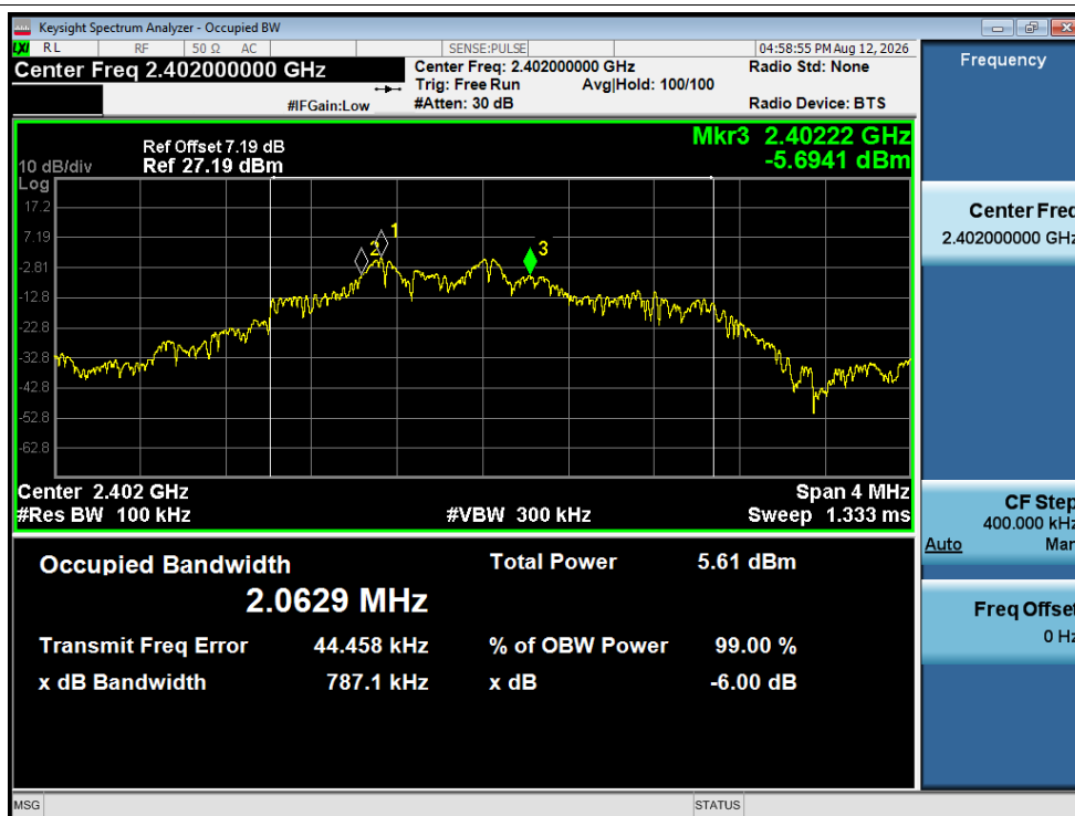
-6dB Bandwidth NVNT BLE 2M 2402MHz Ant1
