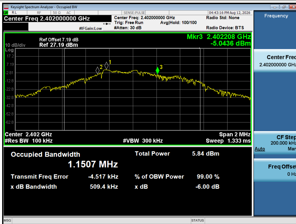
-6dB Bandwidth NVNT BLE 1M 2402MHz Ant1
