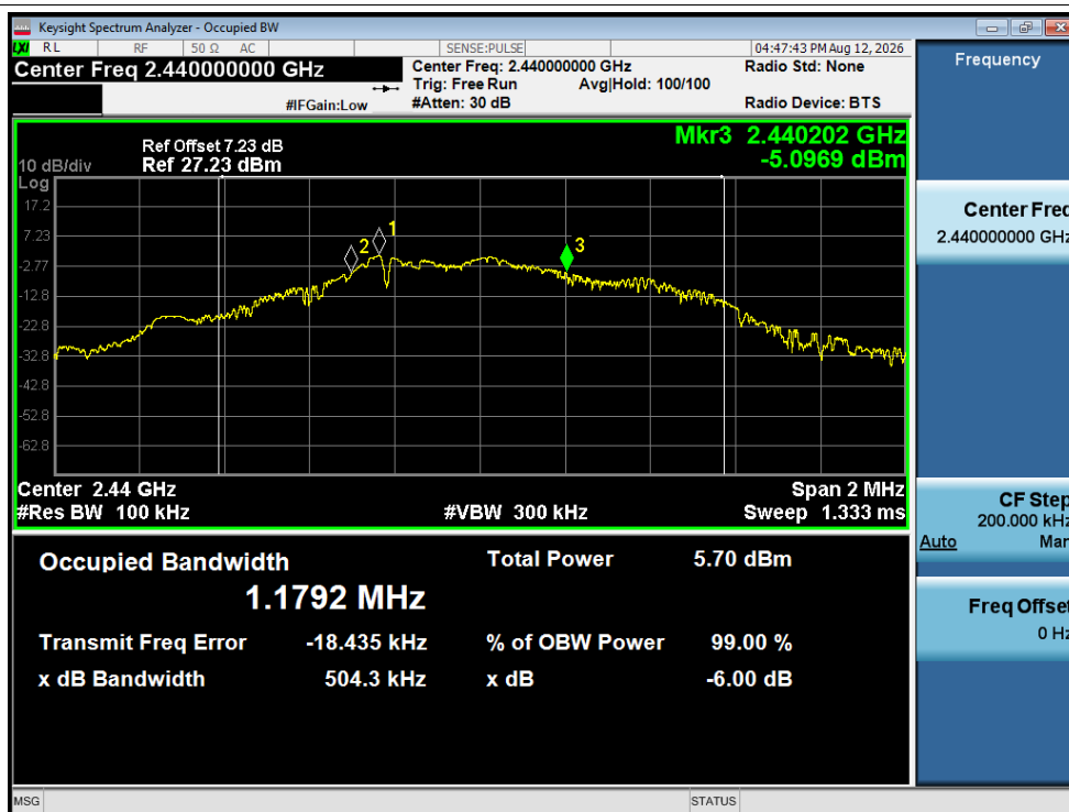
-6dB Bandwidth NVNT BLE 1M 2440MHz Ant1
