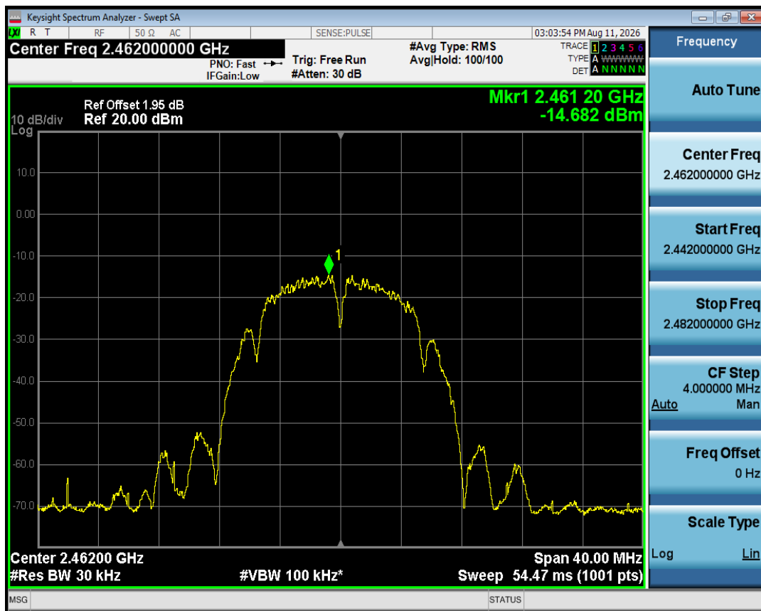
PSD NVNT b 2462MHz Ant1
