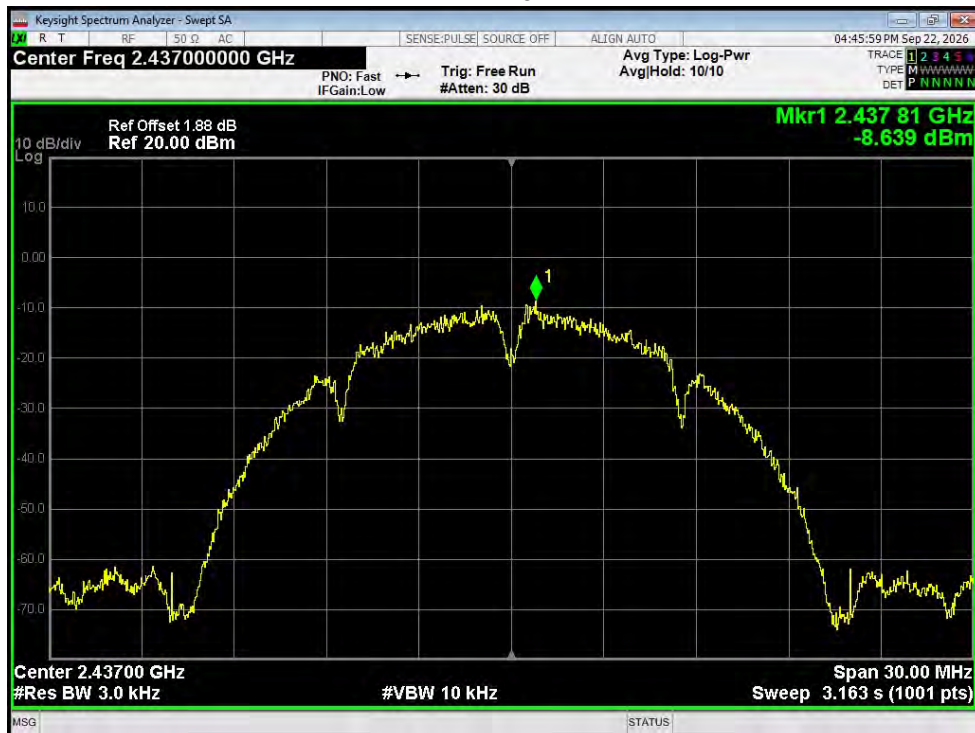
PSD NVNT b 2437MHz Ant1
