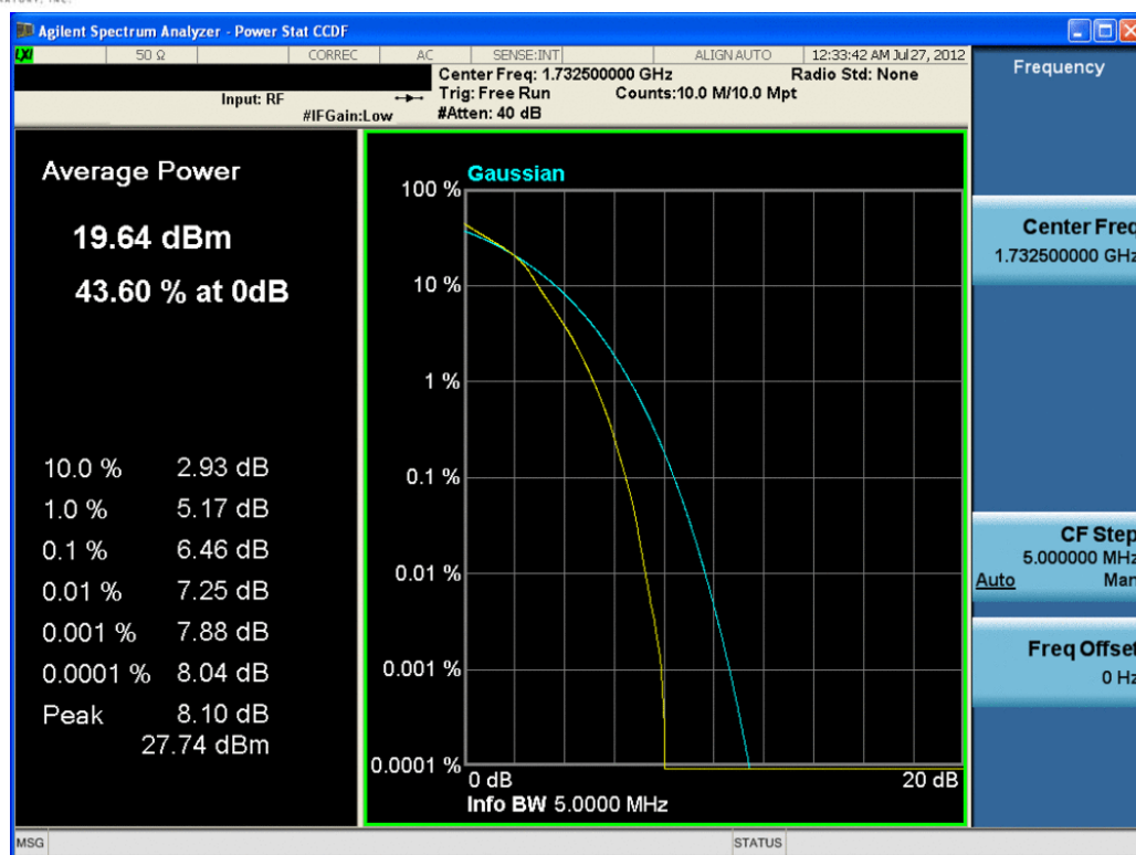
Plot 7-14. PAR Plot (5MHz 16QAM – RB Size 25)
