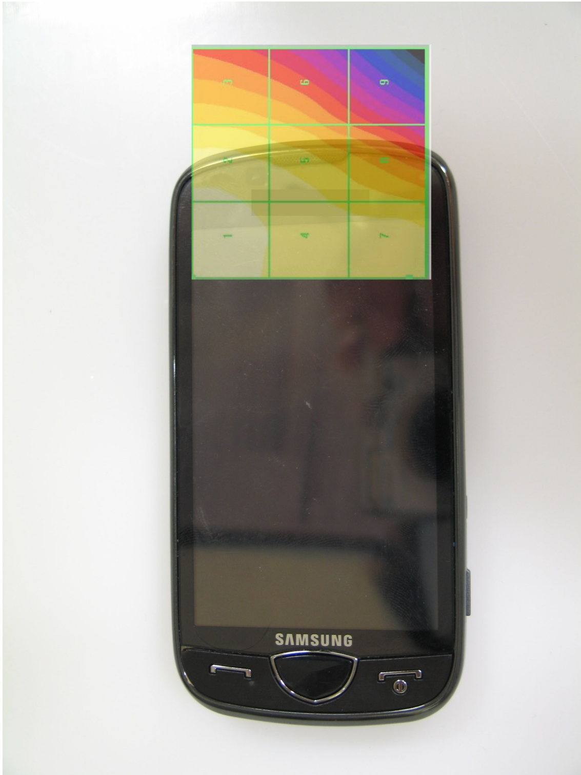
Scan overlay with actual device(H-field)
