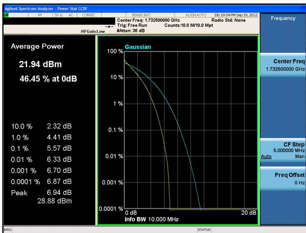
Plot 9-21. PAR Plot (10MHz QPSK – RB Size 50)
