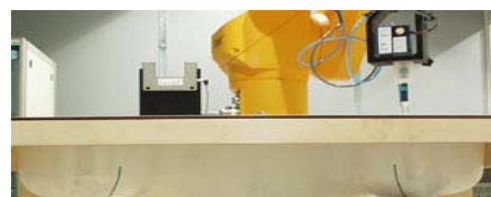
Figure3.5 SAM Twin Phantom
