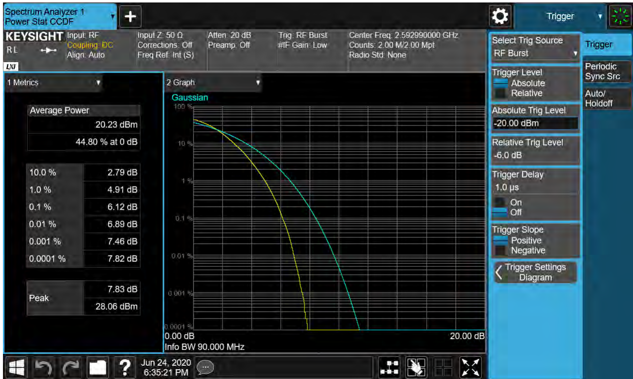
Sub6 n41. PAR Plot (90M BW_Ch.518598_64QAM_RB25_0)
