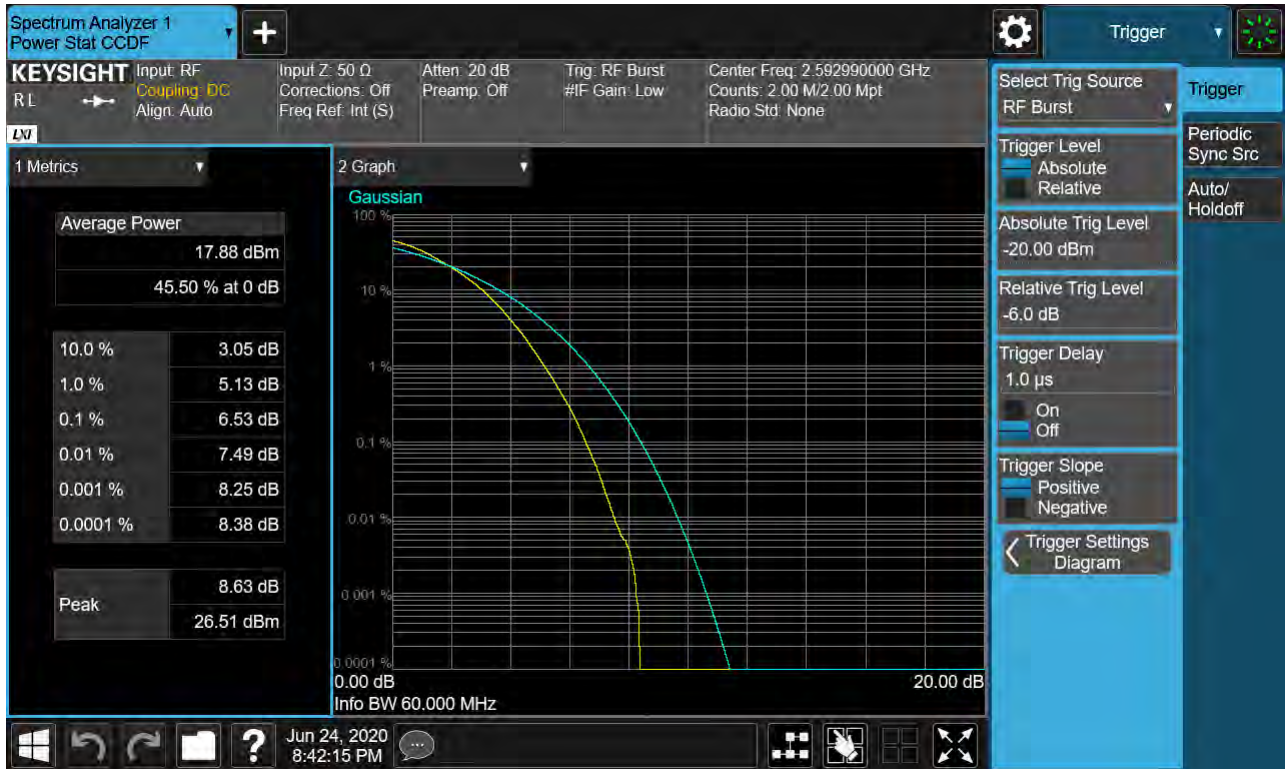
Sub6 n41. PAR Plot (60M BW_Ch.518598_256QAM_RB25_0)
