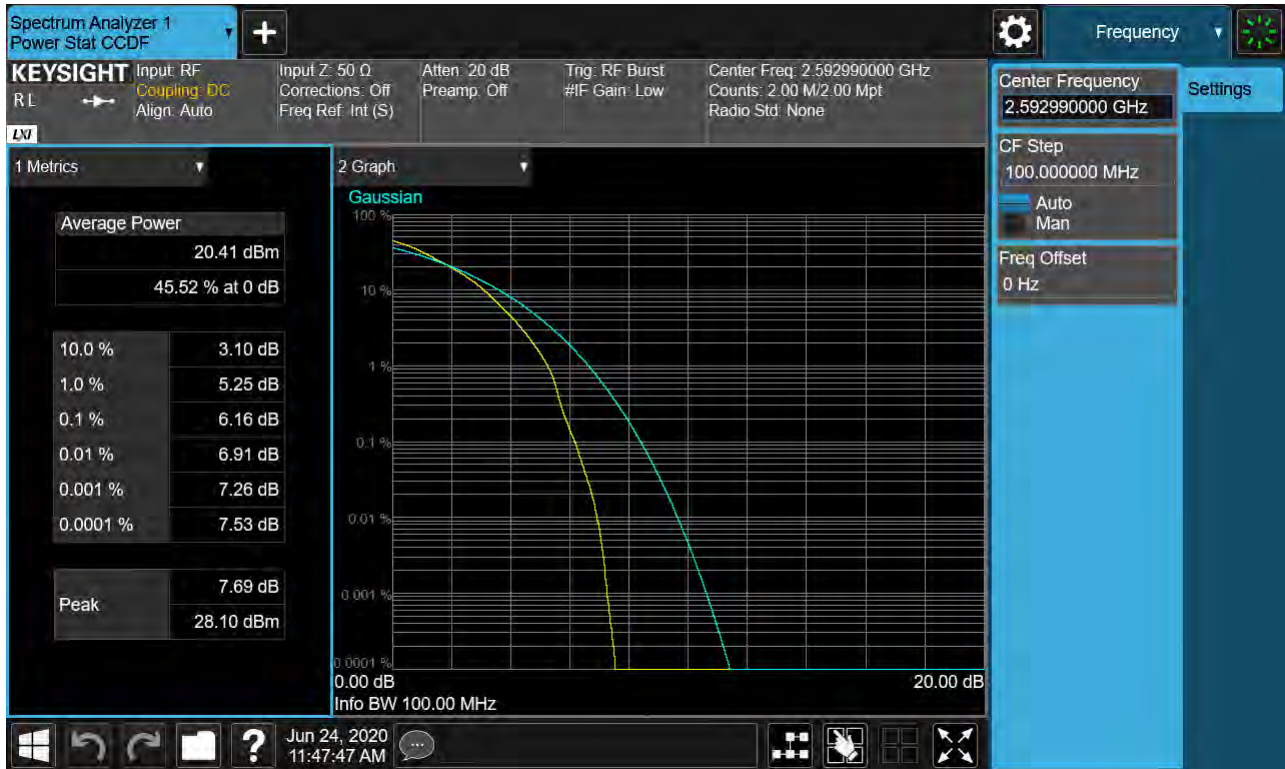
Sub6 n41. PAR Plot (100M BW_Ch.518598_16QAM_RB25_0)
