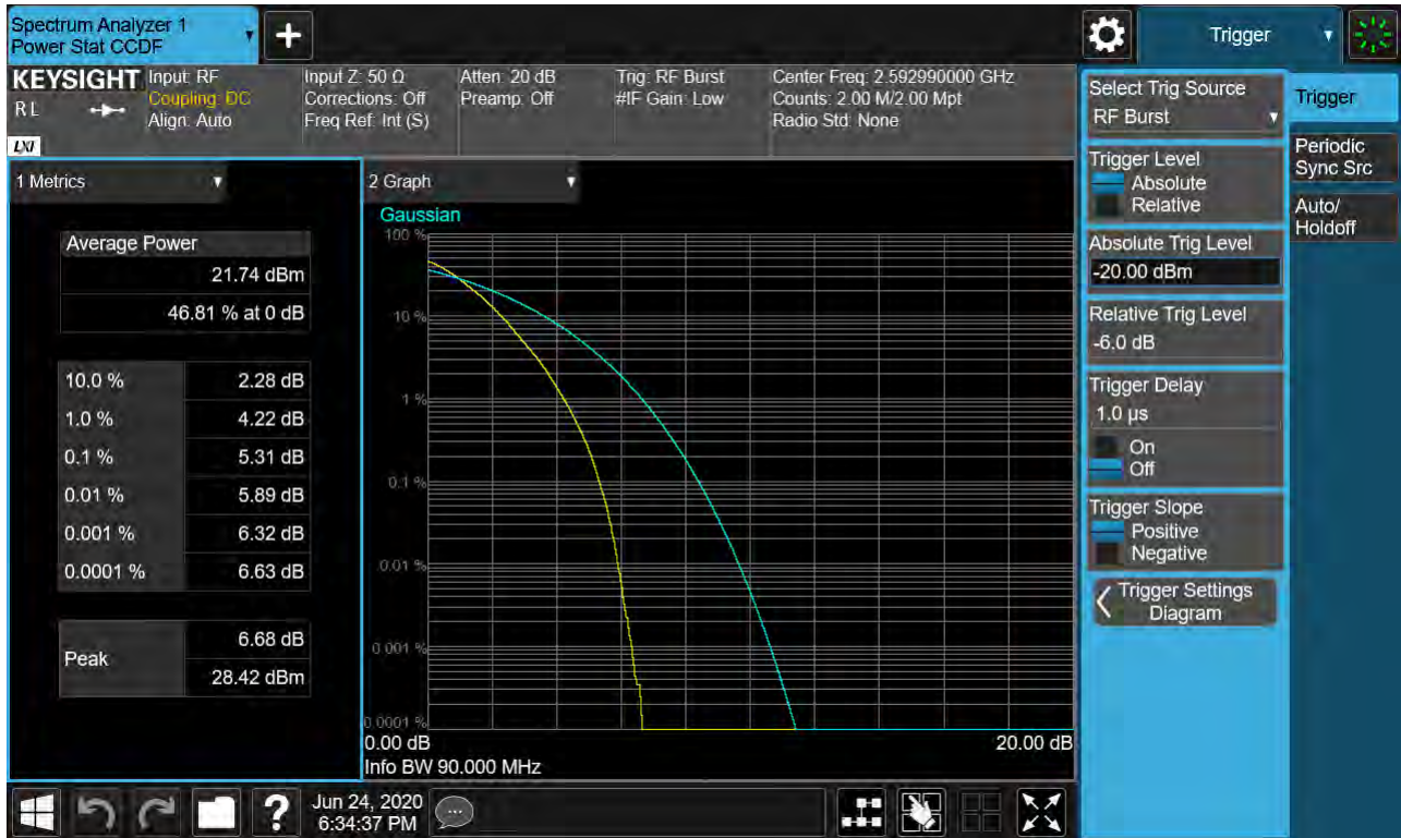
Sub6 n41. PAR Plot (90M BW_Ch.518598_QPSK_RB25_0)
