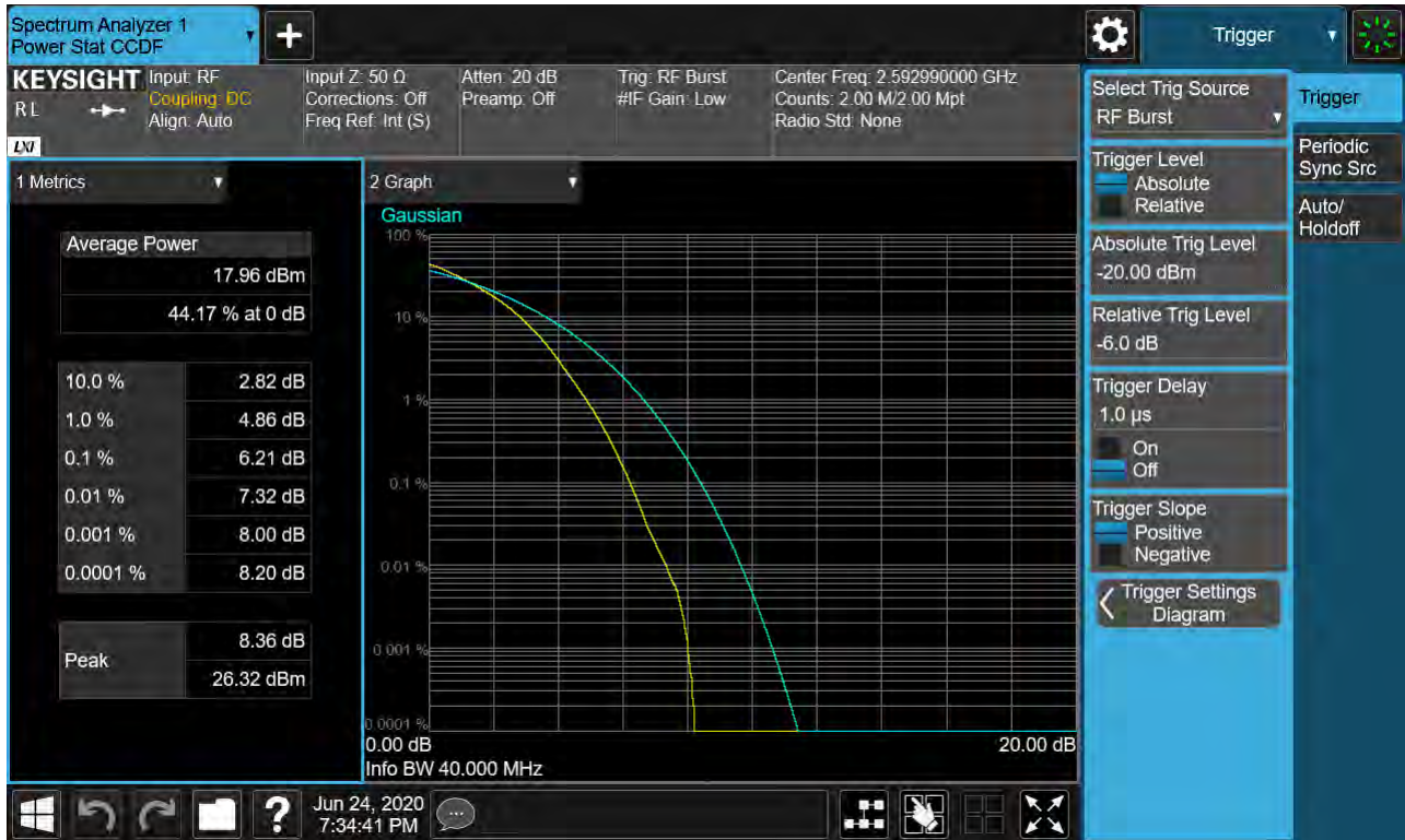
Sub6 n41. PAR Plot (40M BW_Ch.518598_256QAM_RB25_0)
