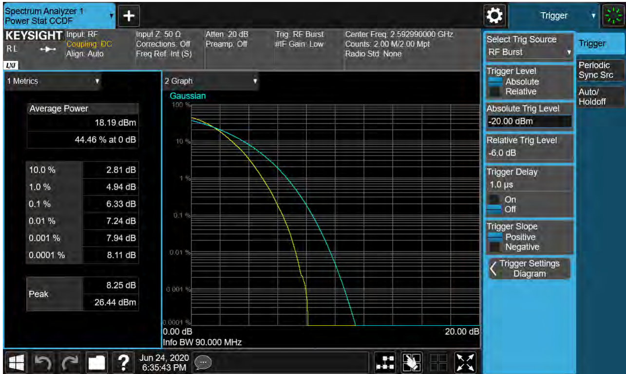
Sub6 n41. PAR Plot (90M BW_Ch.518598_256QAM_RB25_0)
