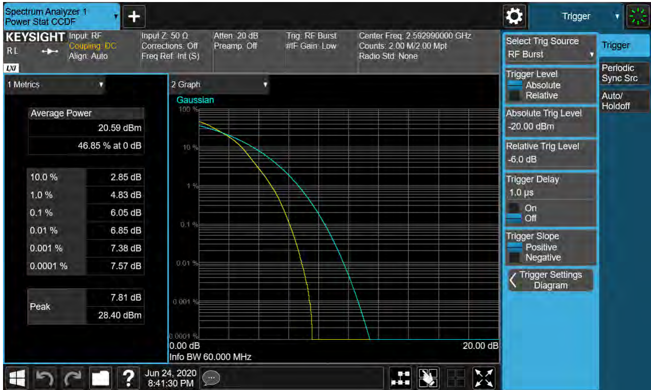
Sub6 n41. PAR Plot (60M BW_Ch.518598_16QAM_RB25_0)
