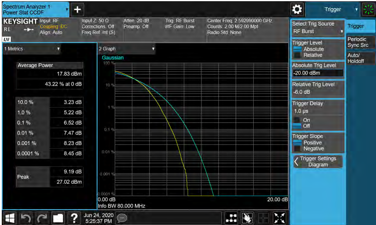
Sub6 n41. PAR Plot (80M BW_Ch.518598_256QAM_RB25_0)
