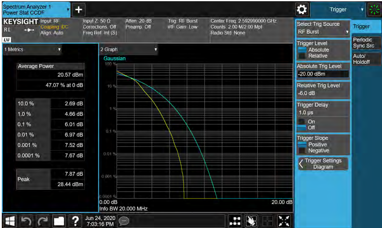
Sub6 n41. PAR Plot (20M BW_Ch.518598_16QAM_RB25_0)
