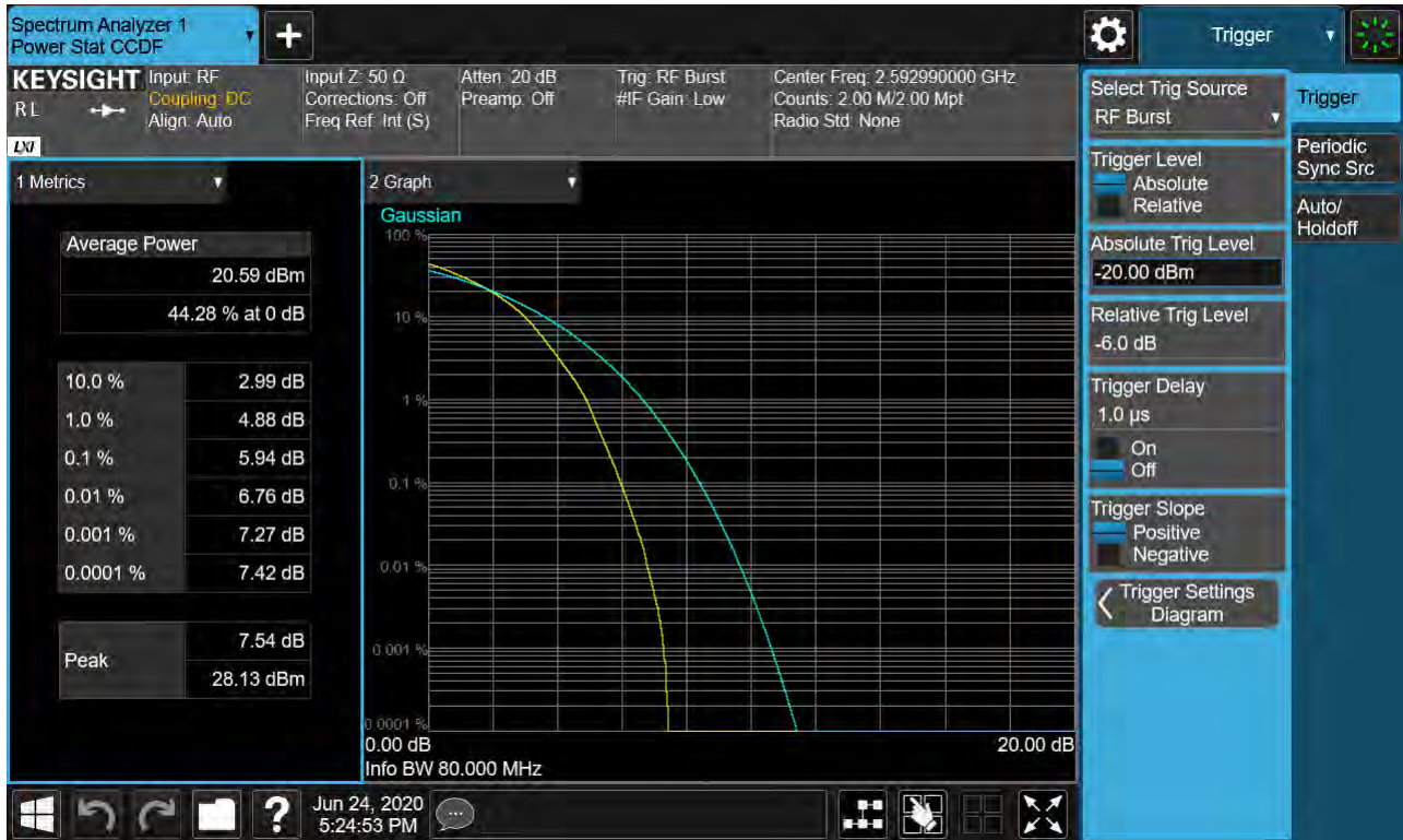
Sub6 n41. PAR Plot (80M BW_Ch.518598_16QAM_RB25_0)
