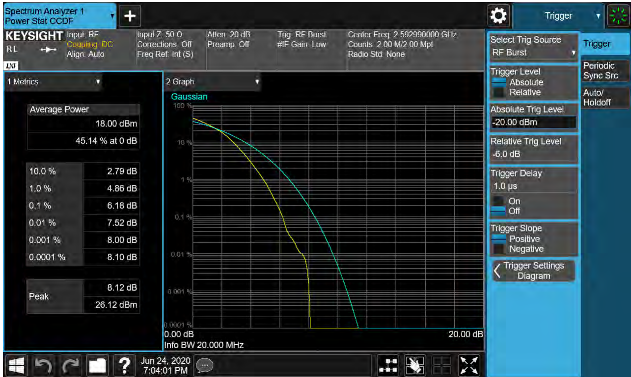
Sub6 n41. PAR Plot (20M BW_Ch.518598_256QAM_RB25_0)
