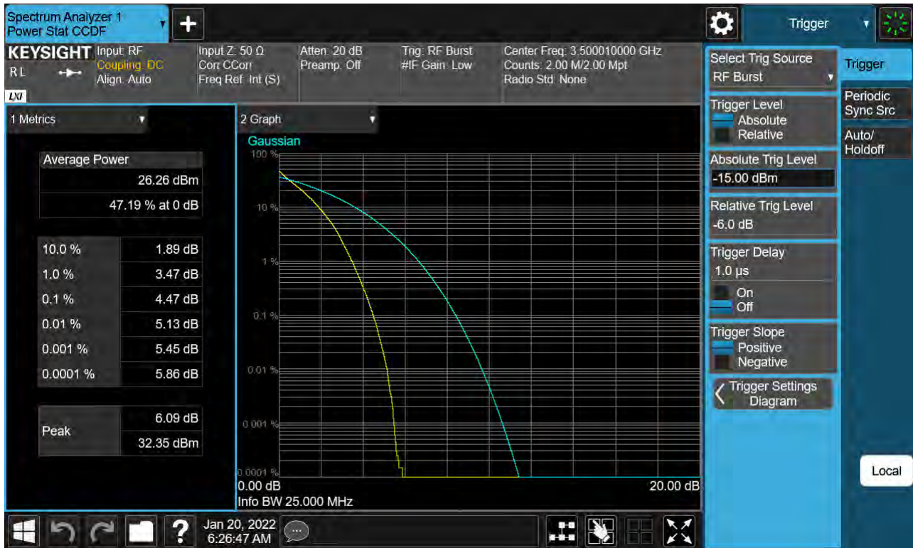
Sub6 n77. PAR Plot (25 M BW_Ch.633334_ BPSK)
