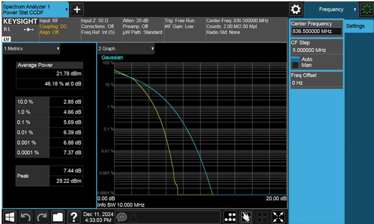
BAND 26. PAR Plot (10 M BW Ch.26915 16QAM_RB50_0)
