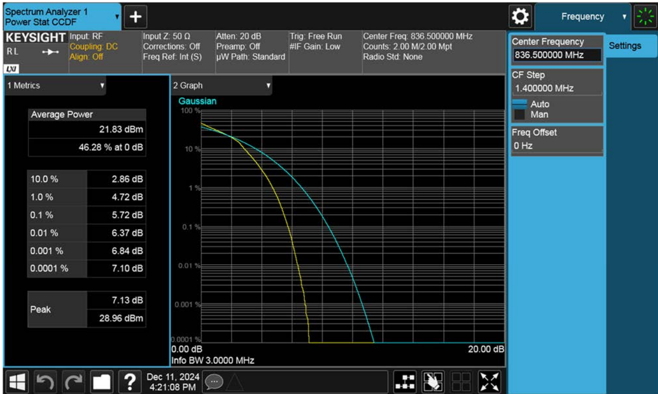
BAND 26 PAR Plot (3 M BW Ch.26915 16QAM_RB15_0)
