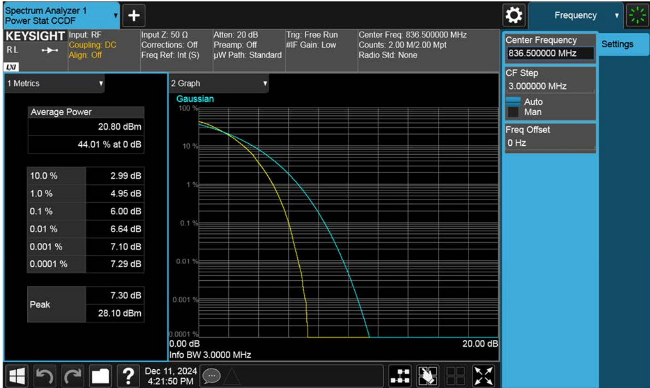
BAND 26. PAR Plot (3 M BW Ch.26915 64QAM_RB15_0)
