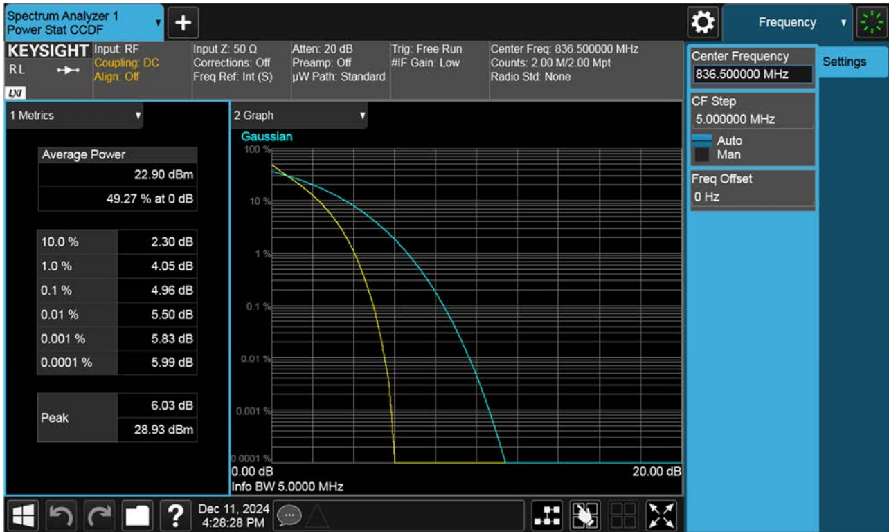
BAND 26. PAR Plot (5 M BW Ch.26915 QPSK_RB25_0)
