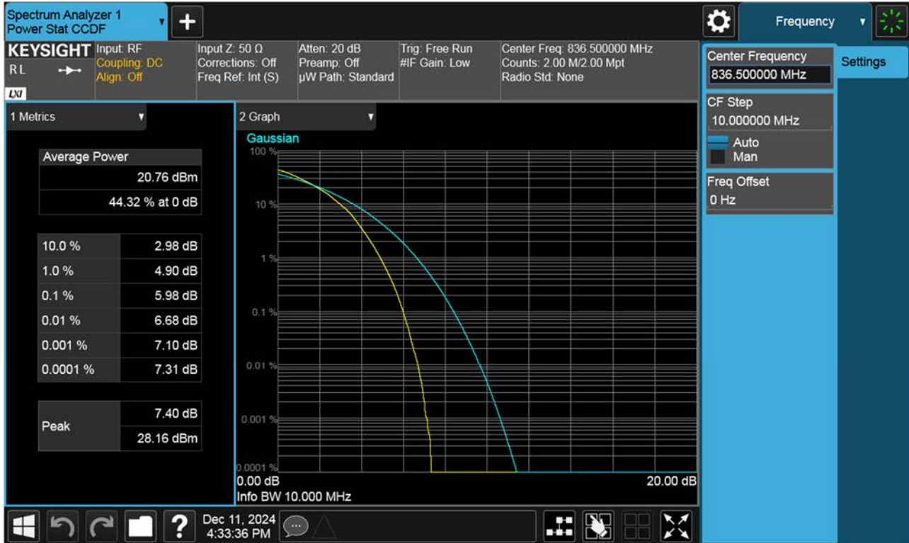
BAND 26. PAR Plot (10 M BW Ch.26915 64QAM_RB50_0)
