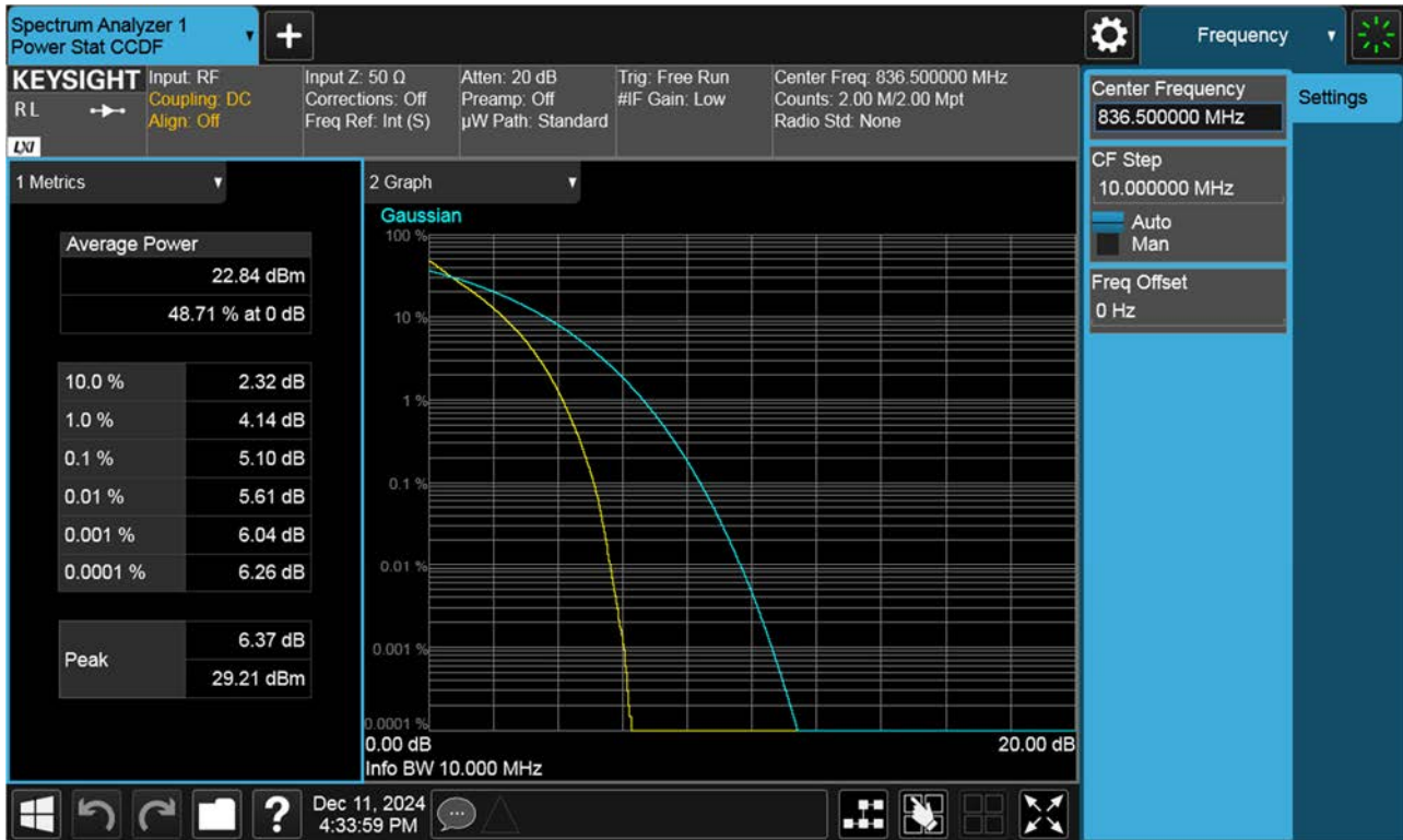
BAND 26. PAR Plot (10 M BW Ch.26915 QPSK_RB50_0)
