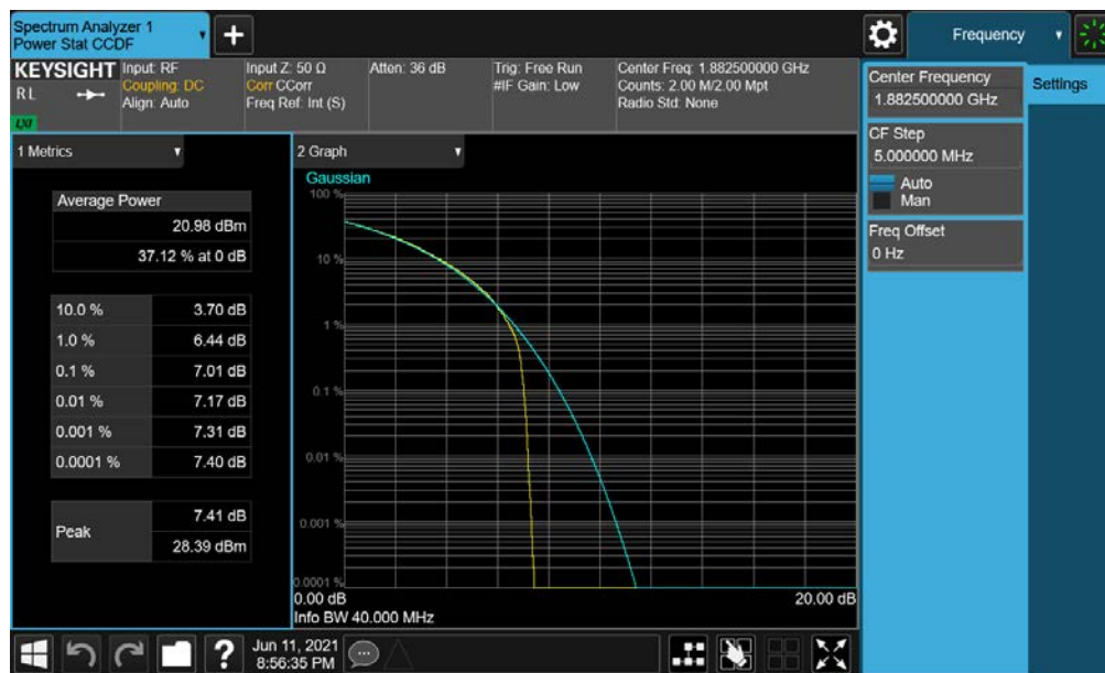
Plot 7-244. PAR Plot (NR Band n25 - 40.0MHz CP-OFDM QPSK - Full RB)
