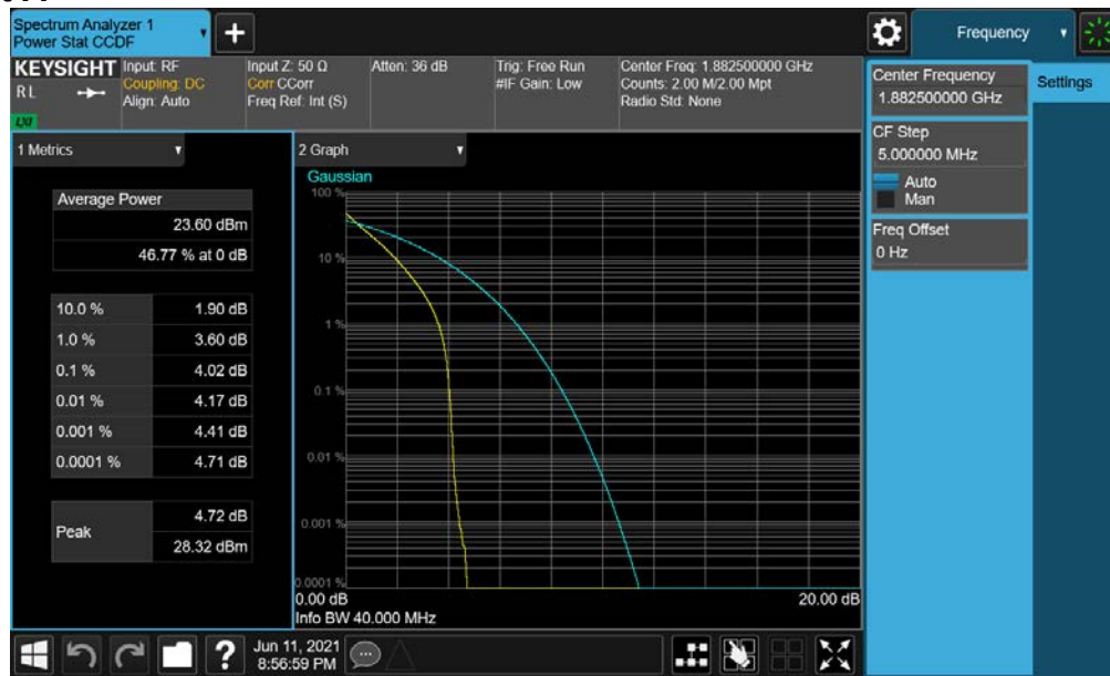
Plot 7-243. PAR Plot (NR Band n25 - 40.0MHz DFT-s-OFDM BPSK - Full RB)
