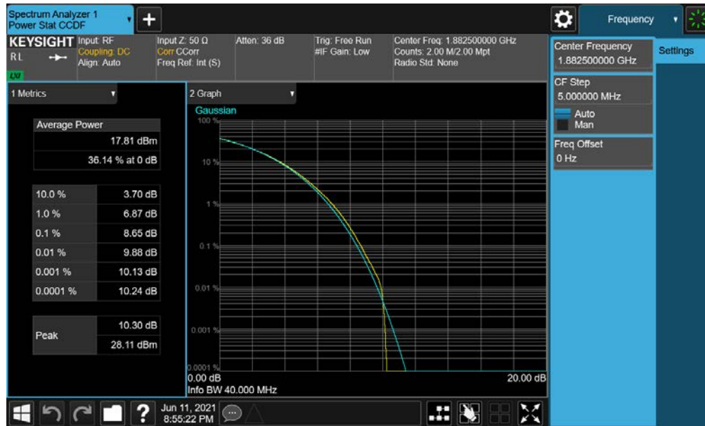
Plot 7-245. PAR Plot (NR Band n25 - 40.0MHz CP-OFDM 256-QAM - Full RB)
