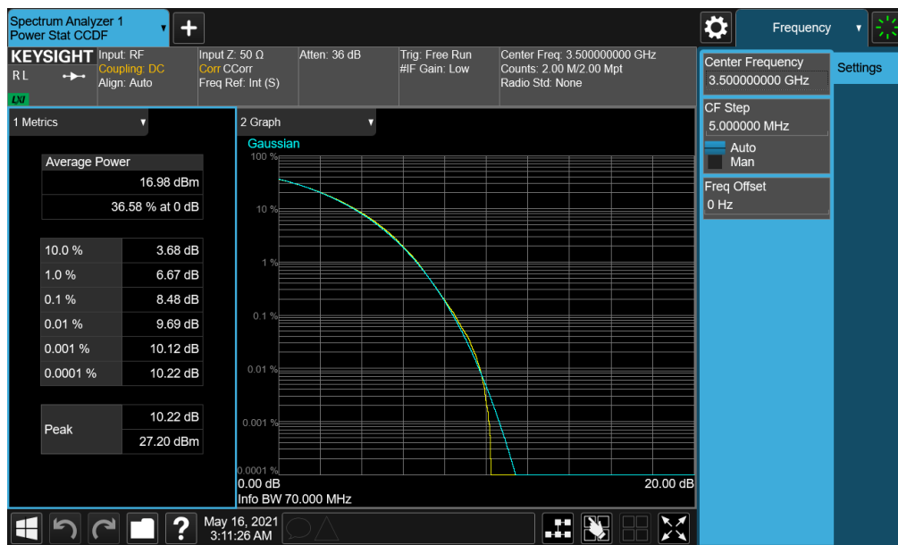
Plot 7-189. PAR Plot (NR Band n77 PC2 - 70MHz CP-OFDM 256-QAM - Full RB)
