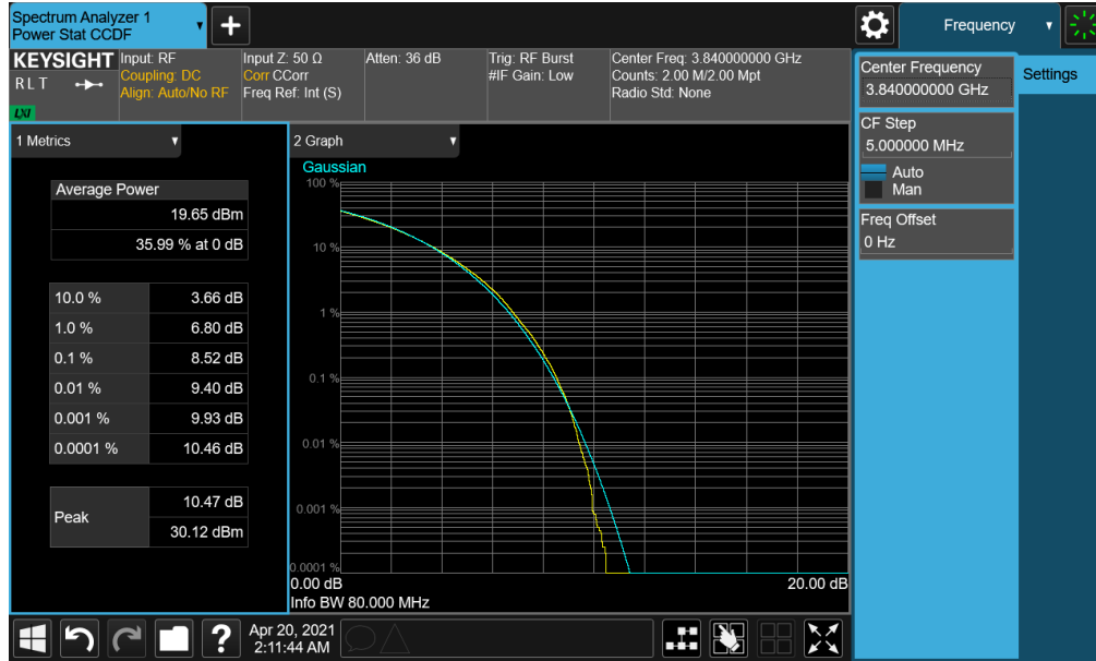
Plot 7-159. PAR Plot (NR Band n77 PC2 - 80MHz CP-OFDM 256-QAM - Full RB)
