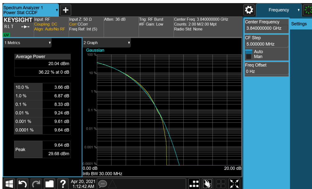
Plot 7-174. PAR Plot (NR Band n77 PC2 - 30MHz CP-OFDM 256-QAM - Full RB)
