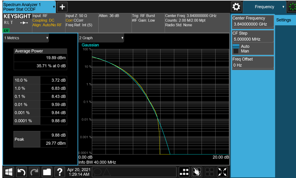
Plot 7-171. PAR Plot (NR Band n77 PC2 - 40MHz CP-OFDM 256-QAM - Full RB)
