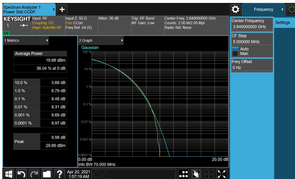
Plot 7-162. PAR Plot (NR Band n77 PC2 - 70MHz CP-OFDM 256-QAM - Full RB)
