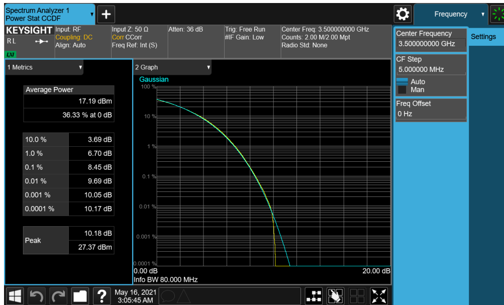
Plot 7-186. PAR Plot (NR Band n77 PC2 - 80MHz CP-OFDM 256-QAM - Full RB)
