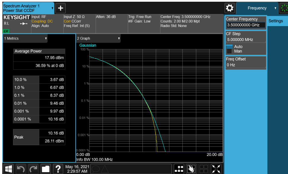
Plot 7-180. PAR Plot (NR Band n77 PC2 - 100MHz CP-OFDM 256-QAM - Full RB)
