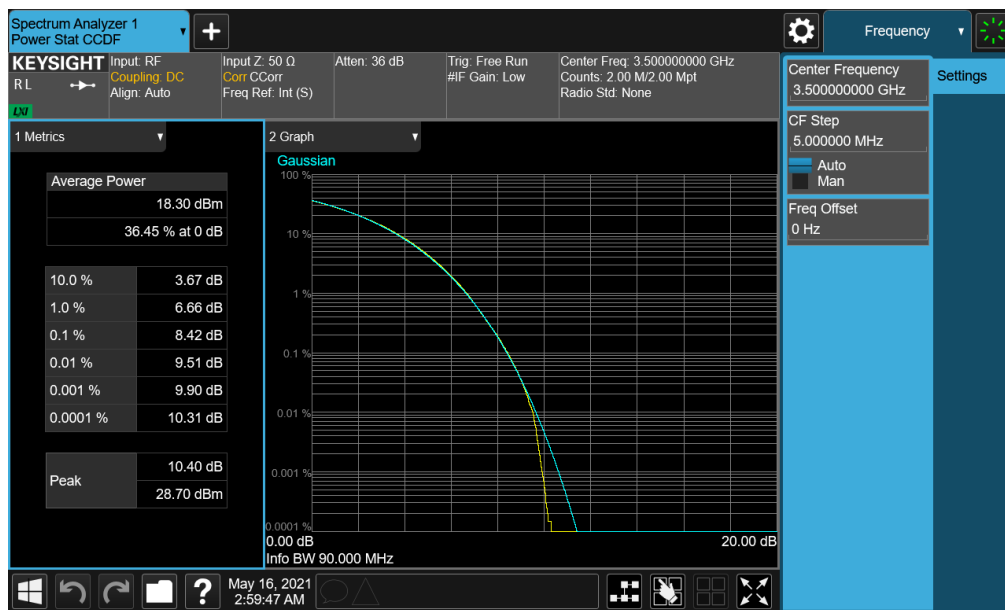
Plot 7-183. PAR Plot (NR Band n77 PC2 - 90MHz CP-OFDM 256-QAM - Full RB)
