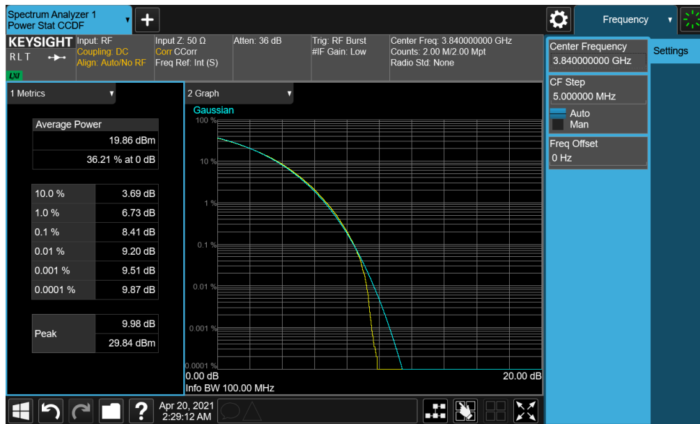
Plot 7-153. PAR Plot (NR Band n77 PC2 - 100MHz CP-OFDM 256-QAM - Full RB)
