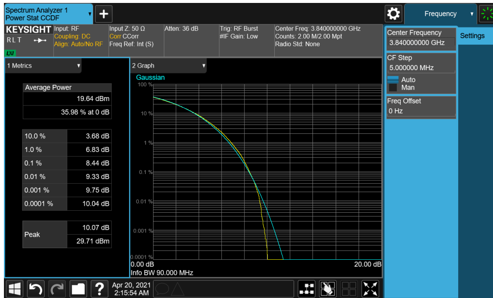
Plot 7-156. PAR Plot (NR Band n77 PC2 - 90MHz CP-OFDM 256-QAM - Full RB)
