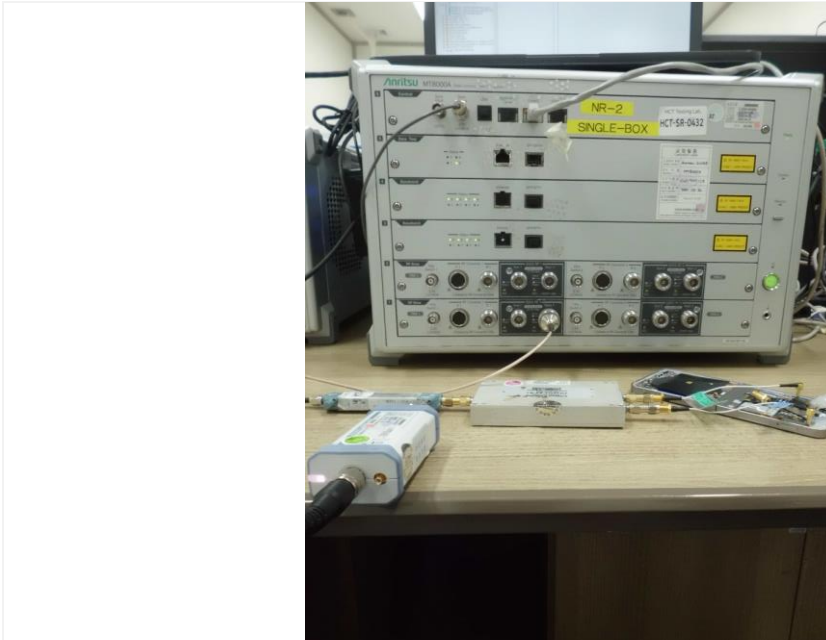
Test setup photo-5 (7-1(b) 5G Sub 6 SA)
