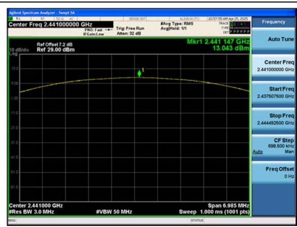
Dual ANT.2 \pi /4DQPSK : Peak Power (Ch. 39)
