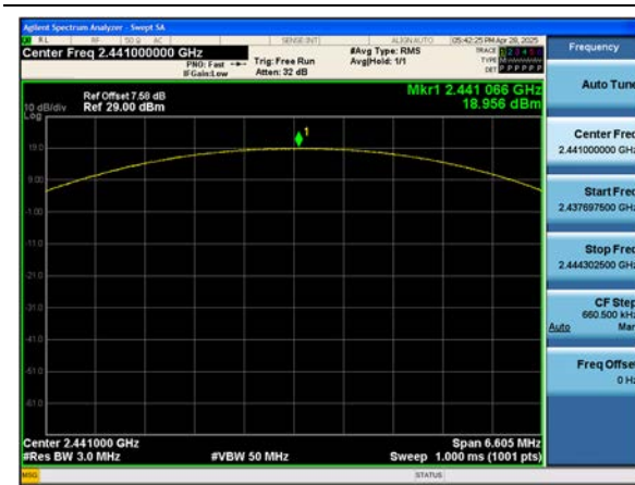
ANT.1 \pi/4 DQPSK : Peak Power (Ch. 39)
