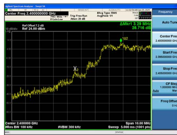
Dual ANT.2 \pi/4 DQPSKBand Edge(Ch. 0)
