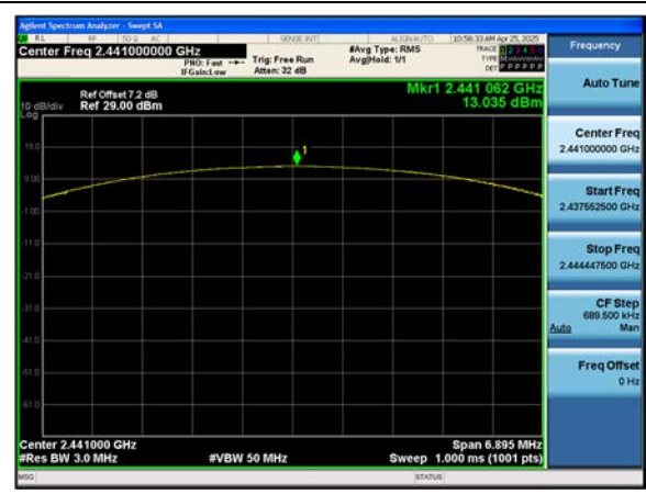
Dual ANT.2 \pi /4DQPSK : Peak Power (Ch. 39)
