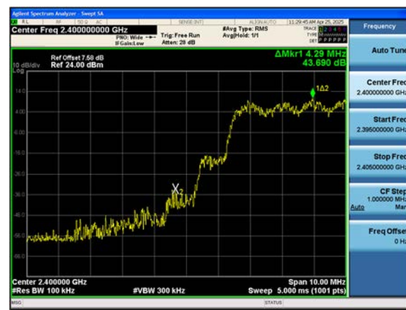
Dual ANT.2 \pi/4 DQPSKBand Edge(Ch. 0)
