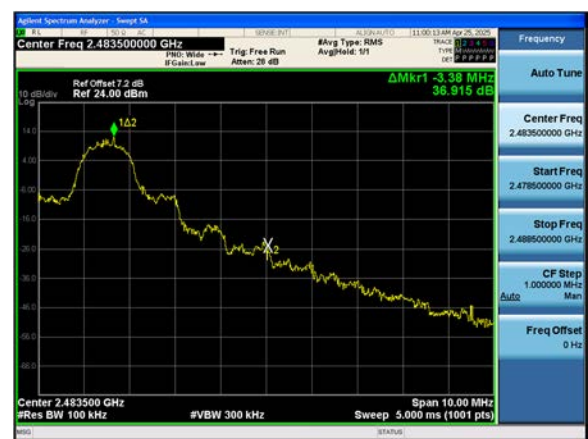
Dual ANT.2 \pi/4 DQPSKBand Edge(Ch. 78)
