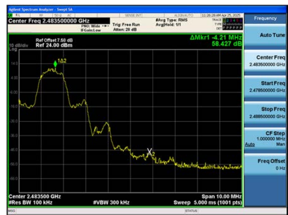
Dual ANT.2 \pi/4 DQPSKBand Edge(Ch. 78)
