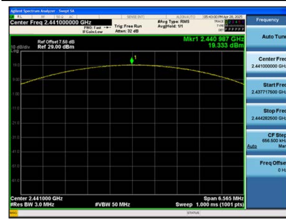
ANT.1 \pi/4 DQPSK : Peak Power (Ch. 39)
