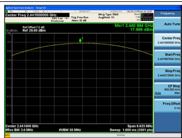
ANT.2 \pi/4 DQPSK : Peak Power (Ch. 39)
