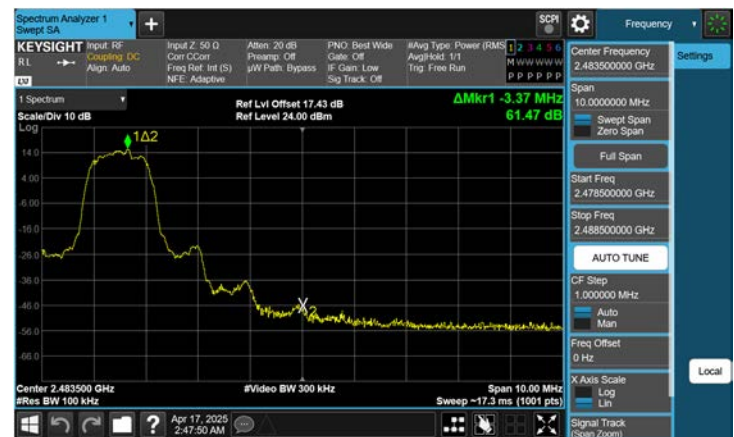
ANT.2 8DPSK Band Edge(Ch. 78)
