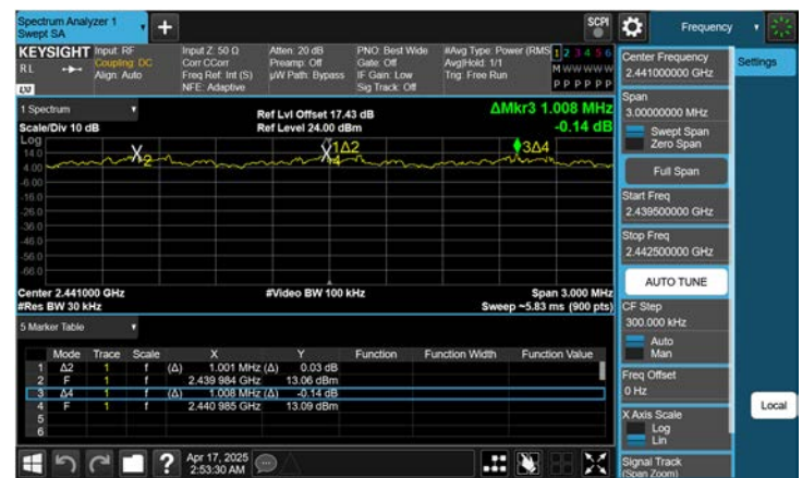
ANT. 2 \pi/4 DQPSK : Channel Separation
