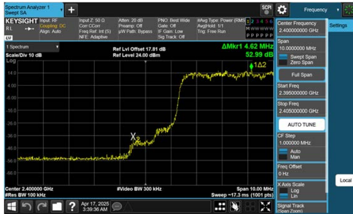
ANT.2 8DPSKBand Edge(Ch. 0)
