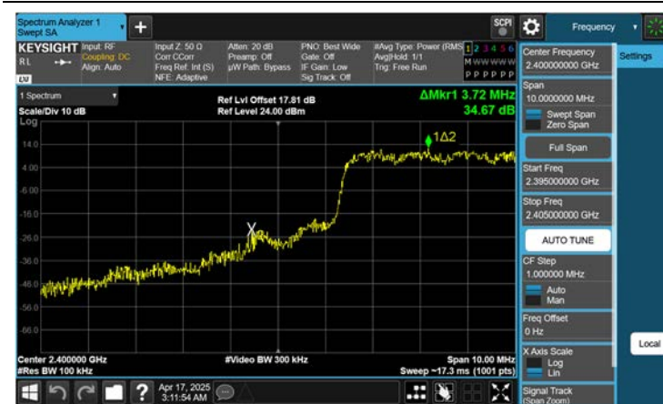
Dual ANT.2 8DPSKBand Edge(Ch. 0)
