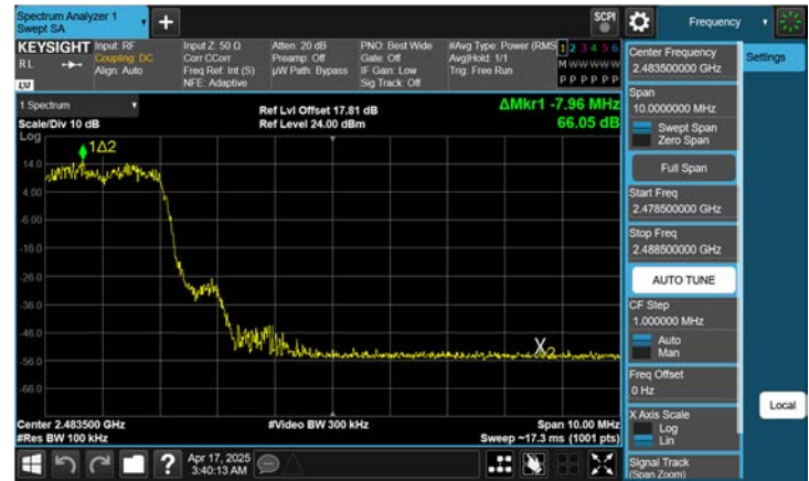
ANT.2 8DPSKBand Edge(Ch. 78)
