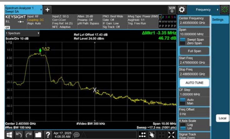
Dual ANT.2 8DPSKBand Edge(Ch. 78)
