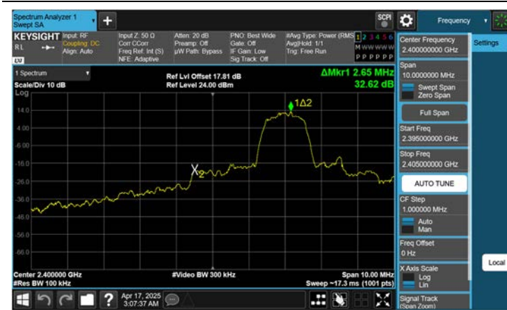
Dual ANT.2 8DPSKBand Edge(Ch. 0)
