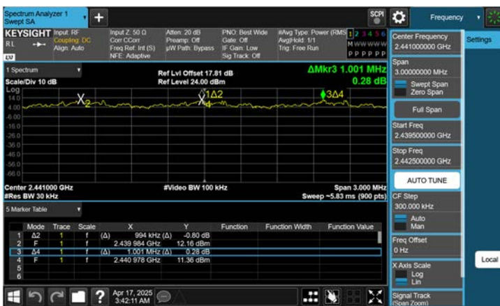
ANT. 1 \pi/4 DQPSK : Channel Separation
