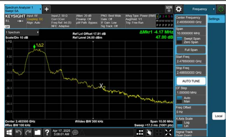
Dual ANT.2 8DPSKBand Edge(Ch. 78)
