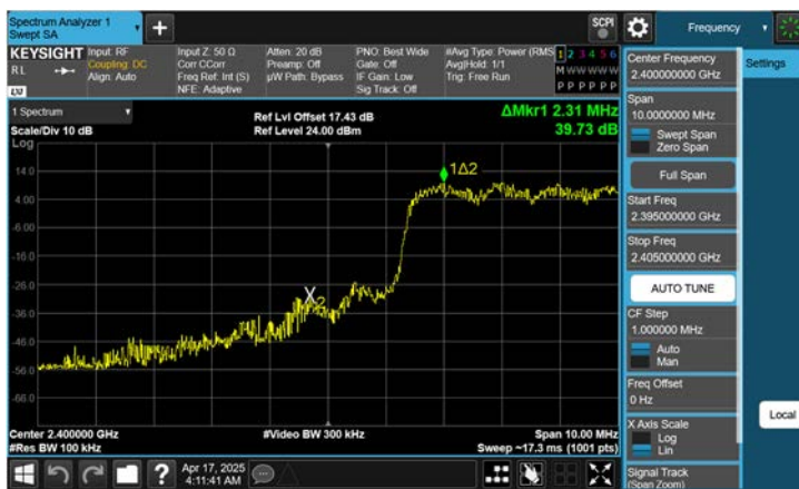
Dual ANT.2 8DPSKBand Edge(Ch. 0)
