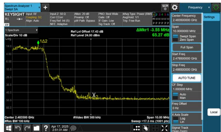
ANT.2 8DPSKBand Edge(Ch. 78)
