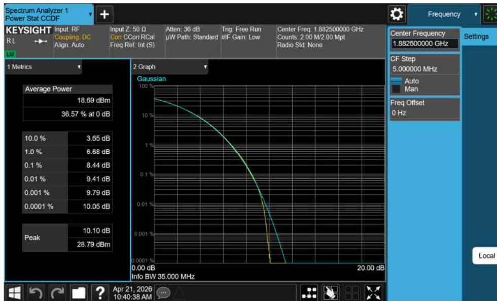
Plot 7-144. PAR Plot (NR Band n25/2 - 35.0MHz CP-OFDM 256-QAM - Full RB - ANT1)
