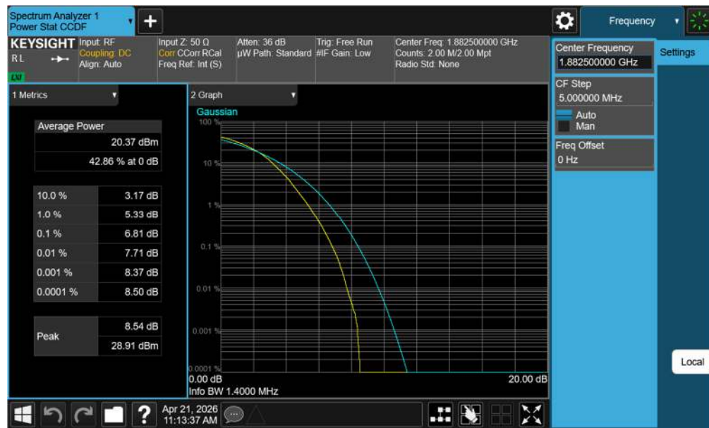
Plot 7-138. PAR Plot (LTE Band 25/2 - 1.4MHz 256-QAM - Full RB - Ant1)
