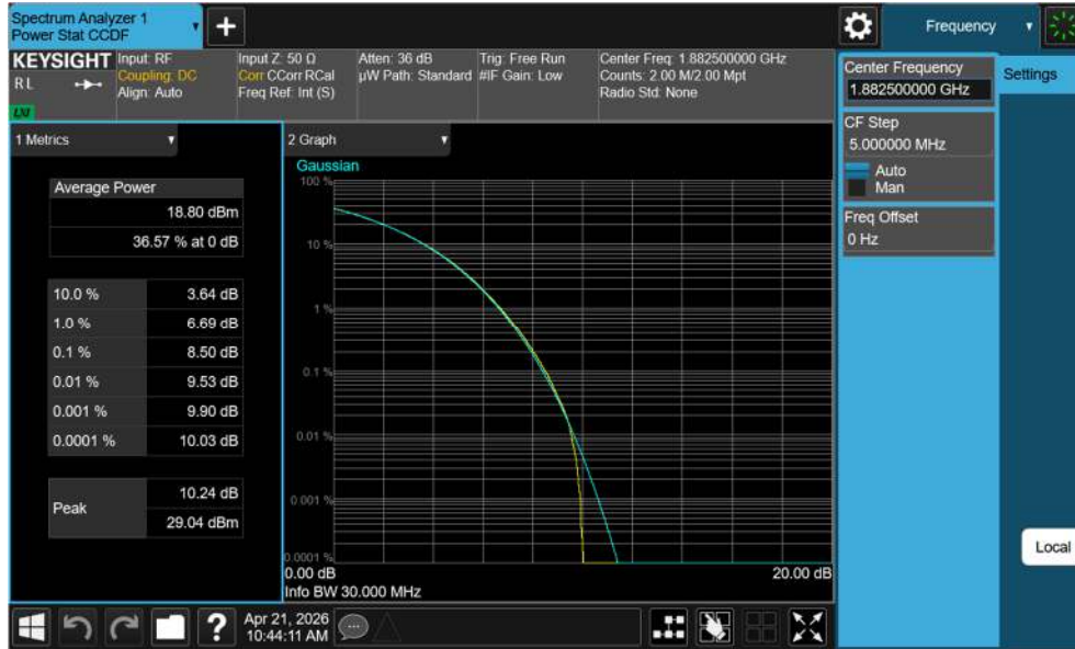
Plot 7-147. PAR Plot (NR Band n25/2 - 30.0MHz CP-OFDM 256-QAM - Full RB - ANT1)
