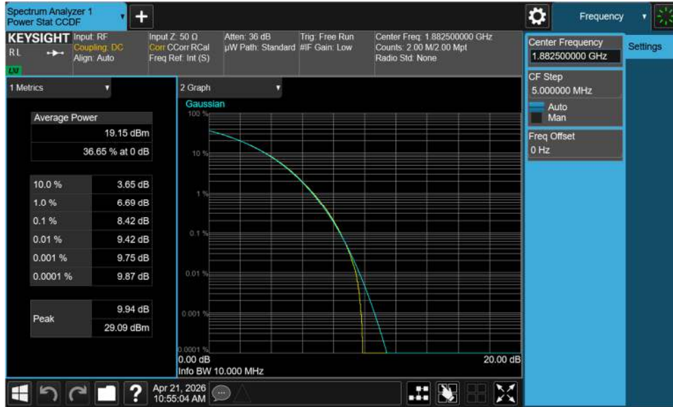
Plot 7-159. PAR Plot (NR Band n25/2 - 10.0MHz CP-OFDM 256-QAM - Full RB - ANT1)
