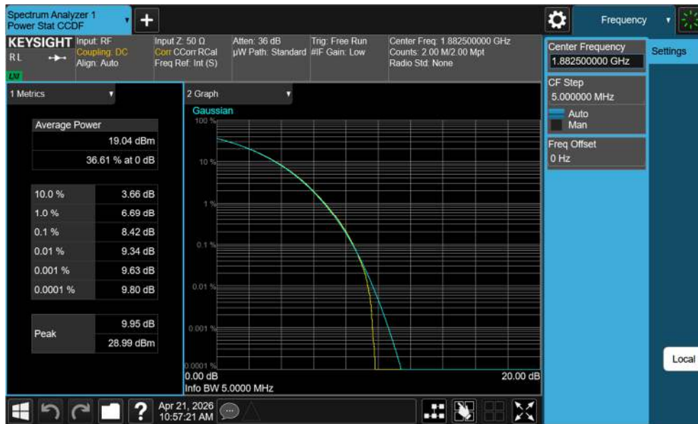
Plot 7-162. PAR Plot (NR Band n25/2 - 5.0MHz CP-OFDM 256-QAM - Full RB - ANT1)
