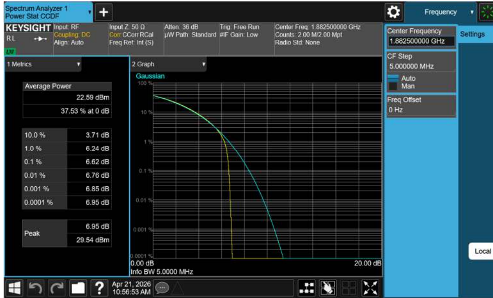
Plot 7-161. PAR Plot (NR Band n25/2 - 5.0MHz CP-OFDM QPSK - Full RB - ANT1)
