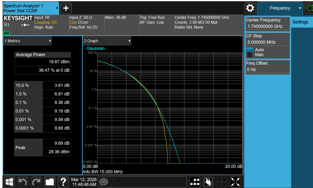
Plot 7-339. PAR Plot (NR Band n66 - 15.0MHz CP-OFDM 256-QAM - Full RB - ANT2)
