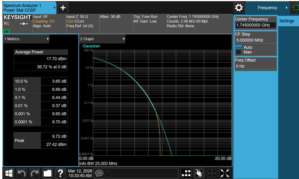
Plot 7-319. PAR Plot (NR Band n66 - 25.0MHz CP-OFDM 256-QAM - Full RB - ANT1)
