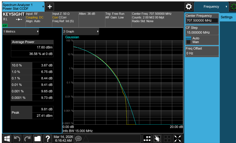
Plot 7-356. PAR Plot (NR Band n12 - 15.0MHz CP-OFDM 256-QAM - Full RB - ANT1)
