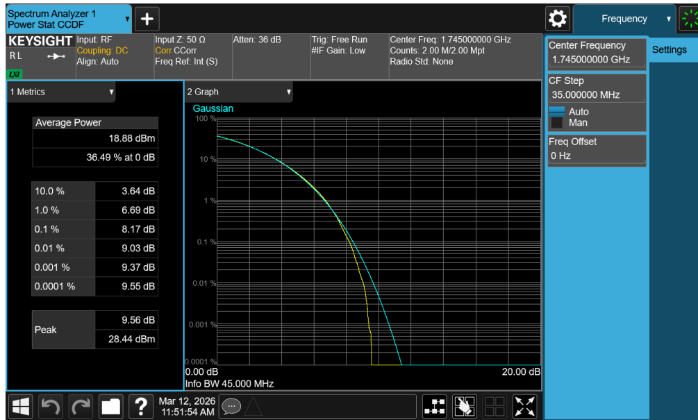
Plot 7-333. PAR Plot (NR Band n66 - 45.0MHz CP-OFDM 256-QAM - Full RB - ANT2)
