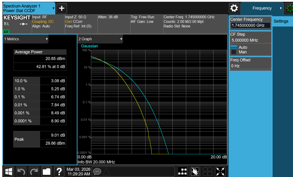
Plot 7-324. PAR Plot (LTE Band 66/4 - 20MHz 256-QAM - Full RB - ANT2)
