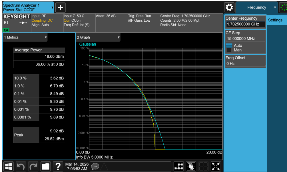
Plot 7-332. PAR Plot (NR Band n70 - 5.0MHz CP-OFDM 256-QAM - Full RB - ANT2)
