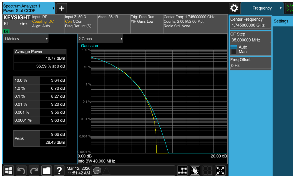
Plot 7-334. PAR Plot (NR Band n66 - 40.0MHz CP-OFDM 256-QAM - Full RB - ANT2)
