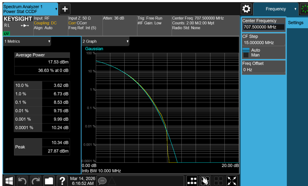
Plot 7-357. PAR Plot (NR Band n12 - 10.0MHz CP-OFDM 256-QAM - Full RB - ANT1)
