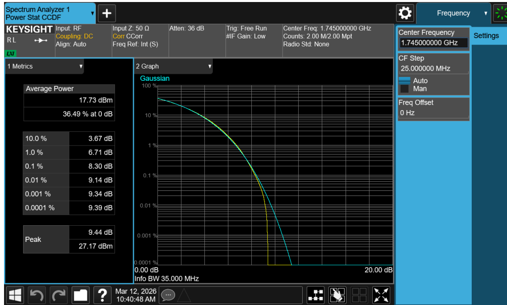
Plot 7-317. PAR Plot (NR Band n66 - 35.0MHz CP-OFDM 256-QAM - Full RB - ANT1)
