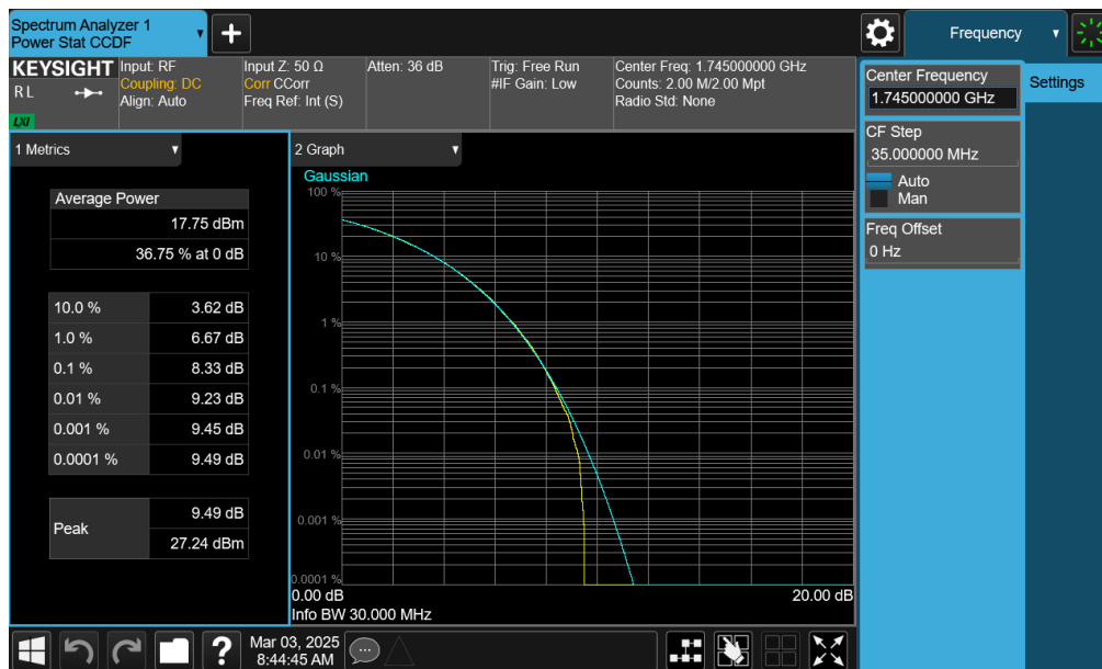
Plot 7-229. PAR Plot (NR Band n66 - 30.0MHz CP-OFDM 256-QAM - Full RB - ANT1)
