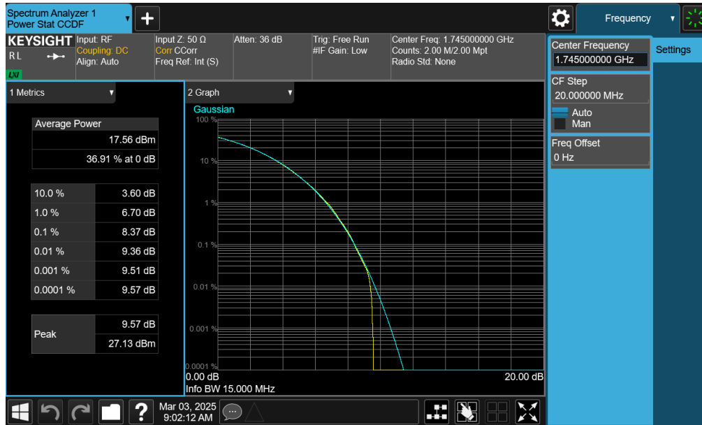
Plot 7-232. PAR Plot (NR Band n66 - 15.0MHz CP-OFDM 256-QAM - Full RB - ANT1)
