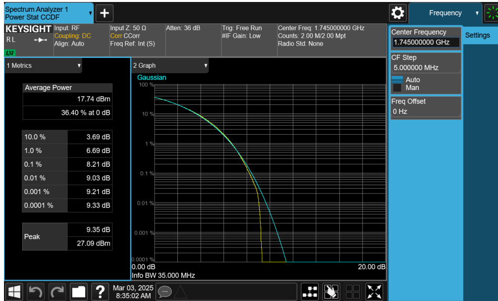
Plot 7-228. PAR Plot (NR Band n66 - 35.0MHz CP-OFDM 256-QAM - Full RB - ANT1)
