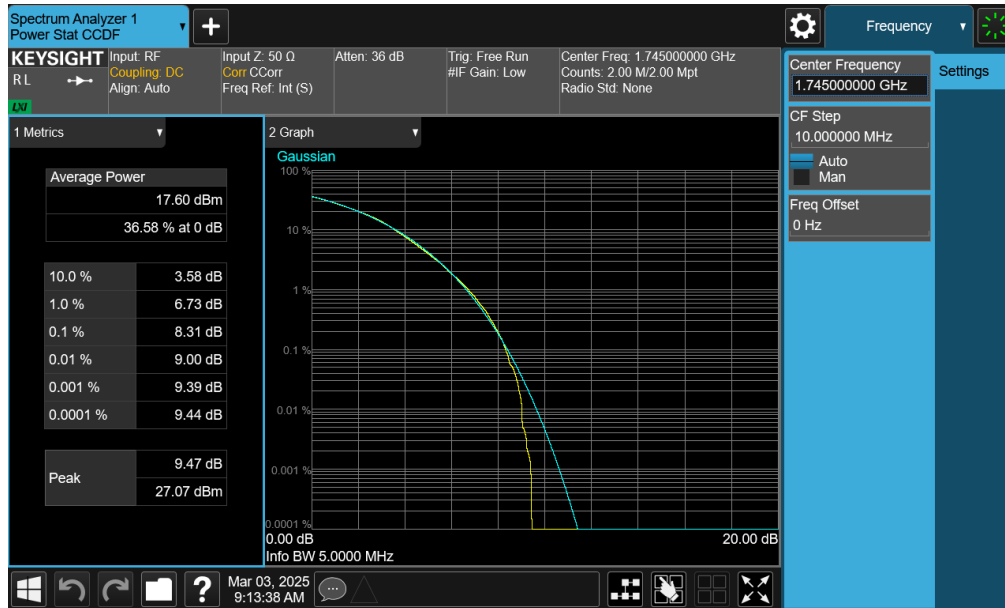
Plot 7-234. PAR Plot (NR Band n66 - 5.0MHz CP-OFDM 256-QAM - Full RB - ANT1)
