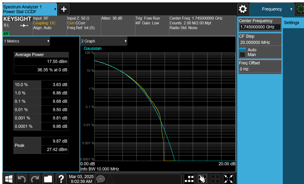
Plot 7-233. PAR Plot (NR Band n66 - 10.0MHz CP-OFDM 256-QAM - Full RB - ANT1)
