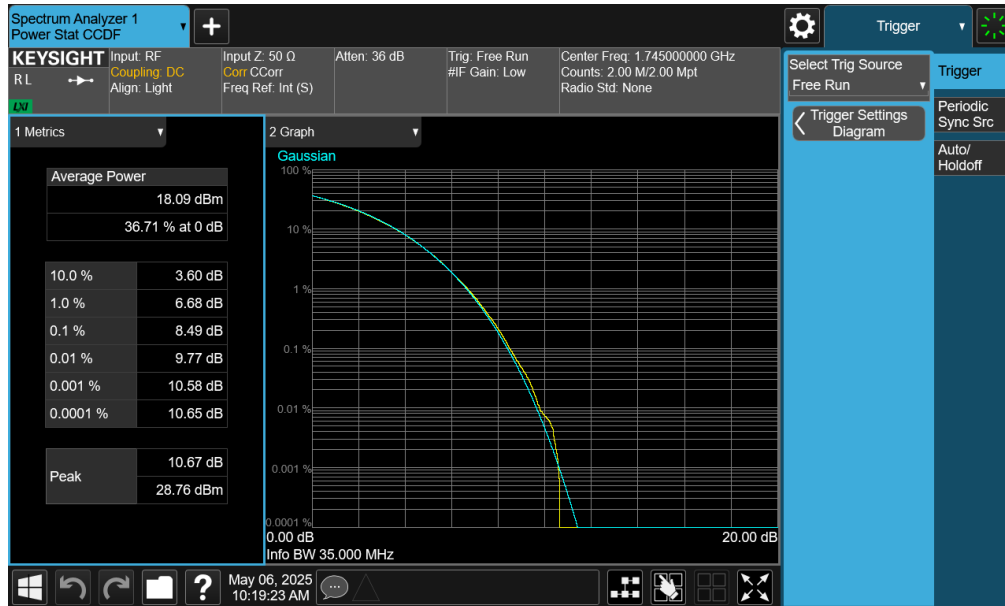
Plot 7-241. PAR Plot (NR Band n66 - 35.0MHz CP-OFDM 256-QAM - Full RB - ANT2)
