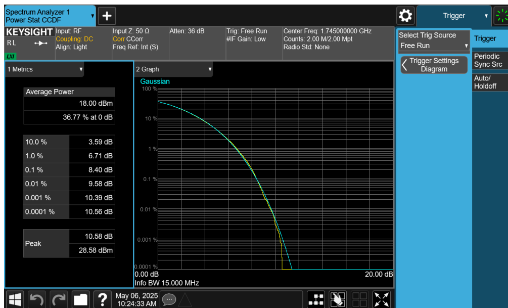
Plot 7-245. PAR Plot (NR Band n66 - 15.0MHz CP-OFDM 256-QAM - Full RB - ANT2)
