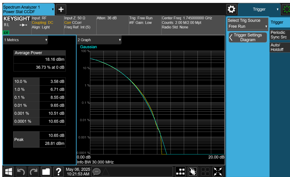
Plot 7-242. PAR Plot (NR Band n66 - 30.0MHz CP-OFDM 256-QAM - Full RB - ANT2)
