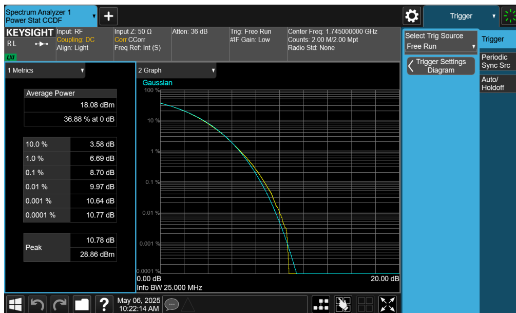
Plot 7-243. PAR Plot (NR Band n66 - 25.0MHz CP-OFDM 256-QAM - Full RB - ANT2)
