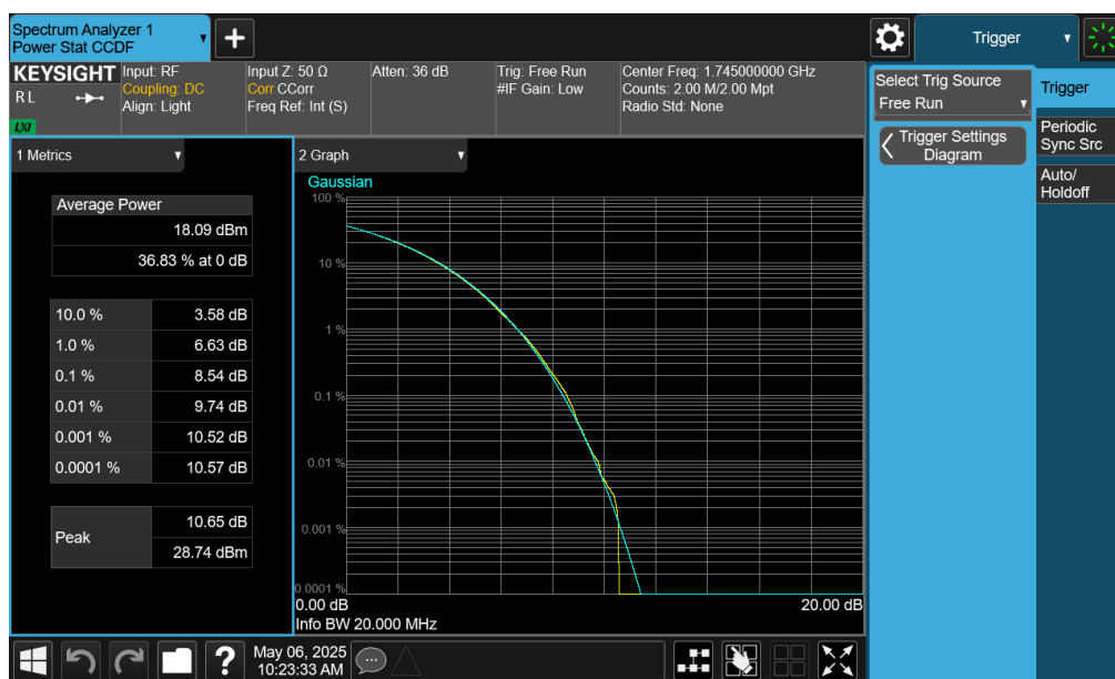
Plot 7-244. PAR Plot (NR Band n66 - 20.0MHz CP-OFDM 256-QAM - Full RB - ANT2)
