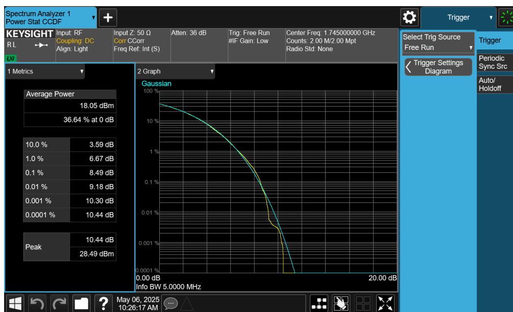
Plot 7-246. PAR Plot (NR Band n66 - 5.0MHz CP-OFDM 256-QAM - Full RB - ANT2)
