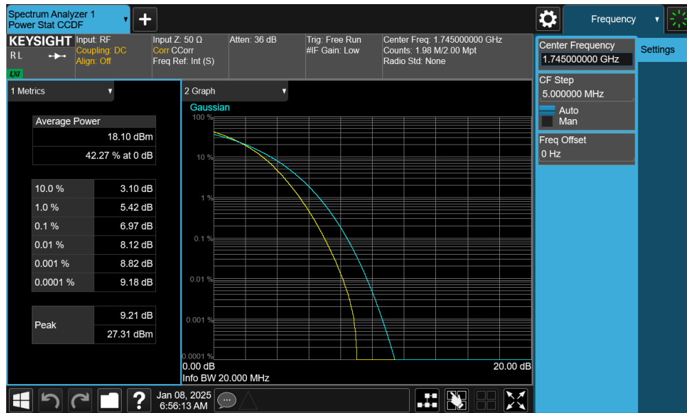
Plot 7-201. PAR Plot (LTE Band 66/4 - 20MHz 256-QAM - Full RB - Ant2)
