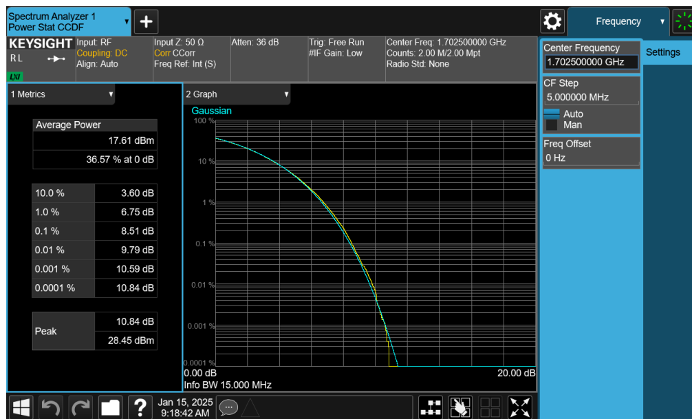
Plot 7-204. PAR Plot (NR Band n70 - 15.0MHz CP-OFDM 256-QAM - Full RB - Ant2)
