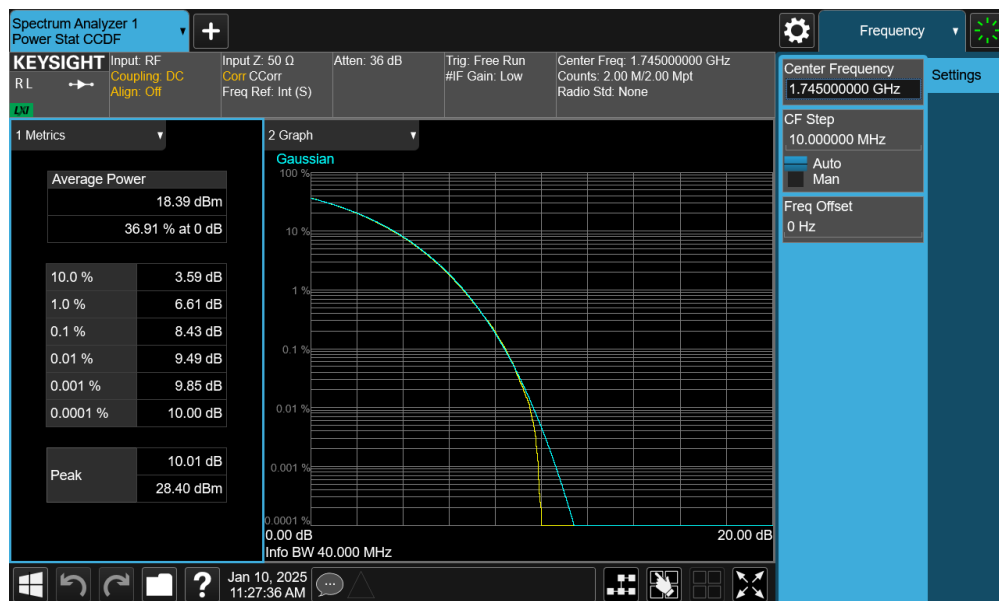
Plot 7-207. PAR Plot (NR Band n66 - 40.0MHz CP-OFDM 256-QAM - Full RB - Ant2)
