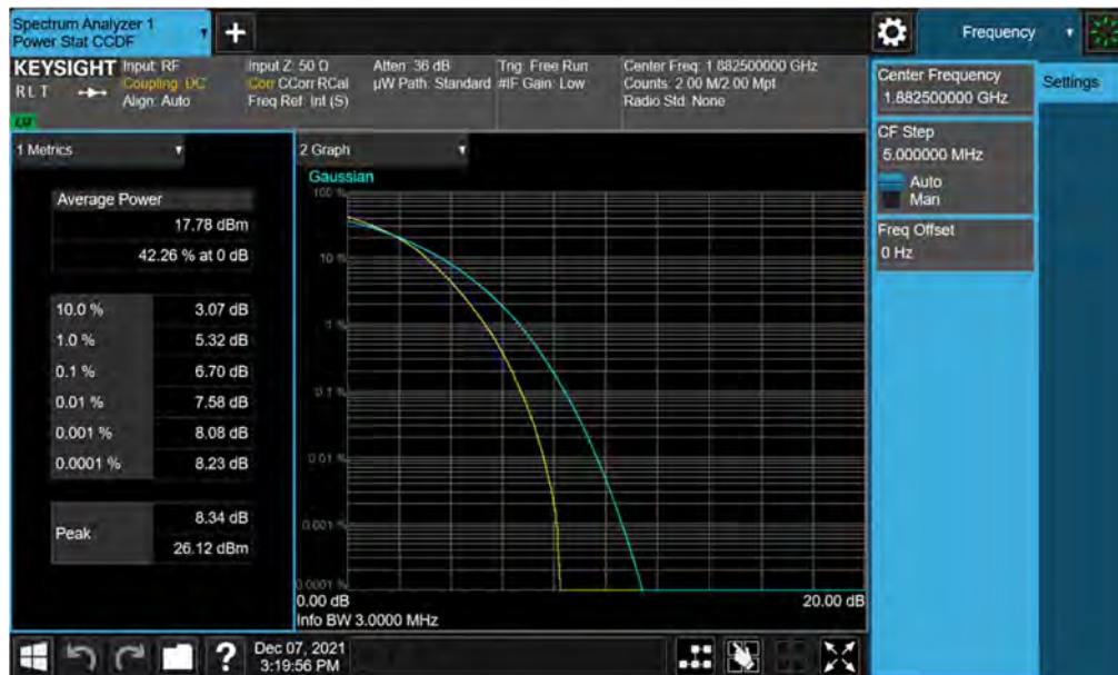
Plot 7-94. PAR Plot (LTE Band 25/2 - 3MHz 256-QAM - Full RB)
