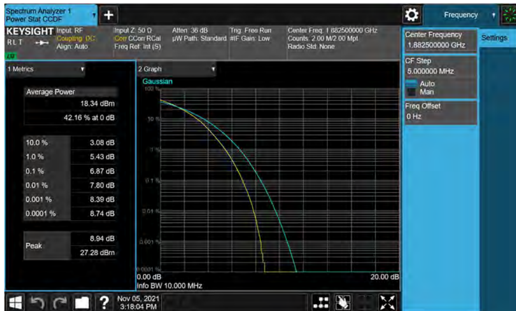
Plot 7-90. PAR Plot (LTE Band 25/2 - 10MHz 256-QAM - Full RB)
