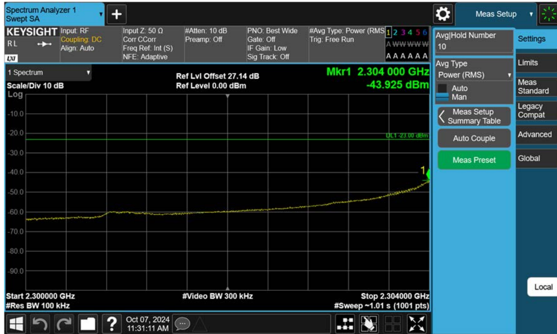
NR30_5 M_Band Edge(2300MHz-2304MHz)_Low_BPSK_1RB
