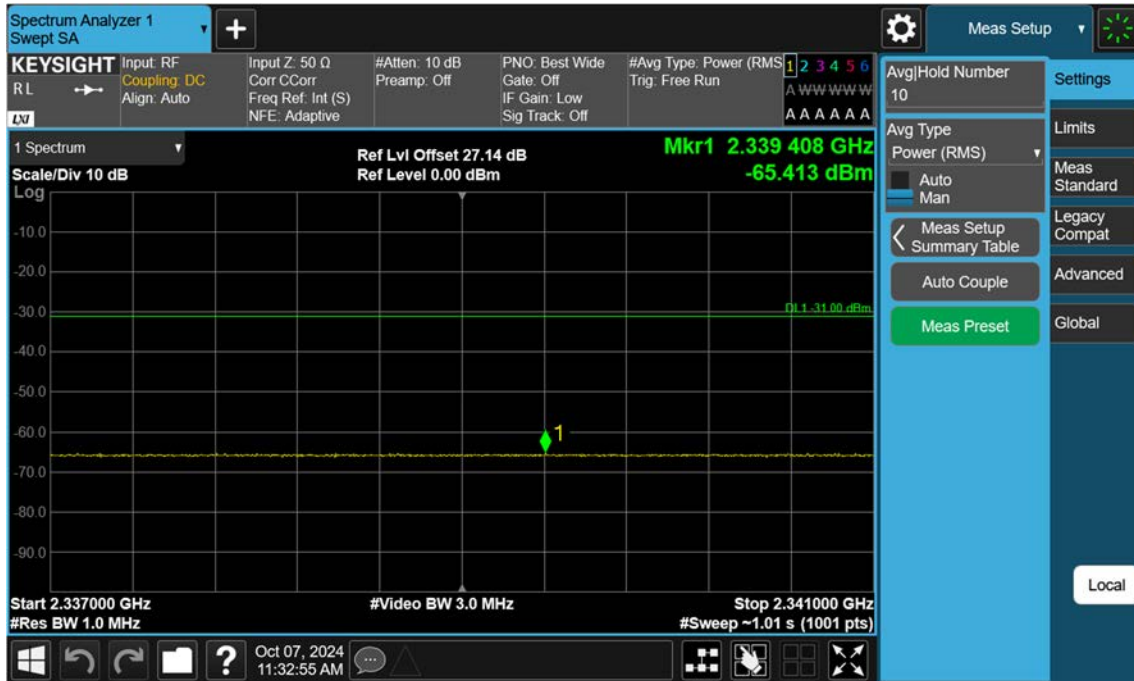
NR30_5 M_Band Edge(2337MHz-2341MHz)_Low_BPSK_1RB
