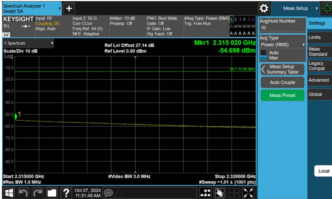
NR30_5 M_Band Edge(2315MHz-2320MHz)_Low_BPSK_1RB
