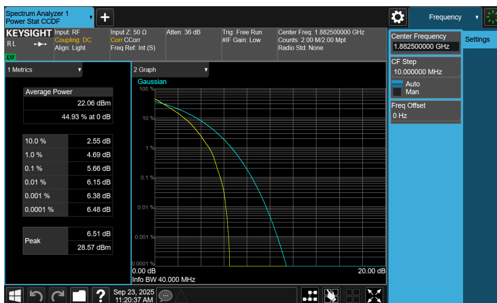
Plot 7-335. PAR Plot (NR Band n25/2 - 40.0MHz CP-OFDM QPSK - Full RB - ANT2)
