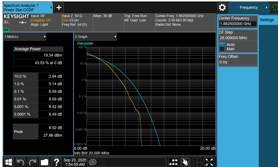
Plot 7-309. PAR Plot (NR Band n25/2 - 20.0MHz CP-OFDM 256-QAM - Full RB - ANT1)
